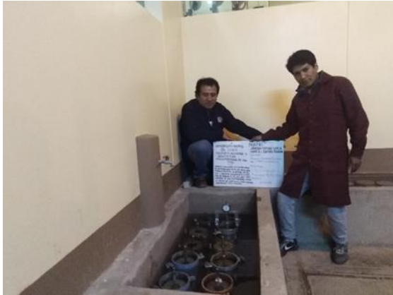
Figura Nro. 34 Medición de la deformación del suelo durante el sumergido por 96 horas.
