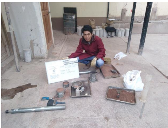
Figura Nro. 26 Ensayo de Proctor Modificado, materiales y preparado del suelo para el compactado en los moldes de 4".
