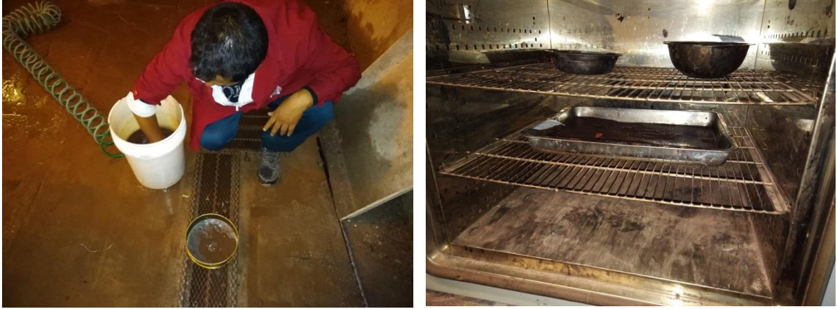
Figura Nro. 20 Lavado del suelo arcilloso y secado en horno por 24 horas para el análisis granulométrico.
