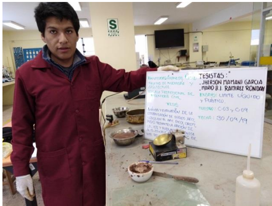
Figura Nro. 24 Ensayo de límite líquido del suelo con combinaciones de cal 10 % y puzolana 15, 25 y 30%.
