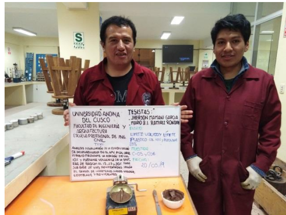
Figura Nro. 24 Ensayo de límite líquido del suelo con combinaciones de cal 10 % y puzolana 15, 25 y 30%.
