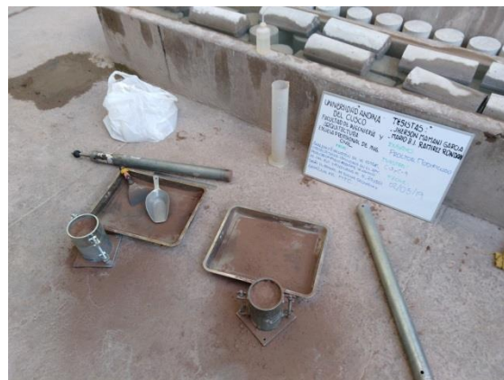
Figura Nro. 26 Ensayo de Proctor Modificado, materiales y preparado del suelo para el compactado en los moldes de 4".
