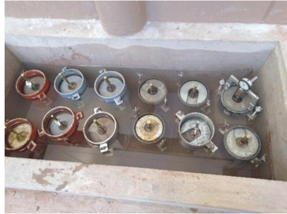
Figura Nro. 34 Medición de la deformación del suelo durante el sumergido por 96 horas.
