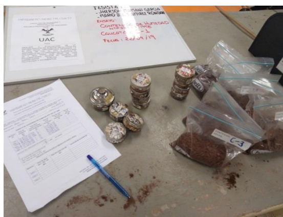
Figura Nro. 18 Muestras y equipos que se utilizó para determinar el contenido de humedad
