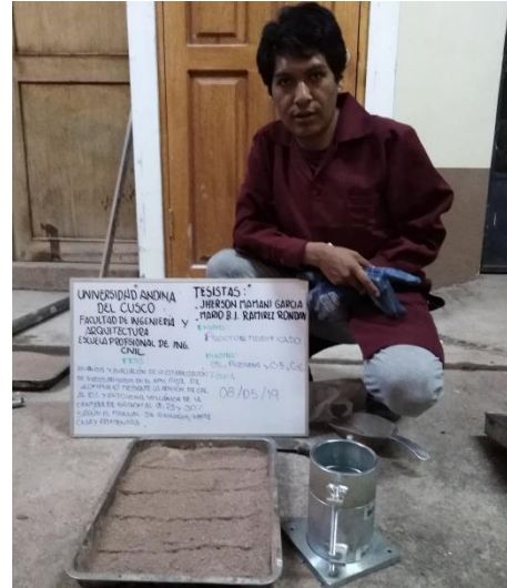
Figura Nro. 27 Combinación del suelo y saturado con agua, mezclas de suelo más cal 10% y arcilla 15, 25 y 30%
