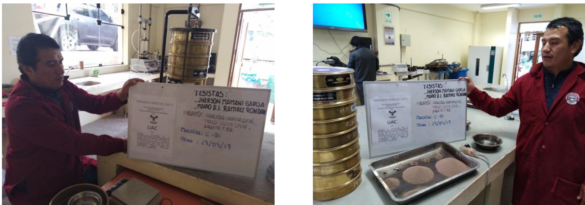
Figura Nro. 21 Ensayo de análisis granulométrico de las calicatas C-01 y C-02
