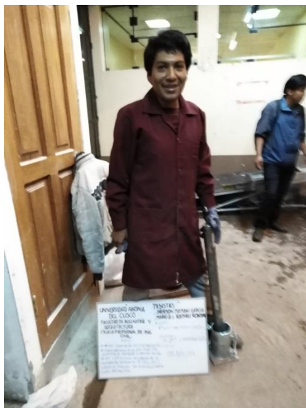
Figura Nro. 28 Compactado y pesado de los moldes de 4''
