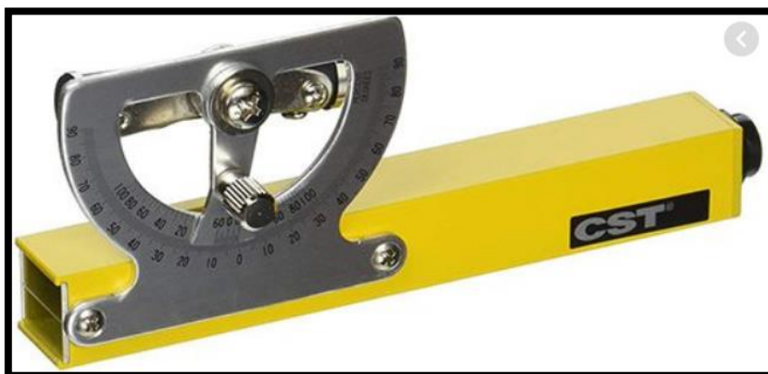
Figura 22: Instrumento de Recolección de Datos: Eclímetro
