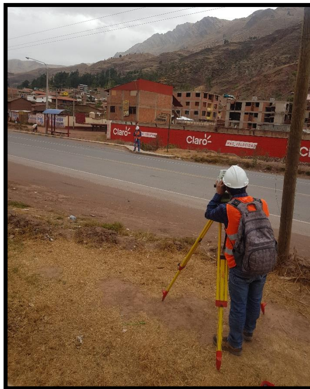
Figura 20: Estación total e instrumentos complementarios
