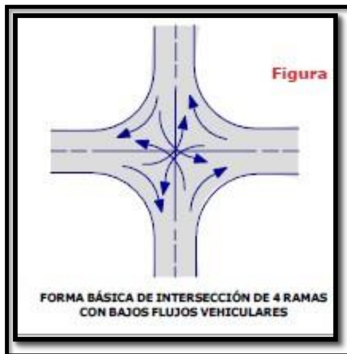
Figura 10: Intersección de 4 ramales con bajos flujos vehiculare
