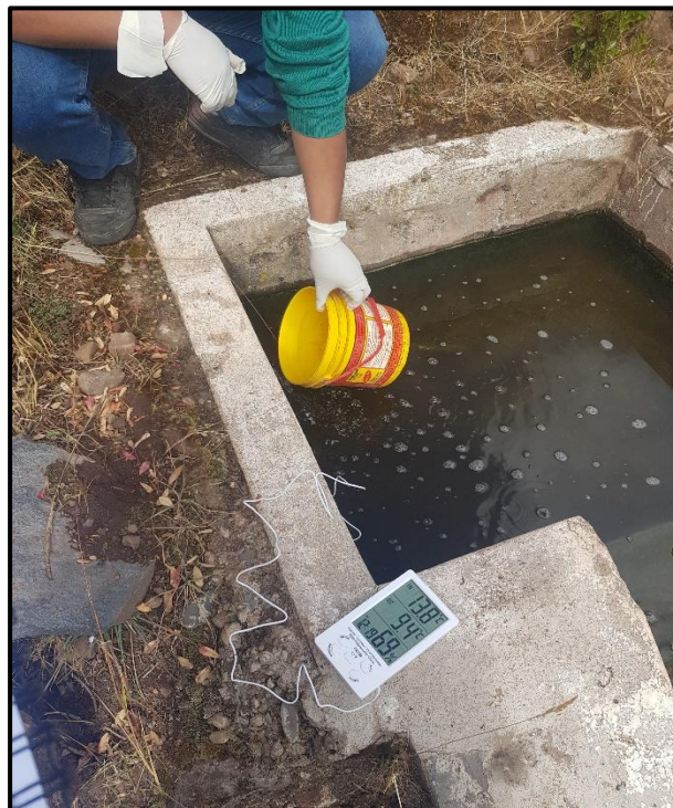
Figura 28: Medición del caudal en la planta de tratamiento de Huacoto
