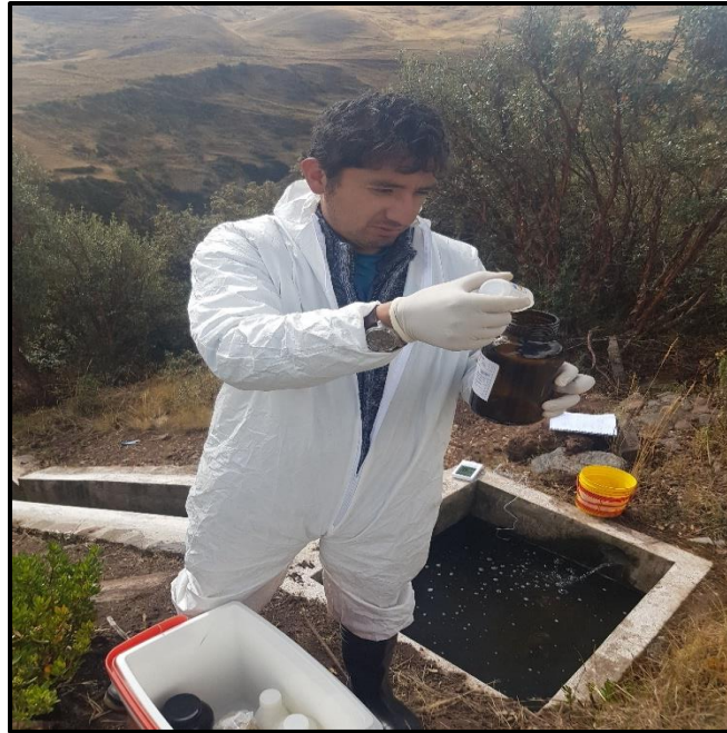
Figura 25: Colocado de conservante en muestras en planta de tratamiento de Huacoto
