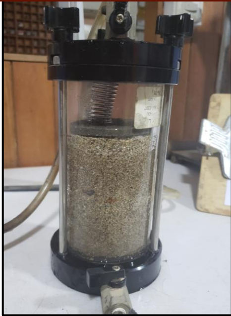
Figura N° 18. Ensayo de permeabilidad Fuente: propia
