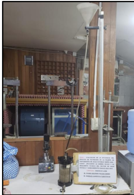
Figura N° 16. Ensayo de Permeabilidad
