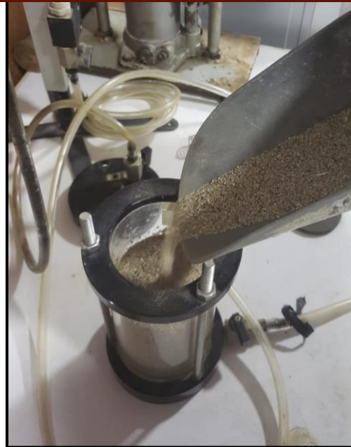
Figura N° 17. Ensayo de permeabilidad Fuente: propia
