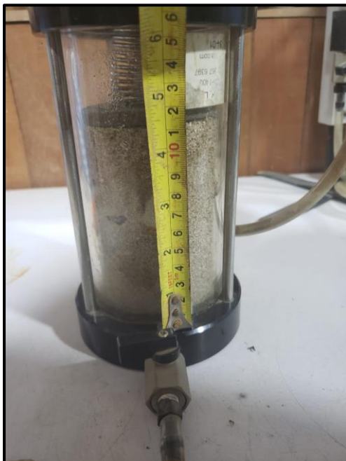
Figura N° 20. Ensayo de Permeabilidad Fuente: propia
