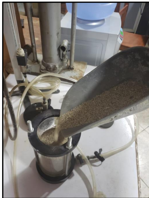
Figura N° 19. Ensayo de Permeabilidad Fuente: propia
