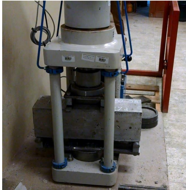
FIGURA N° 96: COLOCADO DE VIGUETA DE CONCRETO VP-07 EN LA MÁQUINA DE COMPRESIÓN.
