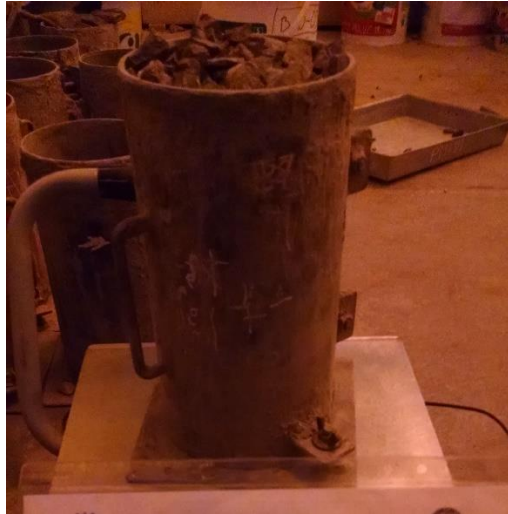
FIGURA N° 16: PESO DEL MOLDE MÁS AGREGADO GRUESO
