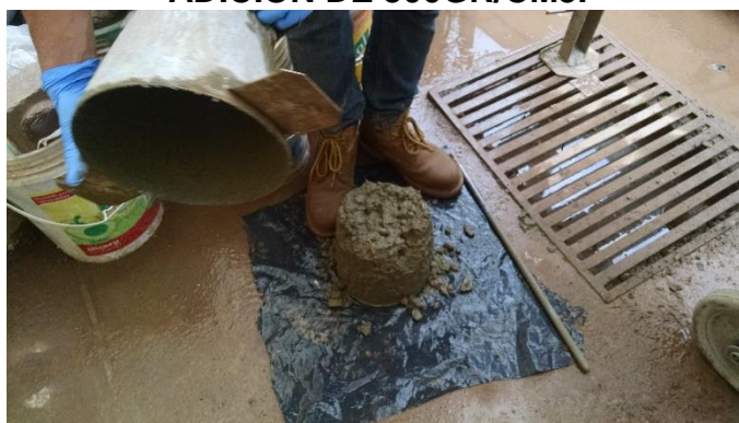
FIGURA N° 85: ENSAYO DE REVENIMIENTO DEL CONCRETO CON ADICIÓN DE 300GR/CM3.
