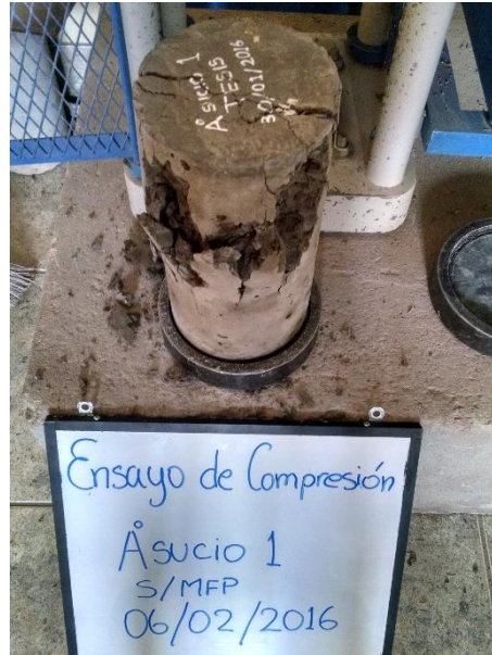
FIGURA N° 102: ROTURA DE BRIQUETA DE CONCRETO ELABORADO CON AGREGADO SUCIO.
