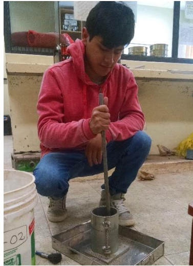
FIGURA N° 75: PESO UNITARIO COMPACTADO DEL AGREGADO FINO.
