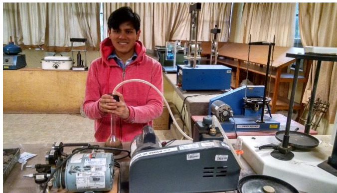
FIGURA N° 78: EXTRACCIÓN DE VACIOS DE LA FIOLA CON AGREGADO FINO Y AGUA DESTILADA.
