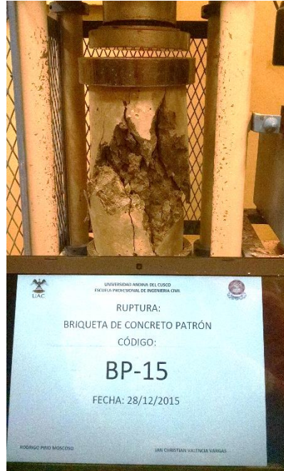
FIGURA N° 26: ROTURA DE BRIQUETA
