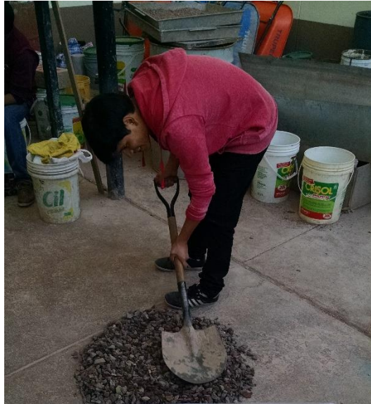
FIGURA N° 63: CUARTEO DEL AGREGADO GRUESO PROVENIENTE DE LA CANTERA DE VICHO PARA FUTURO TAMIZADO.
