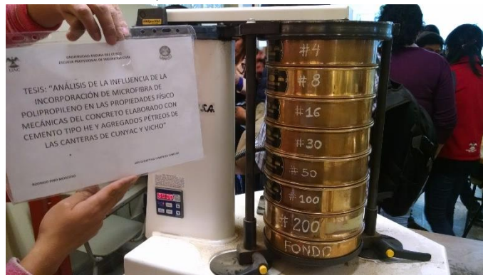
FIGURA N° 62: TAMIZADO DEL AGREGADO FINO POR LA MÁQUINA DE ZARANDEO
