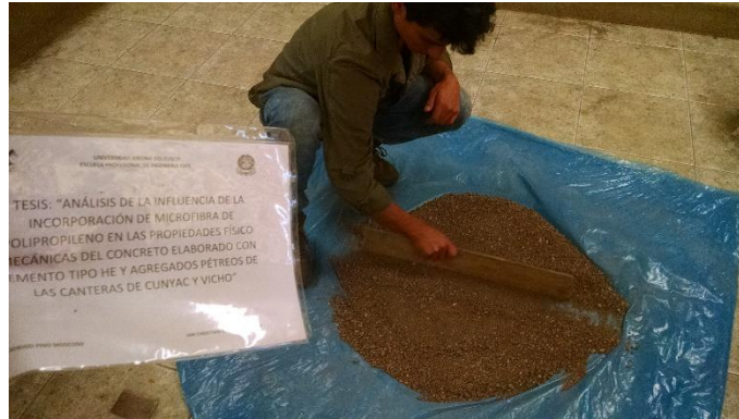
FIGURA N° 61: CUARTEO DE AGREGADO FINO MEZCLADO PROVENIENTES DE LAS CANTERAS DE CUNYAC Y VICHO PARA FUTURO TAMIZADO.
