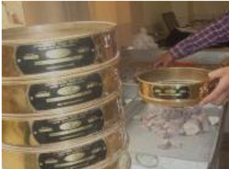
FIGURA N° 8: TAMIZADO DEL AGREGADO GRUESO
