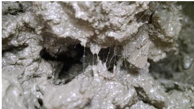
FIGURA N° 84: MICROFIBRA DE POLIPROPILENO PRESENTE EN LA MEZCLA DE CONCRETO ADICIONADO CON 300GR/CM3 DE MICROFIBRA DE POLIPROPILENO.
