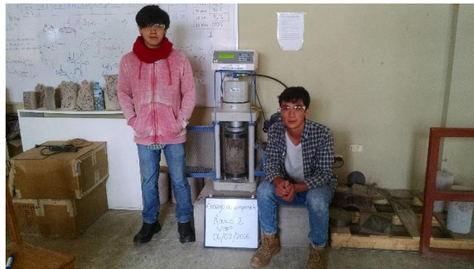
FIGURA N° 103: ROTURA DE BRIQUETA DE CONCRETO ELABORADO CON AGREGADO SUCIO EN MAQUINA DE COMPRESIÓN.
