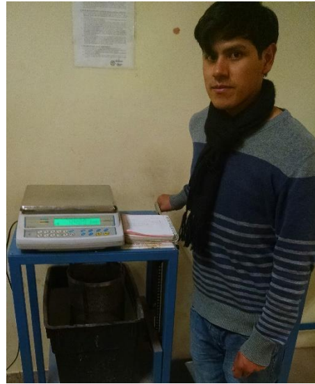
FIGURA N° 70: OBTENCIÓN DEL PESO SUMERGIDO DEL AGREGADO GRUESO PARA PESO ESPECÍFICO.
