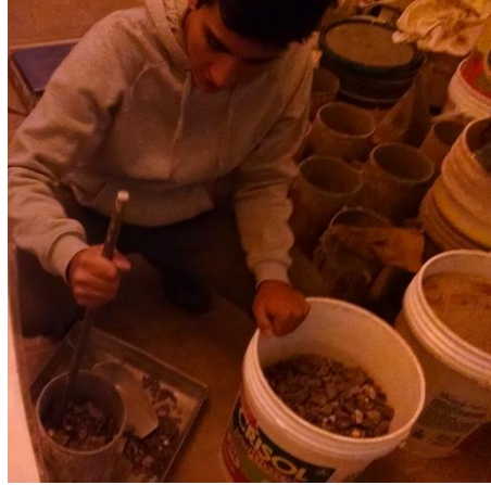
FIGURA N° 72: DETERMINACIÓN DEL PESO UNITARIO COMPACTADO DEL AGREGADO GRUESO.
