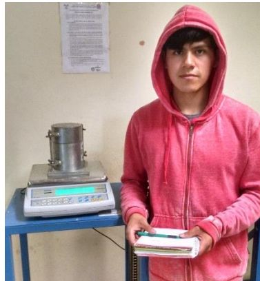
FIGURA N° 76: TOMA DE DATOS PARA PESO UNITARIO COMPACTADO DEL AGREGADO FINO.
