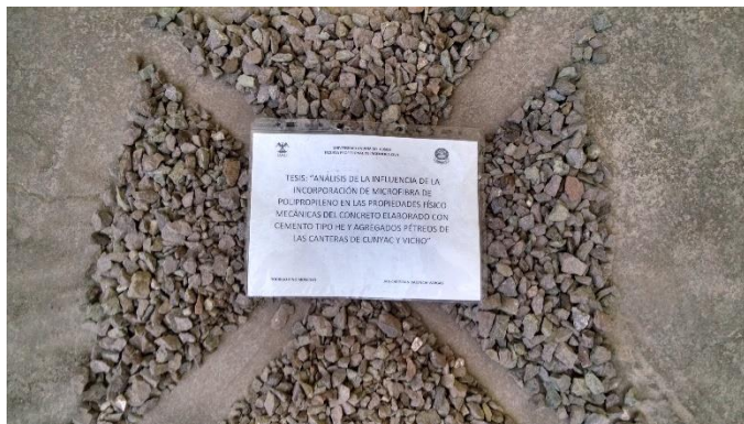
FIGURA N° 64: AGREGADO GRUESO CUARTEADO.
