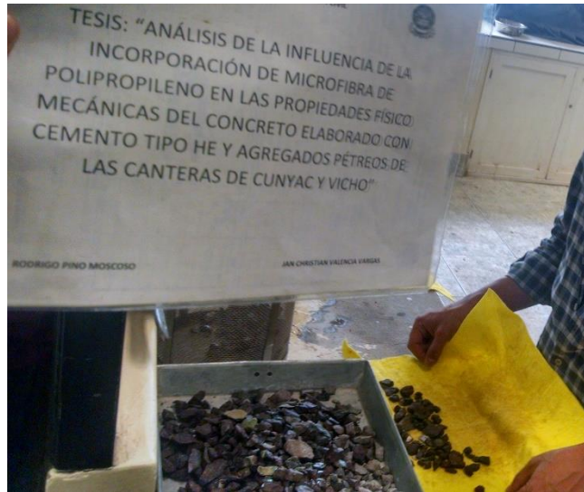
FIGURA N° 14: SECADO DE LA MUESTRA HASTA EL ESTADO SATURADO SUPERFICIALMENTE SECO
