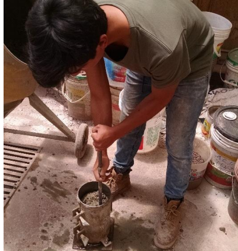
FIGURA N° 21: COMPACTADO DEL MATERIAL EN EL SEGUNDO TERCIO DEL VOLUMEN DEL RECIPIENTE
