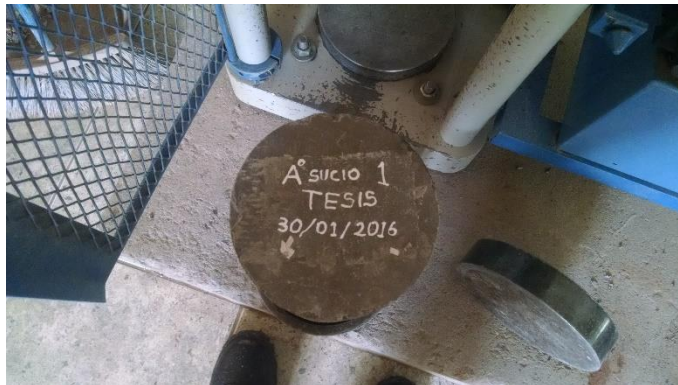
FIGURA N° 101: BRIQUETA DE CONCRETO ELABORADO CON AGREGADO SUCIO.
