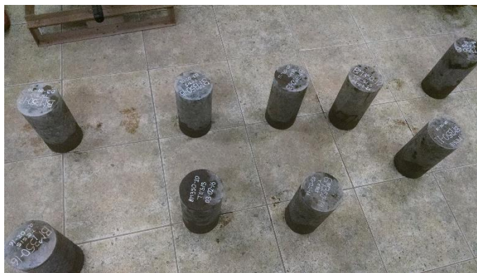
FIGURA N° 105: BRIQUETAS ELABORADAS CON 350GR/M3 DE CONCRETO SUEMERGIDAS POR 7 DÍAS.
