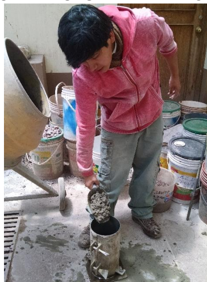
FIGURA N° 20: COLOCACIÓN DEL CONCRETO AL PRIMER TERCIO DEL VOLUMEN DEL RECIPIENTE
