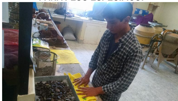
FIGURA N° 67: SECADO SUPERFICIAL DEL AGREGADO GRUESO PARA PESO ESPECÍFICO.
