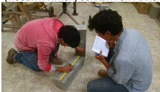
FIGURA N° 95: TOMA DE MEDIDAS DE LA VIGUETA VP-07 (VIGUETA PATRÓN) CURADA POR 7 DÍAS.
