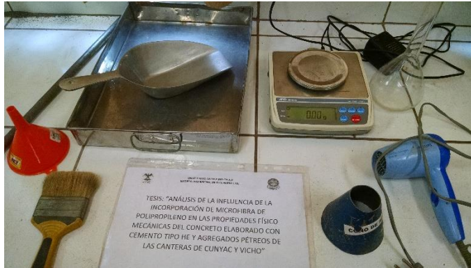
FIGURA N° 77: MATERIALES Y EQUIPOS PARA EL ENSAYO DE PESO ESPECÍFICO DEL AGREGADO FINO.
