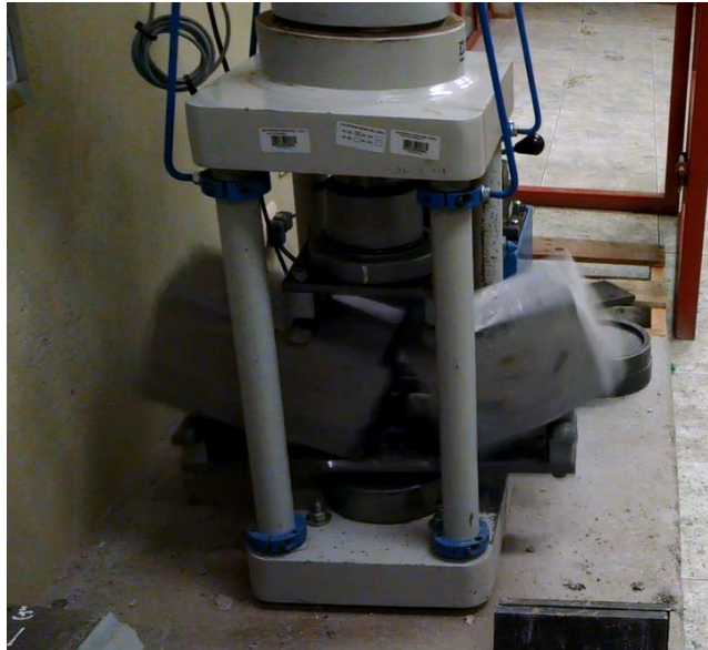
FIGURA N° 29: PROCEDIMIENTO DE ENSAYO DE LA RESISTENCIA A LA FLEXIÓN
