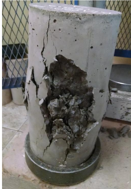
FIGURA N° 94: BRIQUETA BM250-14 (BRIQUETA DE CONCRETO CO ADICIÓN DE MICROFIBRA DE POLIPROPILENO DE 250GR/CM3) ENSAYADA A LOS 7 DÍAS.
