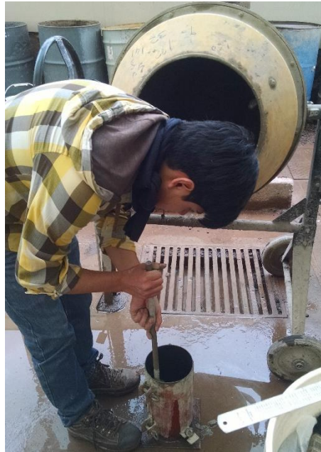
FIGURA N° 88: VARILLADO DEL PRIMER TERCIO DE CONCRETO PARA LA ELABORACIÓN DE BRIQUETAS.
