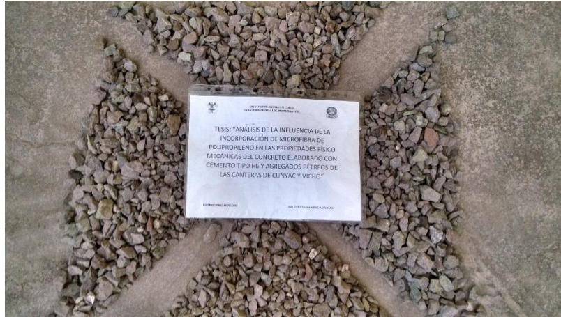
FIGURA N° 7: CUARTEO DEL AGREGADO
