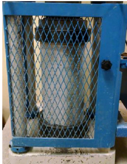
FIGURA N° 23: FORMA DE COLOCACIÓN DE BRIQUETA CIRCULAR PARA ENSAYO A COMPRESIÓN
