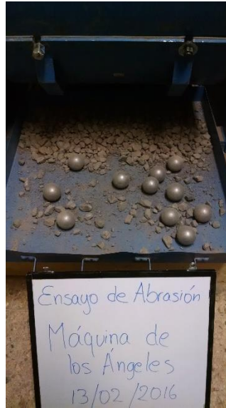
FIGURA N° 18: MATERIAL RETIRADO DESPUES DE 500 VUELTAS EN LA MÁQUINA DE LOS ÁNGELES
