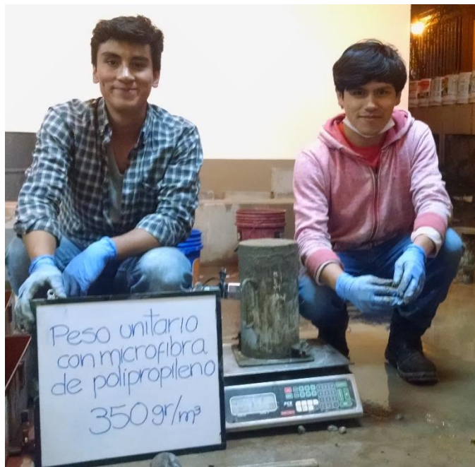
FIGURA N° 22: OBTENCION DEL PESO DE RECIPIENTE LLENO CONCRETO
