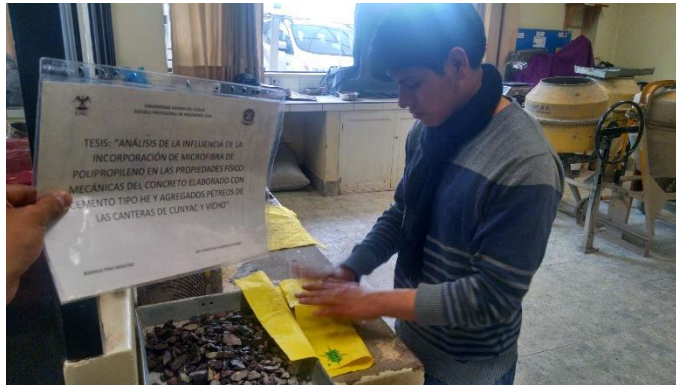
FIGURA N° 68: SECADO SUPERFICIAL DEL AGREGADO GRUESO PARA PESO ESPECÍFICO.
