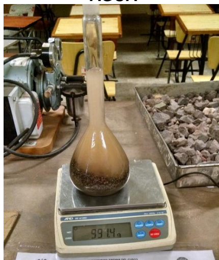
FIGURA N° 13: PESO DEL MATERIAL EN EL PICNÓMETRO CON AGUA
