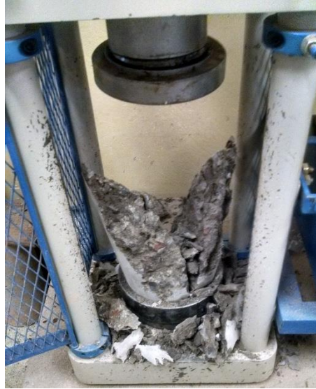
FIGURA N° 104: DESMORONAMIENTO DE BRIQUETA POR RESISTENCIA ELEVADA.
