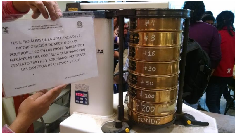
FIGURA N° 5: TAMIZADO DEL AGREGADO FINO
