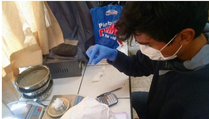
FIGURA N° 80: PESADO DE LA MICROFIBRA DE POLIPROPILENO PARA FUTURA UTILIZACIÓN EN LA MEZCLA DE CONCRETO.
