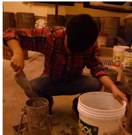
FIGURA N° 71: DETERMINACIÓN DEL PESO UNITARIO SUELTO DEL AGREGADO GRUESO.
