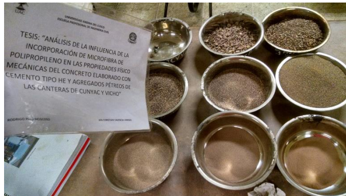
FIGURA N° 65: DISTRIBUCIÓN DEL AREGADO FINO MEZCLADO PROVENIENTES DE LAS CANTERAS DE CUNYAC Y VICHO DE ACUERDO AL TAMAÑO.
