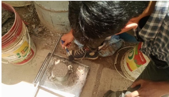
FIGURA N° 73: PESO UNITARIO SUELTO DEL AGREGADO FINO.
