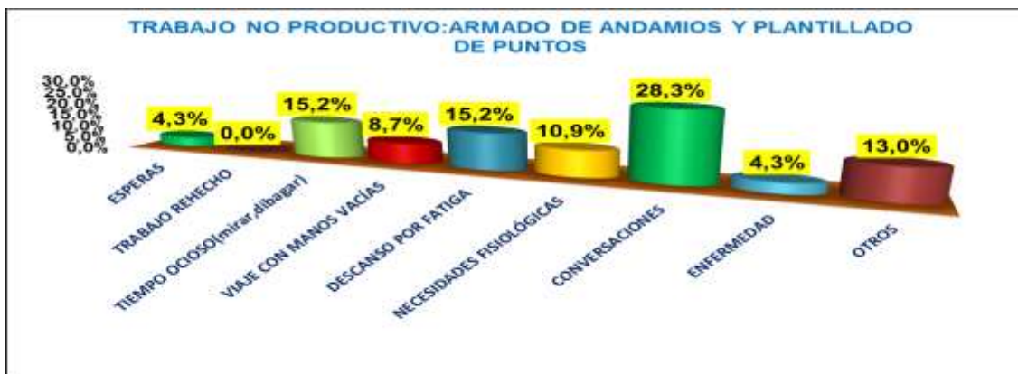
FIGURA N° 72: TRABAJO NO PRODUCTIVO DE ARMADO DE ANDAMIOS Y PLANTILLADO DE PUNTOS
