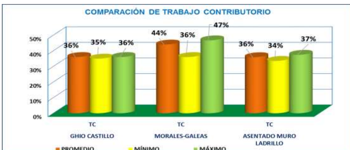
FIGURA N° 83: ANÁLISIS COMPARATIVO DEL TRABAJO CONTRIBUTORIO DE ASENTADO DEL MURO DE LADRILLO TIPO BLOQUER
