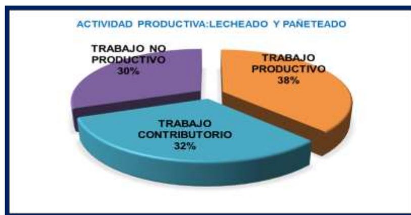
FIGURA N° 50: ACT.PROD.DE TARRAJEO DE MUROS INTERIORES (%)
