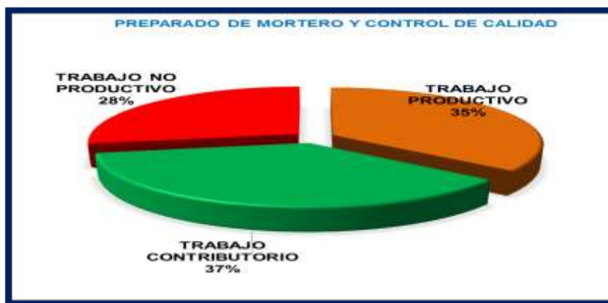
FIGURA N° 43: ACT.PROD.ASENTADO DE MURO LADRILLO TIPO BLOQUER
