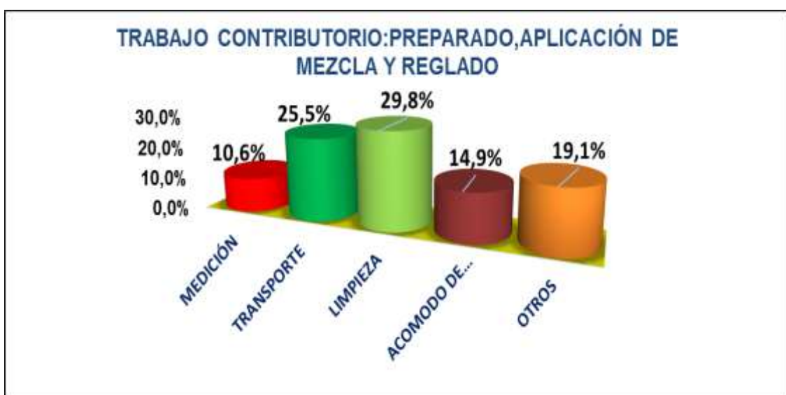
FIGURA N° 60: T.C.PREPARADO, APLICACIÓN Y REGLADO TARRAJEO
