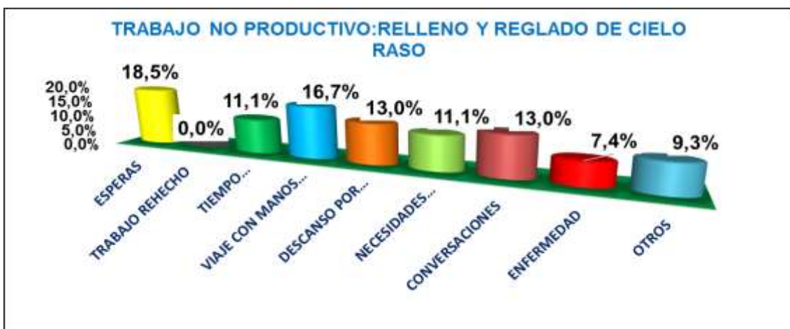
FIGURA N° 76: TRABAJO NO PRODUCTIVO DE RELLENO Y REGLADO
