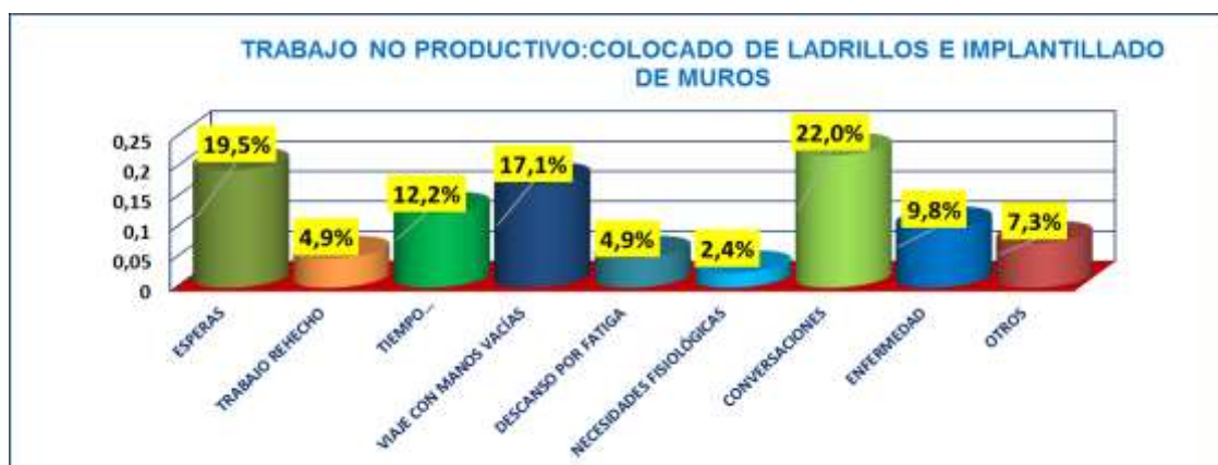
FIGURA N° 38: T.NO PRODUCTIVO COLOCADO Y EMPLANTILLADO DE MUROS
