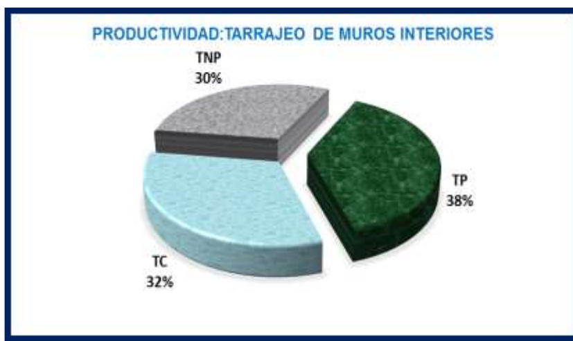
FIGURA N° 85: PRODUCTIVIDAD DE TARRAJEO DE MUROS INTERIORES
