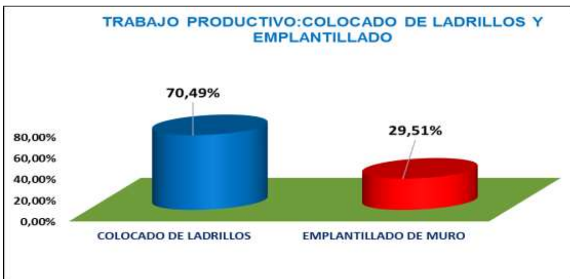
FIGURA N° 36: TRABAJO PRODUCTIVO DE COLOCADO Y EMPLANTILLADO DE MUROS
