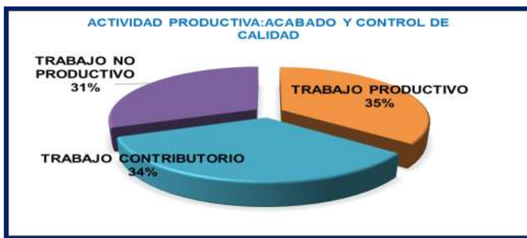
FIGURA N° 77: ACTIVIDAD PRODUCTIVA DE ACABADOS Y CONTROL CALIDAD DE ENLUCIDO CIELO RASO CON YESO
