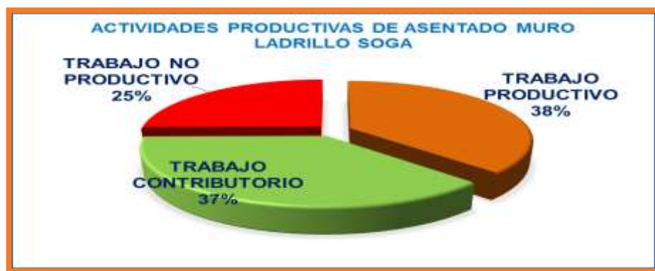
FIGURA N° 35: ACTIVIDAD PRODUCTIVA DE ASENTADO MURO LADRILLO TIPO BLOQUER O BLOQUETA DE ARCILLA
