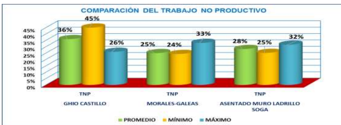
FIGURA N° 84: ANÁLISIS COMPARATIVO DEL TRABAJO NO PRODUCTIVO DE ASENTADO MURO LADRILLO TIPO BLOQUER
