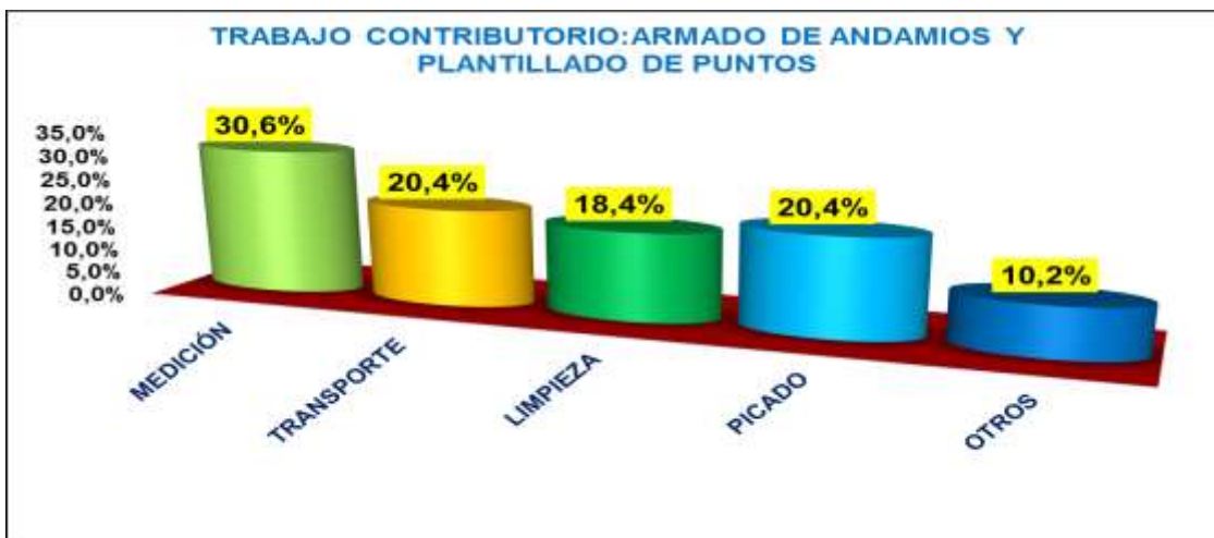
FIGURA N° 71: TRABAJO CONTRIBUTORIO DE ARMADO ANDAMIOS Y PLANTILLADO DE ENLUCIDO DE CIELO RASO CON YESO.
