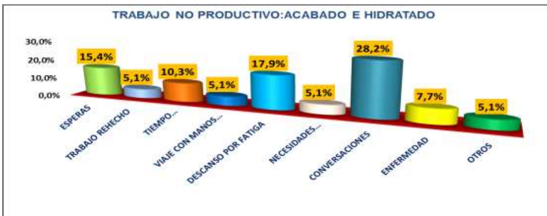
FIGURA N° 65: T.N.P. ACABADOS E HIDRATADO DE TARRAJEO
