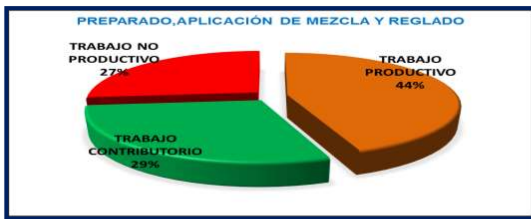
FIGURA N° 58: ACT.PROD.TARRAJEO MUROS DE PREPARADO Y REGLADO
