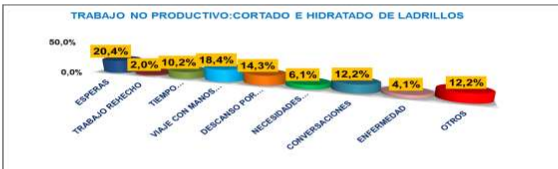
FIGURA N° 42: T.N.P.CORTADO E HIDRATDO LADRILLOS
