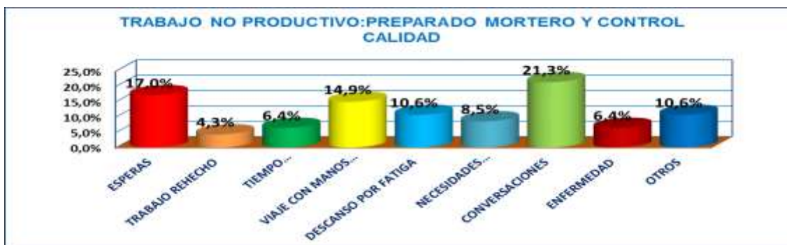
FIGURA N° 46: TRABAJO NO PRODUCTIVO DE ASENTADO DEL MURO DE LADRILLO TIPO BLOQUER
