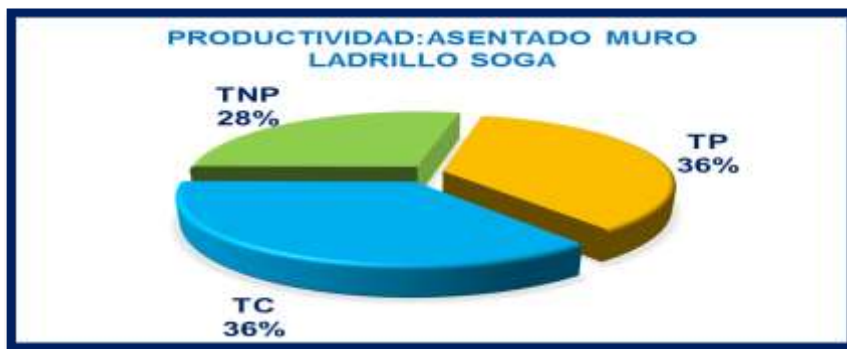
FIGURA N° 81: ACTIVIDAD PRODUCTIVA DE ASENTADO DEL MURO DE LADRILLO TIPO BLOQUER
