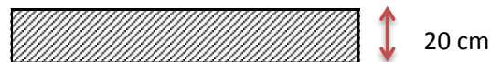
FIGURA III-16: SECCIÓN DE LOSA PREDIMENSIONADA – MUROS DE CORTE, LOSAS PLANAS FUENTE: Elaboración propia.
