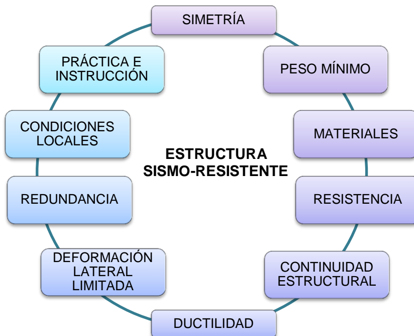
DIAGRAMA II-1: CONDICIONES PARA UNA ESTRUCTURA SISMORESISTENTE. FUENTE: Elaborada en base a la norma E.030, Diseño Sísmo-resistente.
