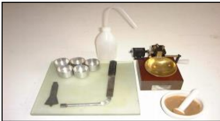
Figura 10 Materiales para realizar ensayos de LL y LP
