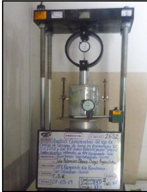
Figura 45 Ensayo CBR – Lectura de Precisión de Penetración SUELO 83%, CCA 12% y CAL 5%
