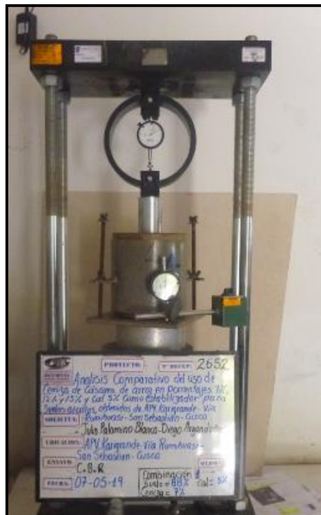
Figura 44 Ensayo CBR – Lectura de Precisión de Penetración SUELO 88%, CCA 7% y CAL 5%
