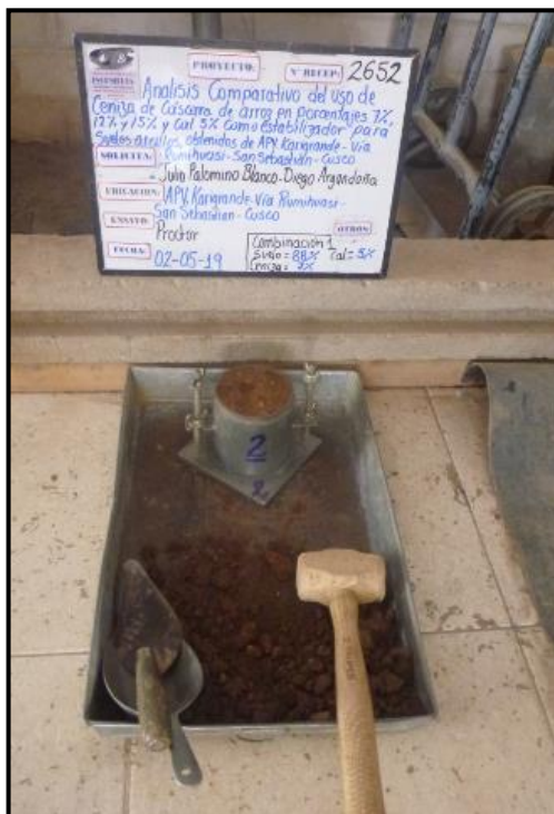
Figura 40 Ensayo de Proctor Modificado – SUELO 88%, CCA 7% y CAL 5% Fuente: Elaboración Propia
