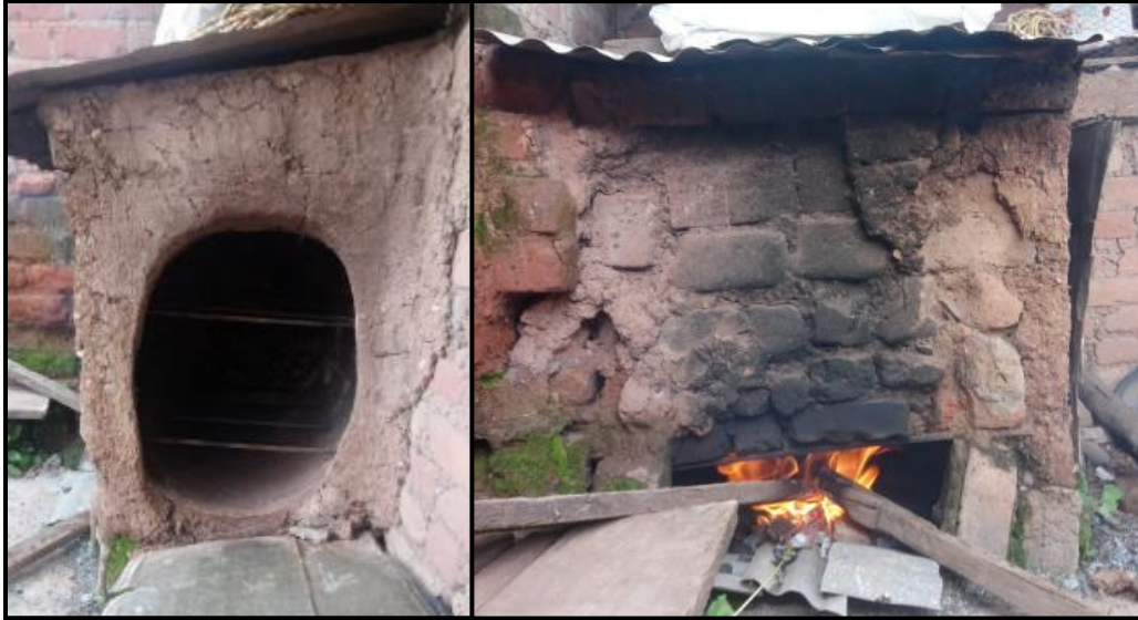
Figura 28 Horno Artesanal – Incineración de la cascarilla de arroz
