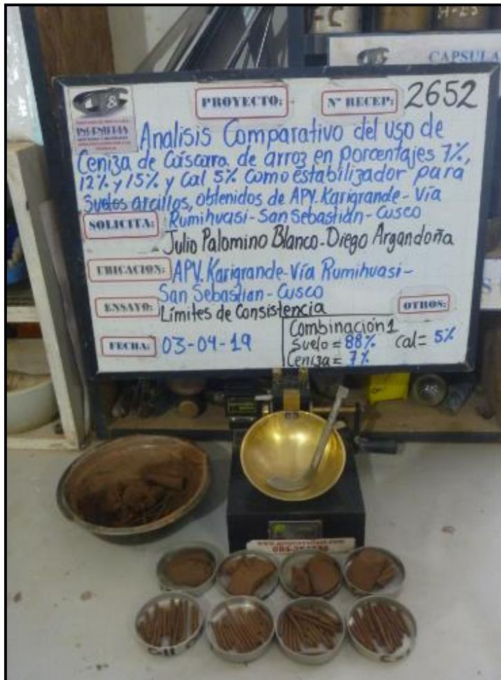
Figura 35 Límites de Consistencia - SUELO 88%, CCA 7% y CAL 5% Fuente: Elaboración Propia
