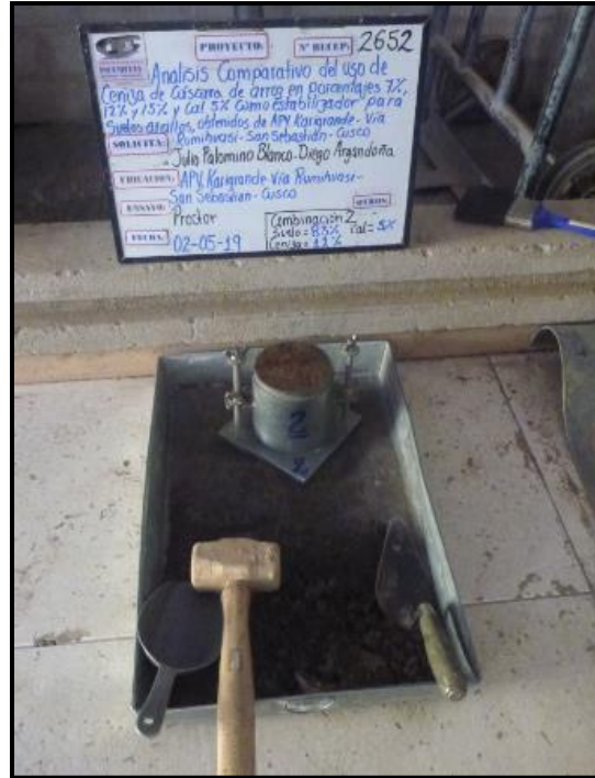
Figura 41 Ensayo de Proctor Modificado – SUELO 83%, CCA 12% y CAL 5% Fuente: Elaboración Propia
