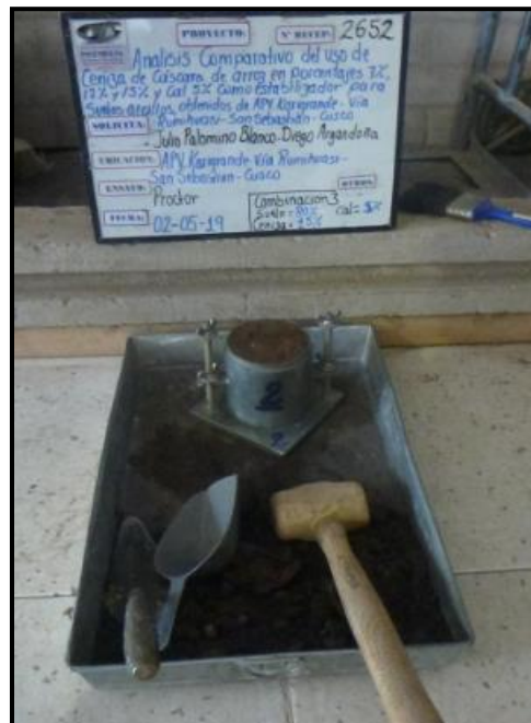
Figura 42 Ensayo de Proctor Modificado – SUELO 80%, CCA 15% y CAL 5% Fuente: Elaboración Propia
