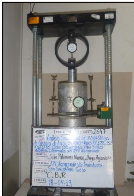
Figura 43 Ensayo CBR – Lectura de Precisión de Penetración Suelo
