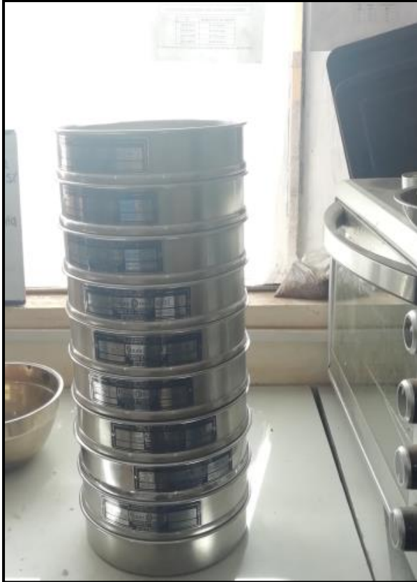
Figura 6: Análisis Granulométrico por Tamizado Fuente: Elaboración Propia
