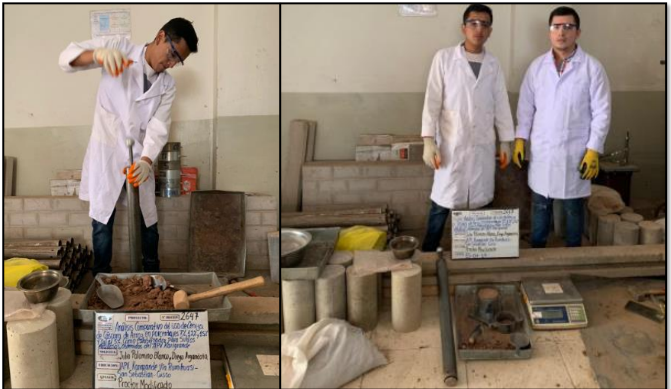
Figura 38 Ensayo de Proctor Modificado - Procedimiento
