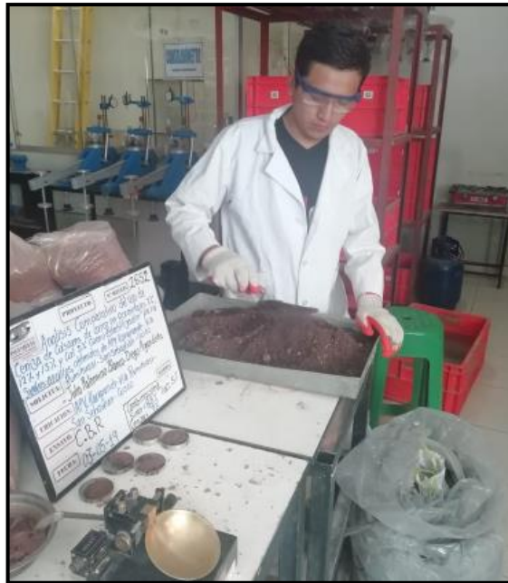
Figura 33 Límite líquido – colocación de muestras en taras Fuente: Elaboración Propia
