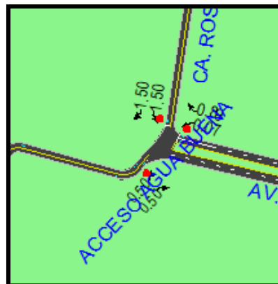
Figura 103: Relación de volumen/capacidad de la Intersección N° 5: Av Evitamiento- Urb. Agua Buena
