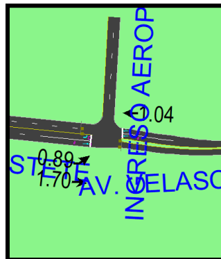
Figura 126: Relación de volumen/capacidad de la Intersección N° 2: Av. Velasco Astete- Ingreso del aeropuerto
