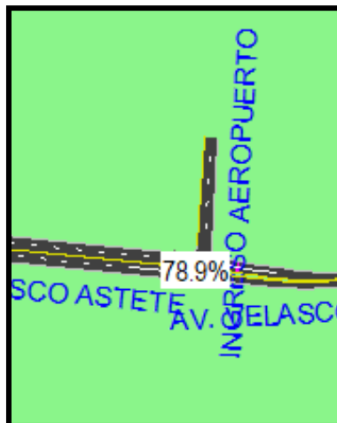
Figura 105: Índice de utilización de capacidad de la Intersección N° 2: Av Velasco Astete- Ingreso del aeropuerto
