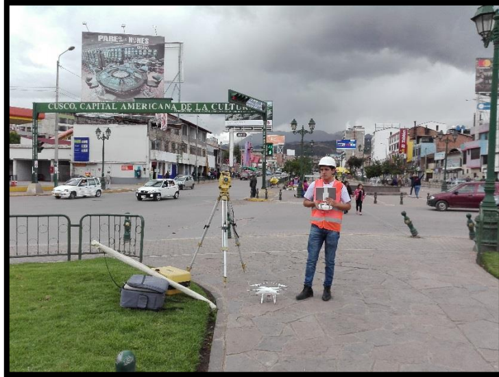
Figura 48: Ubicación de la estación total para proceder al levantamiento topográfico.
