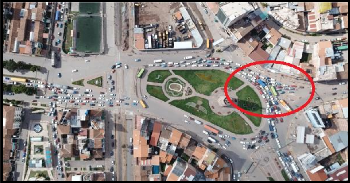
Figura 3: Conflicto entre el flujo entrante de la Av. Antonio de Sucre y los vehículos circulantes, hora: 8:07 am.
