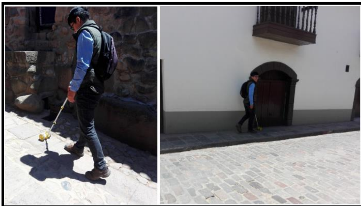
Figura N° 60: Cálculo de la distancia del tramo de sospecha de fuga
