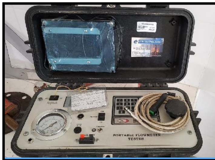
Figura N° 4: Medidor de caudalímetro portátil de la EPS Sedacusco
