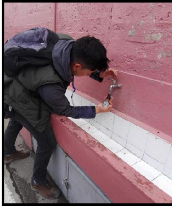
Figura N° 34: Medición de presión en el interior del C.E.P. María Auxiliadora Cusco
