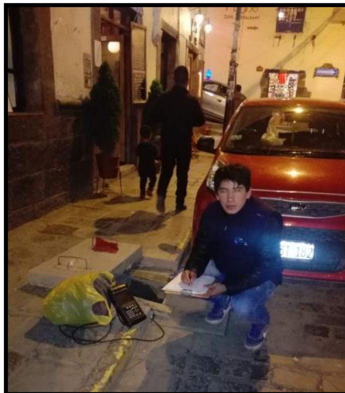
Figura N° 47: Lectura de Caudal Mínimo Nocturno en CL. Choquechaka
