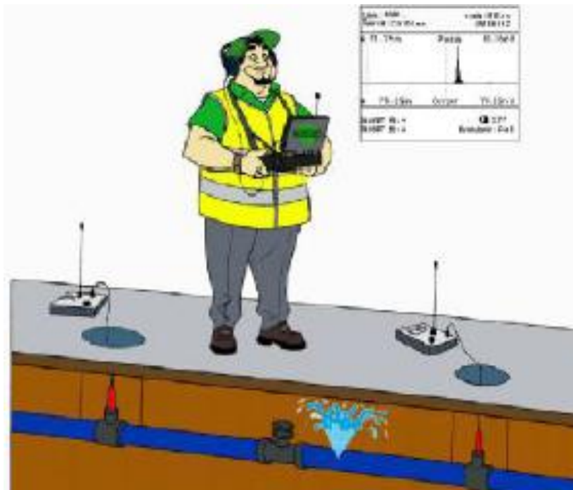
Figura N° 8: Fuga no visible
