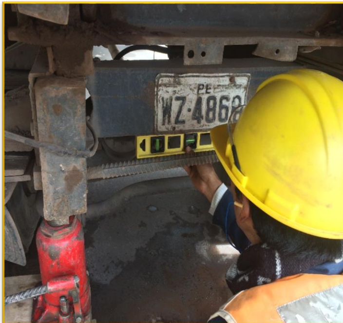
FIGURA N° 114: VERIFICACIÓN DEL VEHÍCULO QUE ESTE A NIVEL EN LA PARTE TRASERA
