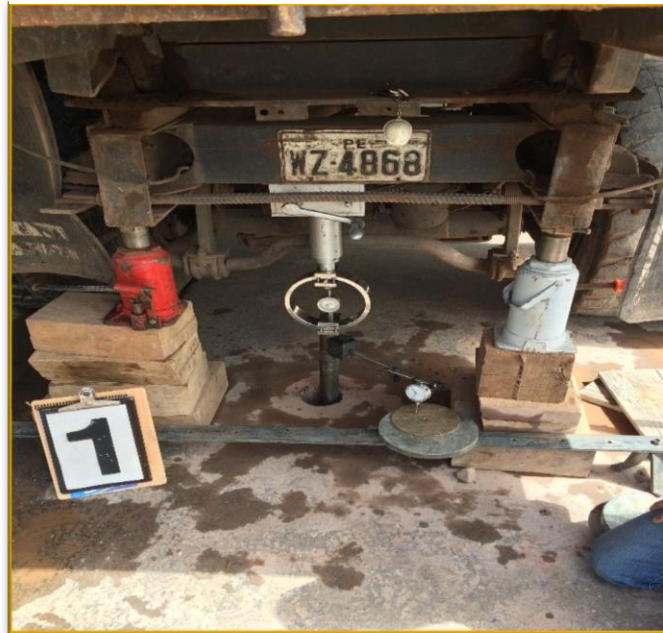
FIGURA N° 115: COLOCACIÓN DE LOS DIALES EN FORMA CORRECTA
