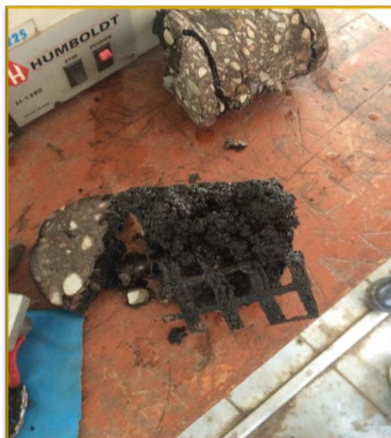
FIGURA N° 111: BRIQUETAS LUEGO DE APLICARLES EN ENSAYO MARSHALL
