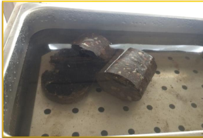
FIGURA N° 109: DESPRENDIMIENTO DE UNA DE LAS BRIQUETAS
