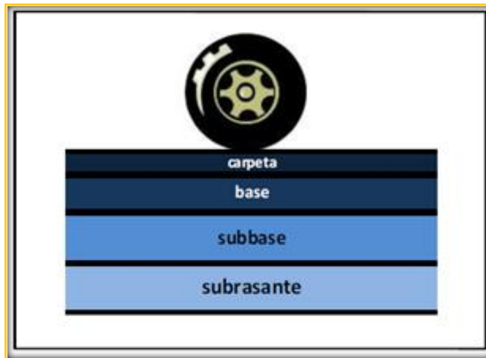
FIGURA N° 3: ESQUEMA TÍPICO DEL PAQUETE ESTRUCTURAL DE UN PAVIMENTO FLEXIBLE
