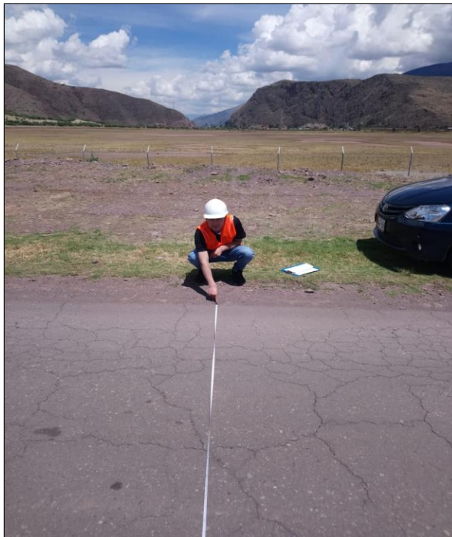
Figura 148: Medición del ancho de calzada.
