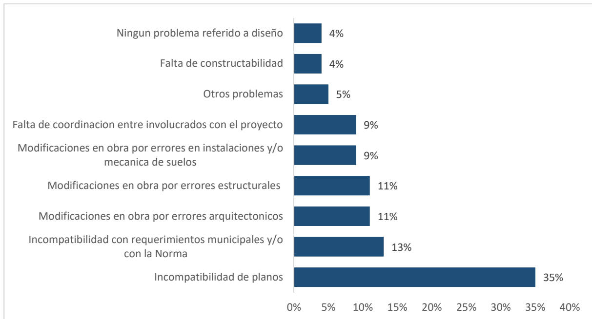
FIGURA 2: Porcentaje de fuentes de problemas en obra producidos desde la Pre-construcción. FUENTE: Juan Vazques - El "Lean Design" y su aplicación a los proyectos de edificación, 2013.
