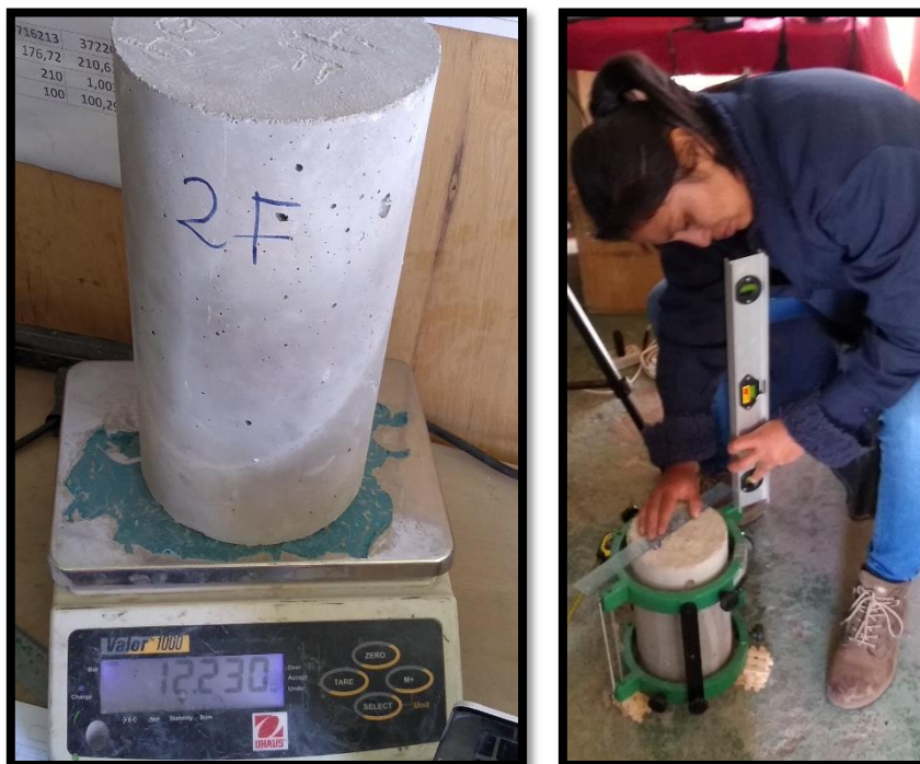
Figura 45: Pesado de briqueta y medida de diámetros.
