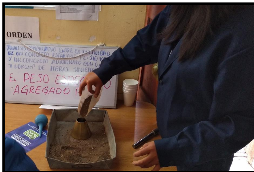
Figura 28: colocado de muestra superficialmente seco en el cono.
