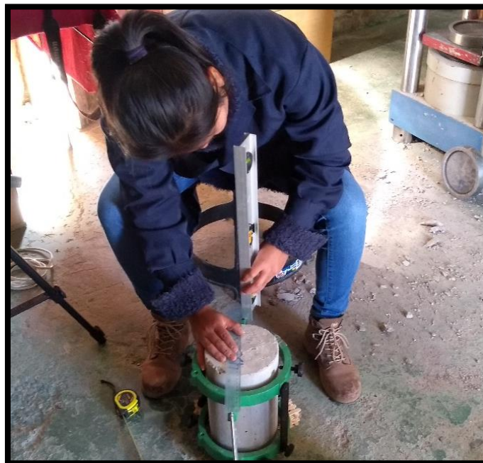
Figura 48: Medición de distancias del eje al pivote y del eje al deformímetro.
