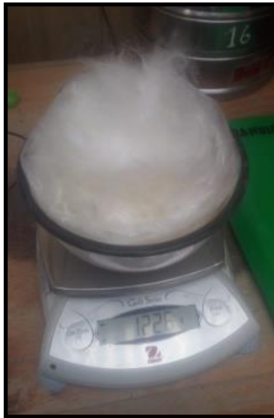
Figura 37: Pesado de fibras sintéticas para el mezclado de concreto.
