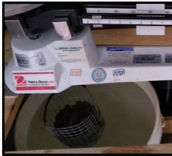
Figura 34: Determinación del peso de la muestra saturada superficialmente seca.
