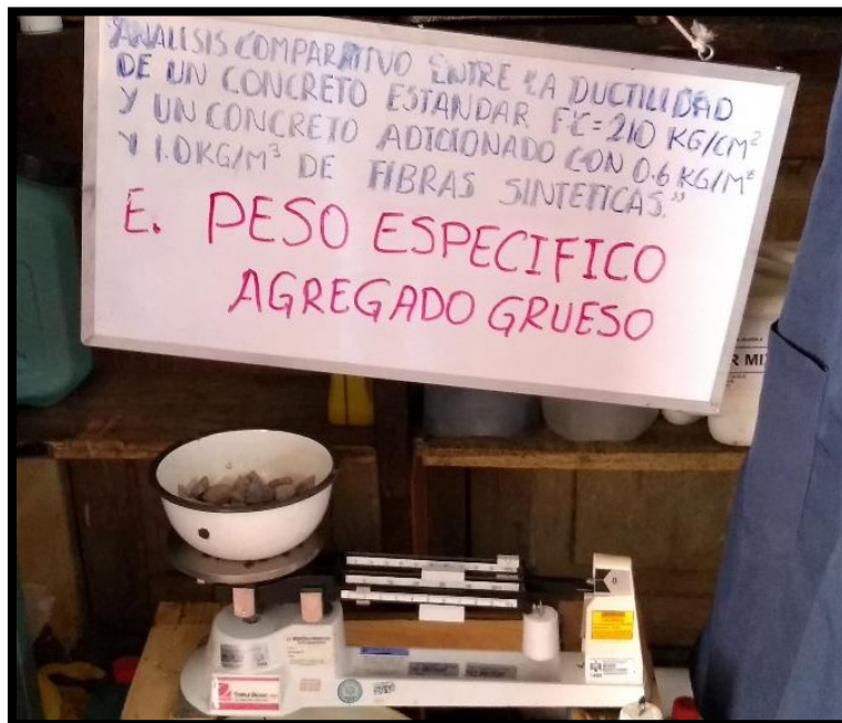
Figura 36: Pesado de la muestra secada en horno por 24 horas.
