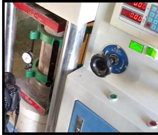
Figura 46: Rotura de briquetas en la máquina de compresión uniaxial.
