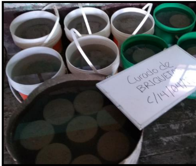
Figura 44: Curado de briquetas.
