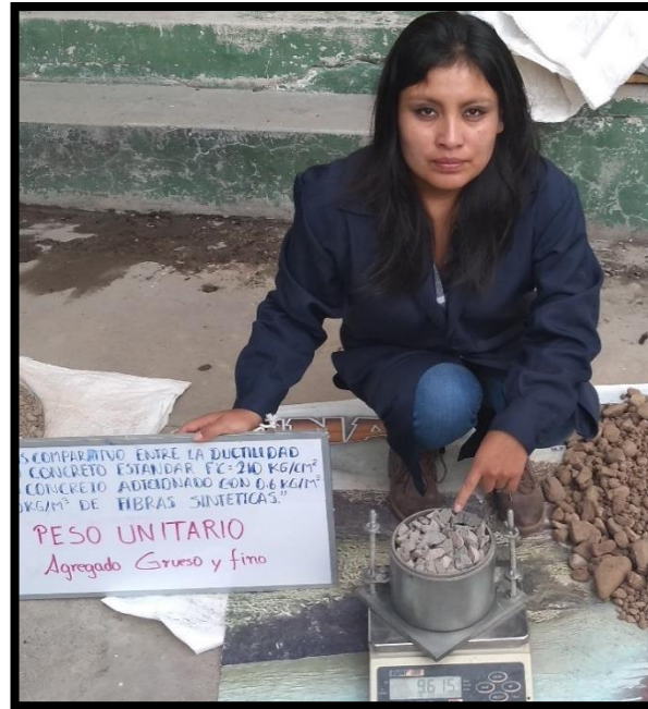
Figura 25: Pesado de agregado grueso.
