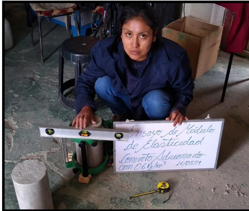
Figura 47: Colocación y nivelación del compresometro.
