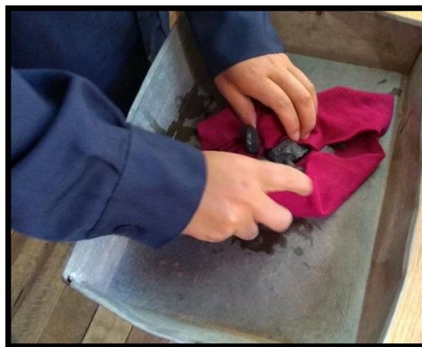
Figura 33: Secado superficial de la muestra sumergida por 24 horas.
