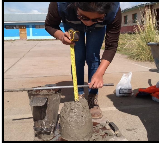
Figura 42: Calculo del slump con el cono de Abrams.
