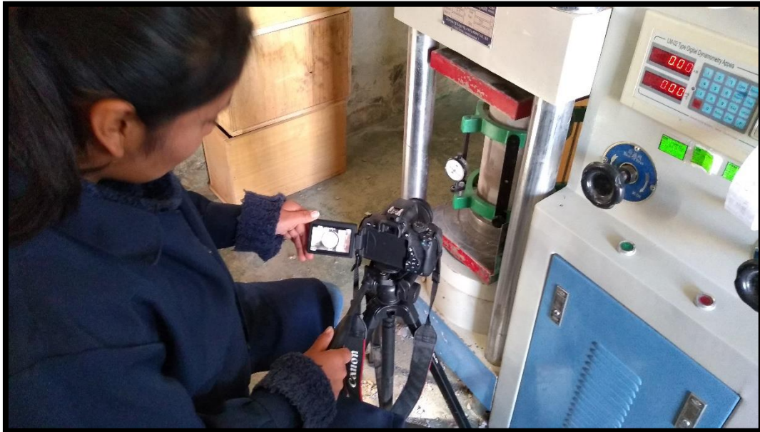
Figura 49: Aplicación de carga a la briqueta.
