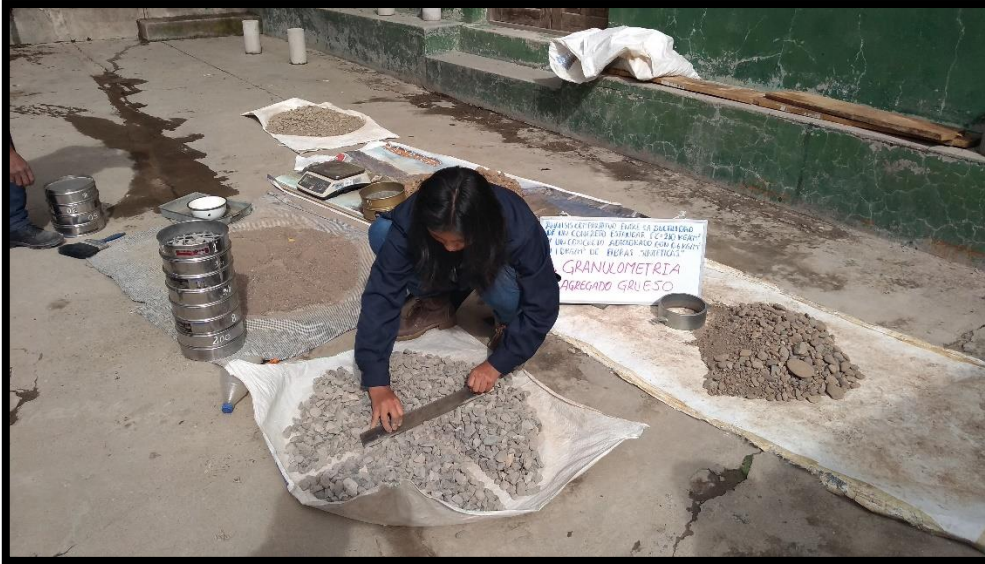
Figura 12: Selección del agregado por el método de cuarteo.
