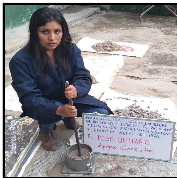
Figura 20: Compactación del agregado fino.
