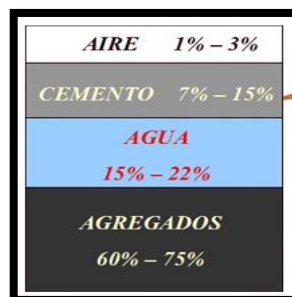
Figura 03: Proporciones típicas en volumen absoluto de los componentes del concreto.
