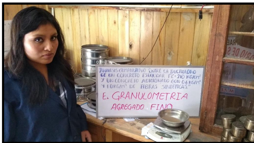
Figura 17: Pesado de agregado fino retenido en cada malla.
