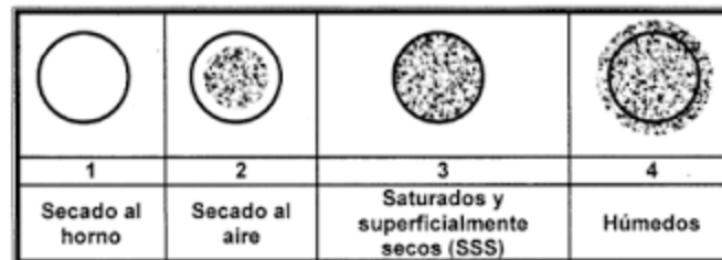
Figura 04: Estados de saturación del agregado.
