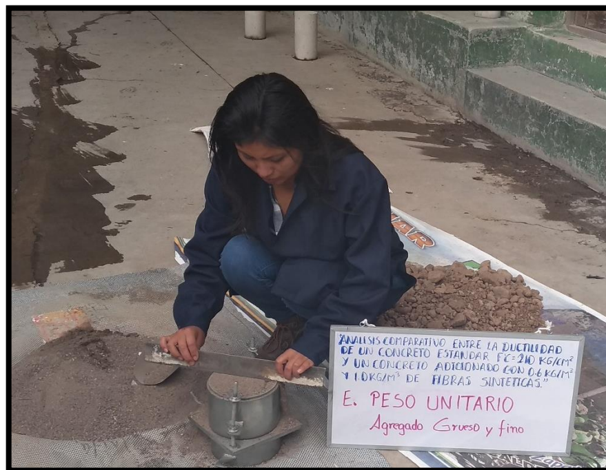
Figura 22: Enrasado de agregado fino en el borde superior del molde.
