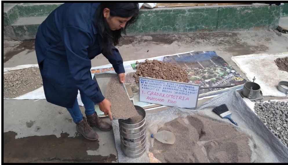
Figura 16: Selección del agregado por el método de cuarteo y colocación de la muestra.
