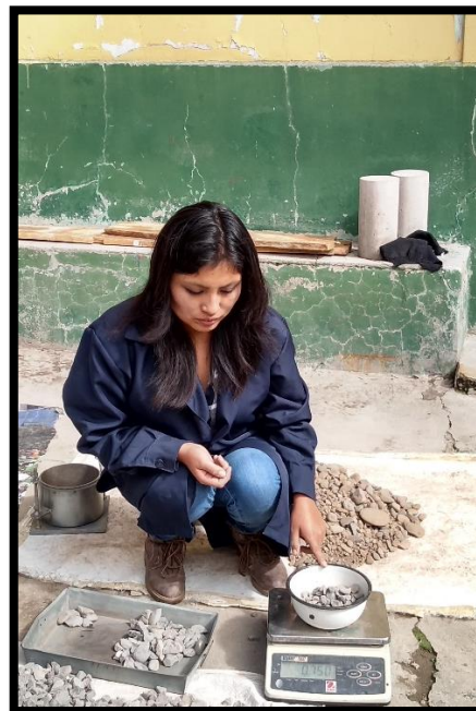
Figura 15: Pesado de agregado grueso retenido en cada malla.
