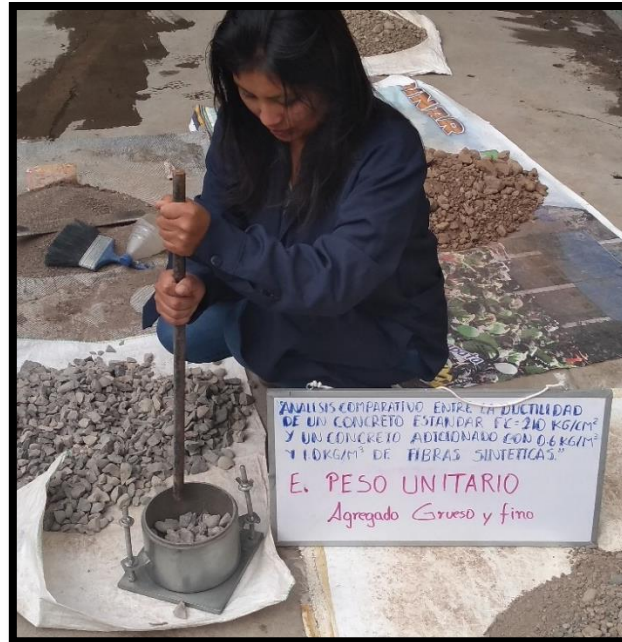
Figura 21: Compactación del agregado grueso.
