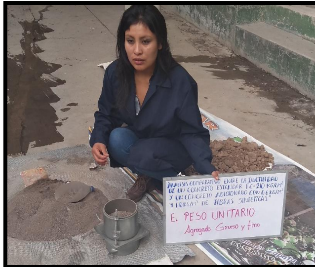
Figura 19: Colocación del agregado fino.
