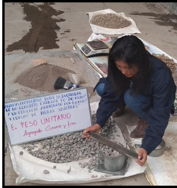
Figura 23: Enrasado de agregado grueso en el borde superior del molde.
