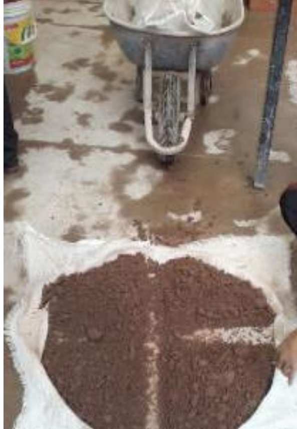
Figura 38: CUARTEADO DE MATERIAL DE LA CANTERA Km 02+700.
