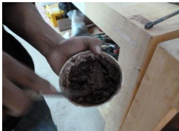
Figura 41: MEZCLADO DE MATERIAL QUE PASA LA MALLA N°40 ADICIONANDO AGUA.
