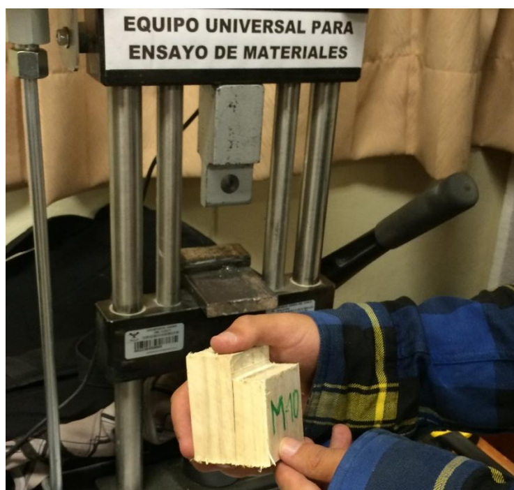
FIGURA 87 FALLO DE LA PROBETA N° 10 ENSAYADA A CIZALLAMIENTO PARALELO AL GRANO
