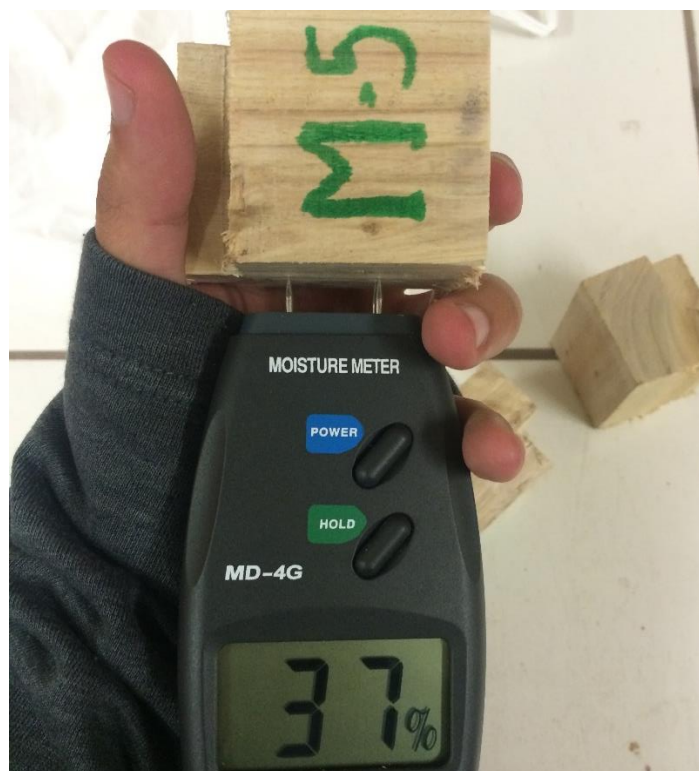
FIGURA 83 CONTENIDO DE HUMEDAD NATURAL DE PROBETAS PARA EL ENSAYO DE CIZALLAMIENTO PARALELO AL GRANO
