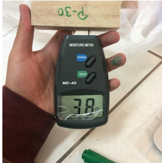
FIGURA 37 MEDICIÓN DE HUMEDAD
