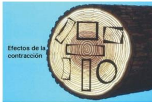
FIGURA 10 EFECTOS DE LA CONTRACCIÓN EN LA MADERA.
