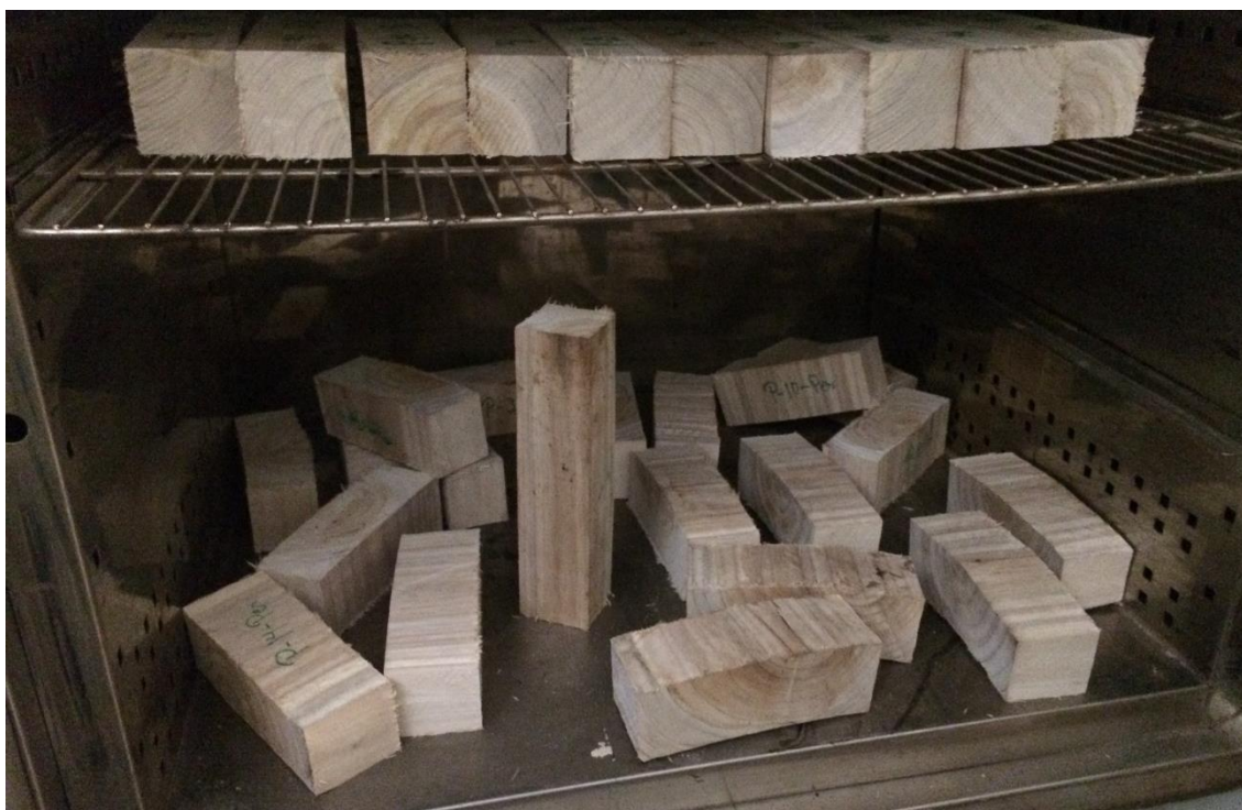
FIGURA 71 PROBETAS SECADAS EN EL HORNO A 110°C
