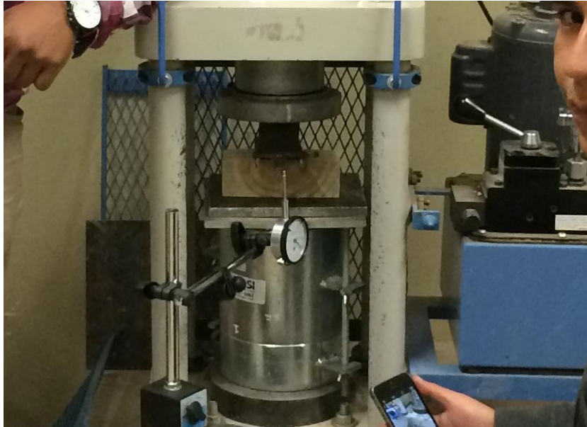
FIGURA 51 ACONDICIONAMIENTO DE LA MAQUINA PARA EL ENSAYO DE COMPRESIÓN PERPENDICULAR
