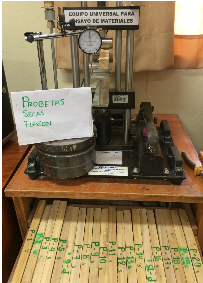
FIGURA 54 EQUIPO UNIVERSAL PARA ENSAYOS DE MATERIALES ACONDICIONADA PARA EL ENSAYO DE FLEXIÓN ESTÁTICA
