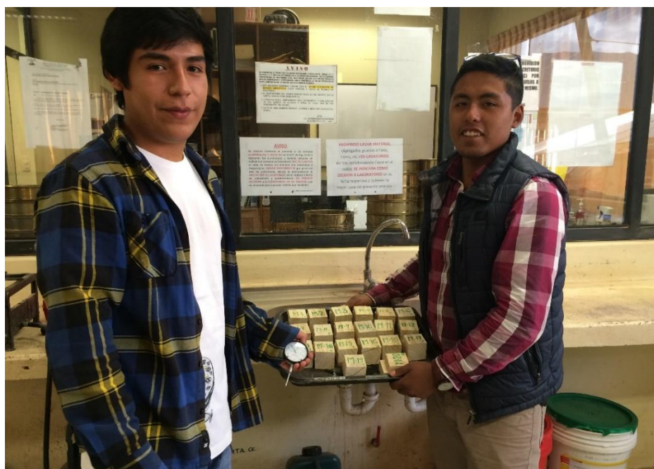
FIGURA 85 PROBETAS CON CONTENIDO DE HUMEDAD SECO ENSAYO DE CIZALLAMIENTO PARALELO AL GRANO
