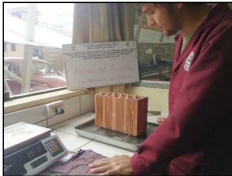
Figura 45 Ensayo de Succión de unidades de albañilería y posterior pesaje
