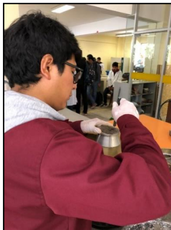
Figura 52 Compactado de la muestra sobre la mesa de flujo
