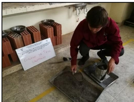
Figura 51 Llenado de agregado fino en el molde cilíndrico
