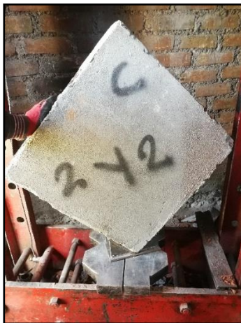
Figura 62 Colocado de especímenes en la máquina de Compresión Diagonal y falla de muretes ensayado
