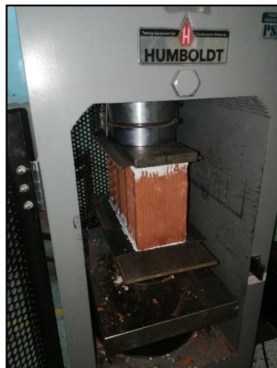
Figura 46 Unidades de albañilería ensayadas en la máquina de compresión
