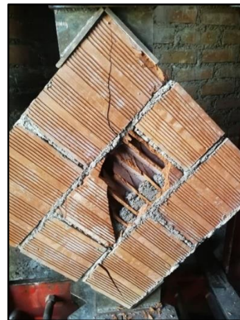
Figura 62 Colocado de especímenes en la máquina de Compresión Diagonal y falla de muretes ensayado
