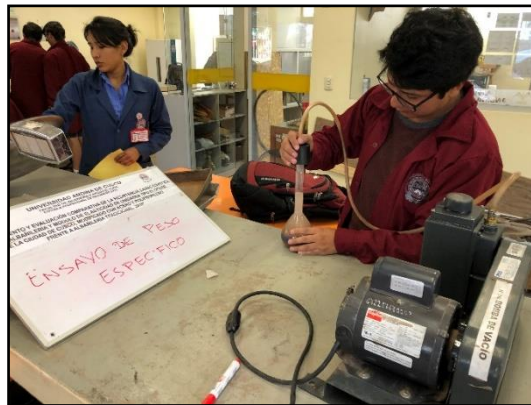
Figura 50 Se retiro el aire atrapado con ayuda de la bomba de vacíos
