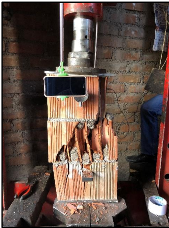
Figura 56 Falla producida en un prisma ensayado
