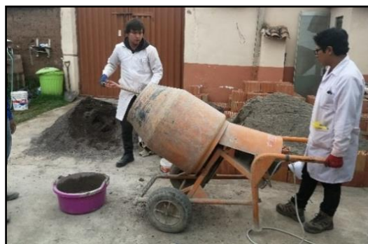
Figura 53 Preparación del mortero para el asentado de los prismas de albañilería
