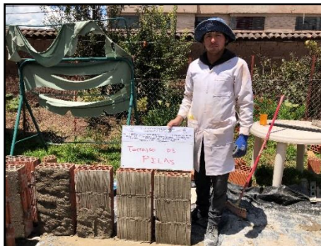
Figura 54 Tarrajeo de prismas de albañilería
