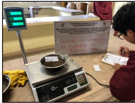
Figura 48 Registro de peso de las muestras de 500 gr de agregado fino
