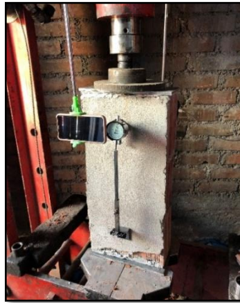
Figura 55 Espécimen colocado en la máquina de compresión para ser ensayado
