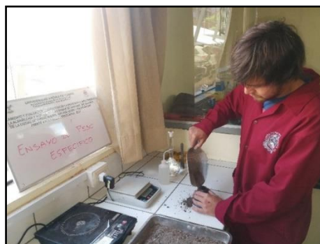
Figura 49 Llenado del cono de absorción para compactar con el pisón
