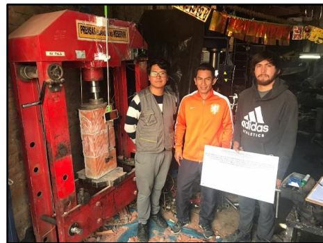
Figura 57 Supervisión del ingeniero asesor para ensayo de Compresión de prismas de albañilería
