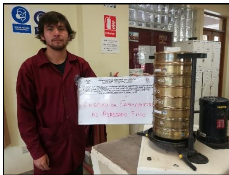
Figura 47 Ensayo de Granulometría – Tamizado de la muestra
