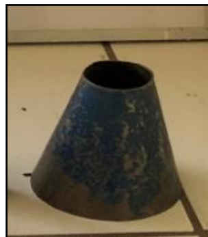
Figura 34 Molde cónico metálico o cono de absorción
