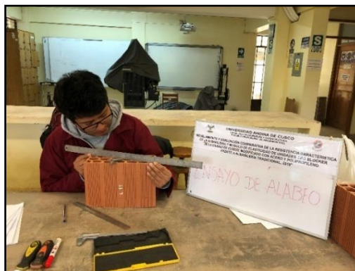
Figura 43 Ensayo de Alabeo de unidades de albañilería
