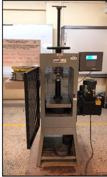
Figura 32 Maquina de compresión axial
