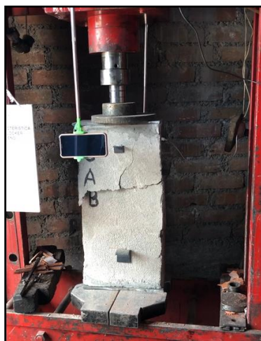
Figura 23 Falla por aplastamiento por pandeo – Prisma 3 AB a
