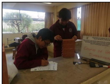
Figura 42 Ensayo de Variación Dimensional de unidades de albañilería
