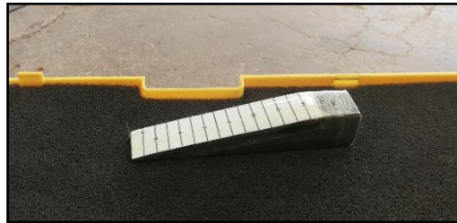
Figura 31 Cuña metálica graduada
