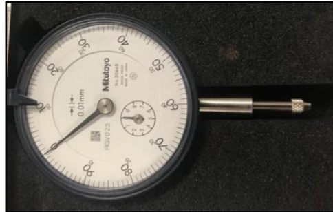
Figura 41 Dial o deformímetro
