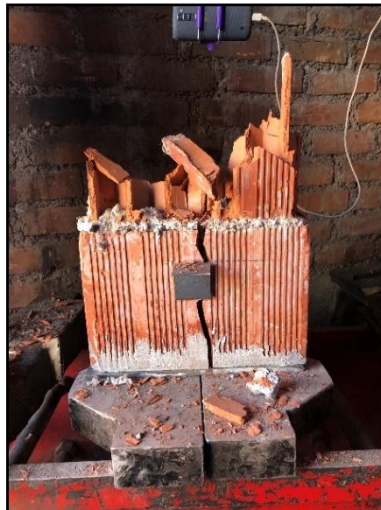
Figura 21 Falla por trituración – Prisma 2 AR b
