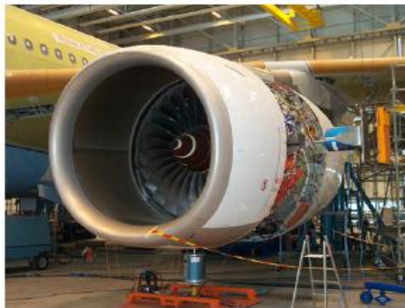
Figura 4: Distribución por posición fija: ensamble de un avión Airbus A340/600 en la planta de Airbus en Tolueno (Francia)
