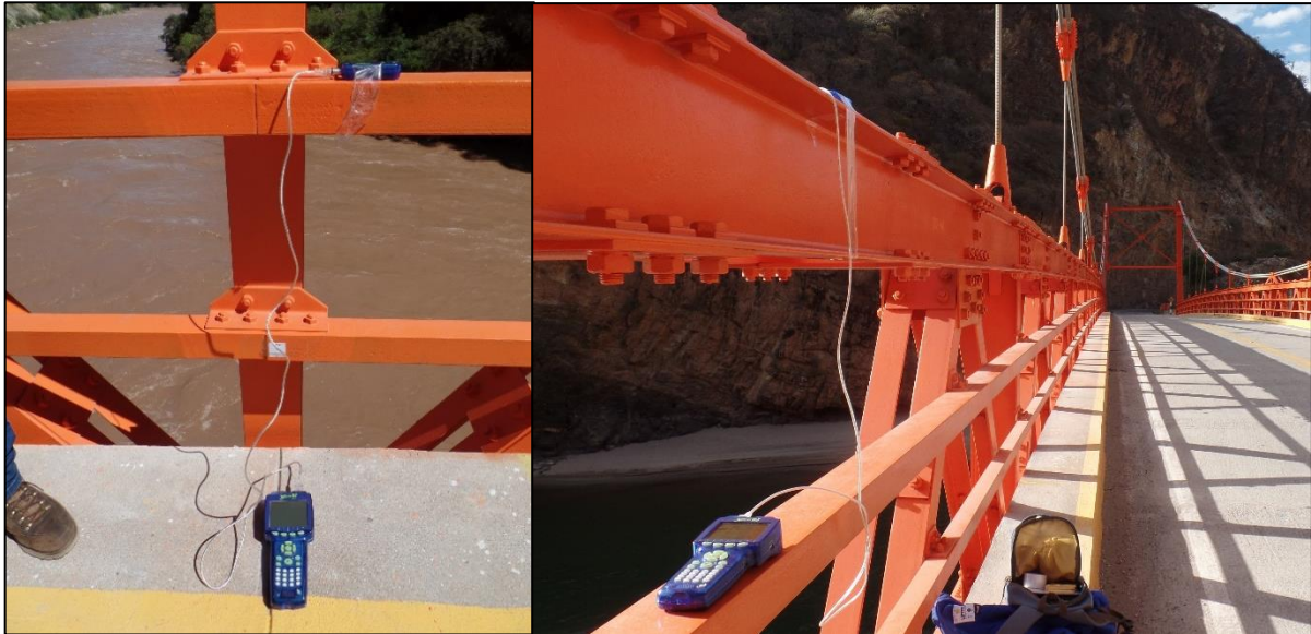
Figura 53. Registro de aceleraciones en viga de rigidez
