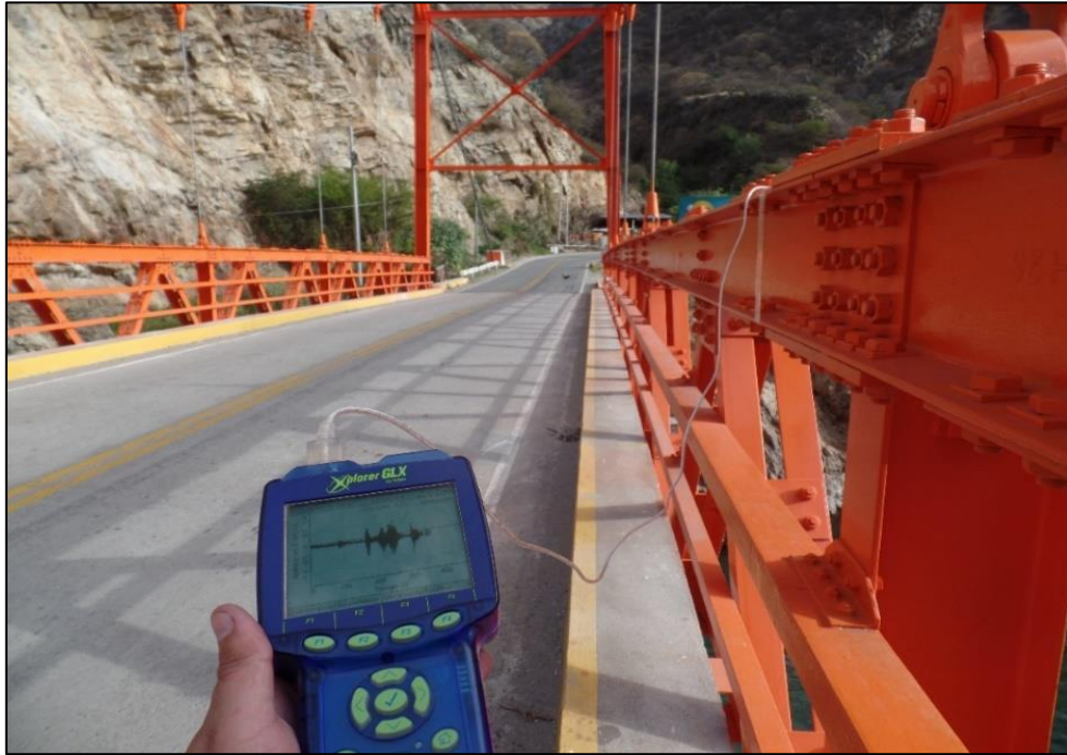
Figura 57. Detalle del registro de vibraciones del punto Diag. ABC, medición llevada a cabo sobre la viga de rigidez,
