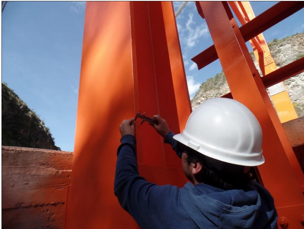
Figura 45. Vista del proceso de medición de las alas del perfil estructural armado de la torre principal.
