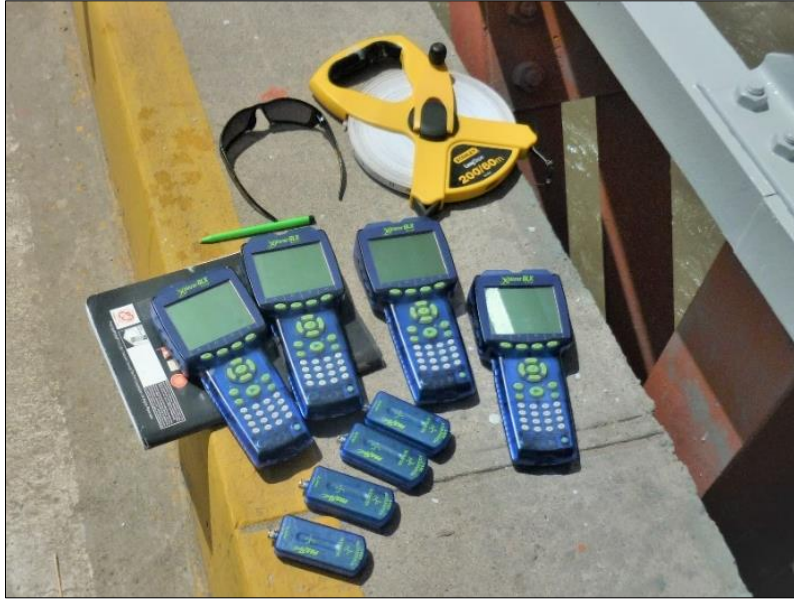
Figura 51. Equipos necesarios para medir las vibraciones, recolectores GLX Pasco y Acelerómetros triaxiales antes de su instalación.
