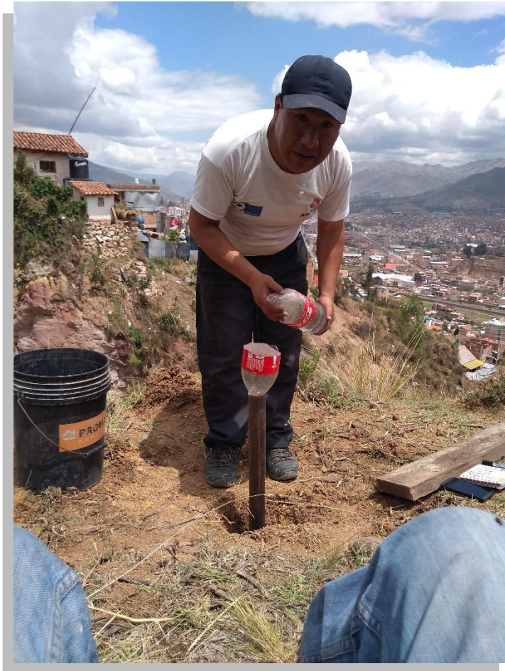
Figura 65. Relleno de agua en la tubería cribada de acero de 3'.
