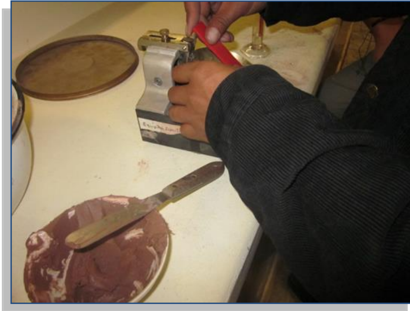
Figura 45. División de la superficie del suelo mediante el Acanalador.
