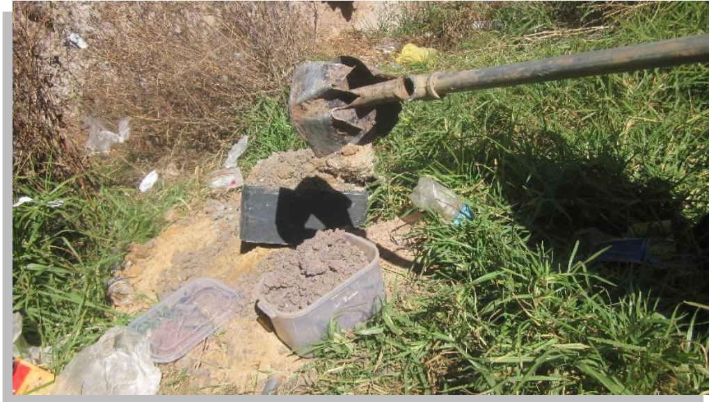
Figura 57. Extracción de muestra de suelo con Posteadora Fuente: Elaboración Propia.
