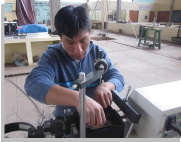
Figura 60. Colocación de muestra de suelo en la caja de corte.
