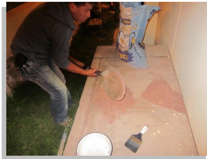
Figura 35. Recojo del material seleccionado por cuarteo del estrato N° 1.
