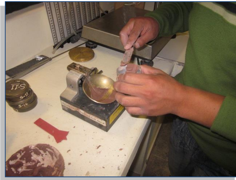
Figura 46. Colocación de la muestra de Suelo al recipiente después de realizar el Ensayo.
