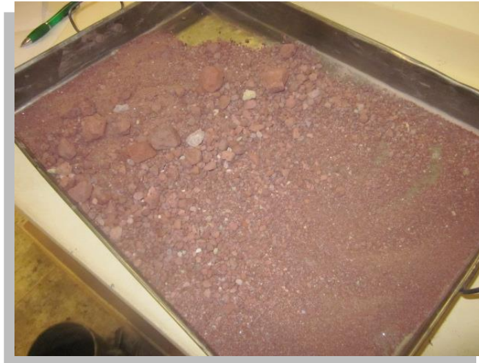
Figura 37. Muestra seca, sacado después de las 24 horas del horno.
