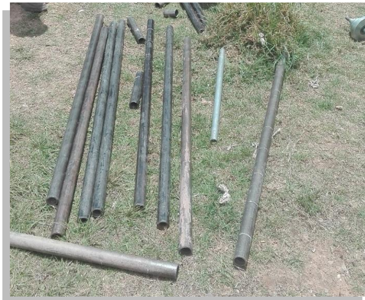
Figura 51. Barras de perforación utilizadas para las prospecciones SPT 1 y SPT 2.
