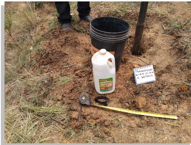
Figura 62. Herramientas utilizadas durante el ensayo (tubo de acero cribado de 3”, flexómetro, cronómetro y agua).
