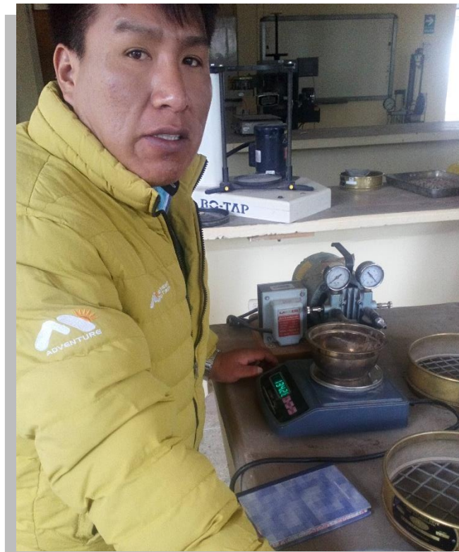
Figura 41. Registro del peso retenido en cada malla del estrato N° 5.
