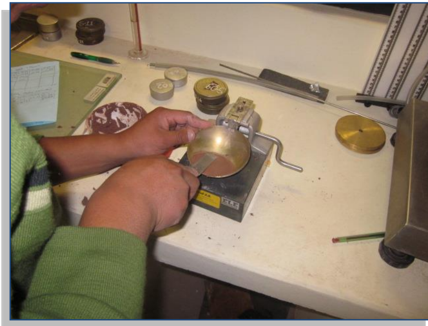
Figura 44. Obtención De La Superficie Uniforme En La Taza De Bronce A 1 Cm De Profundidad Aproximado.
