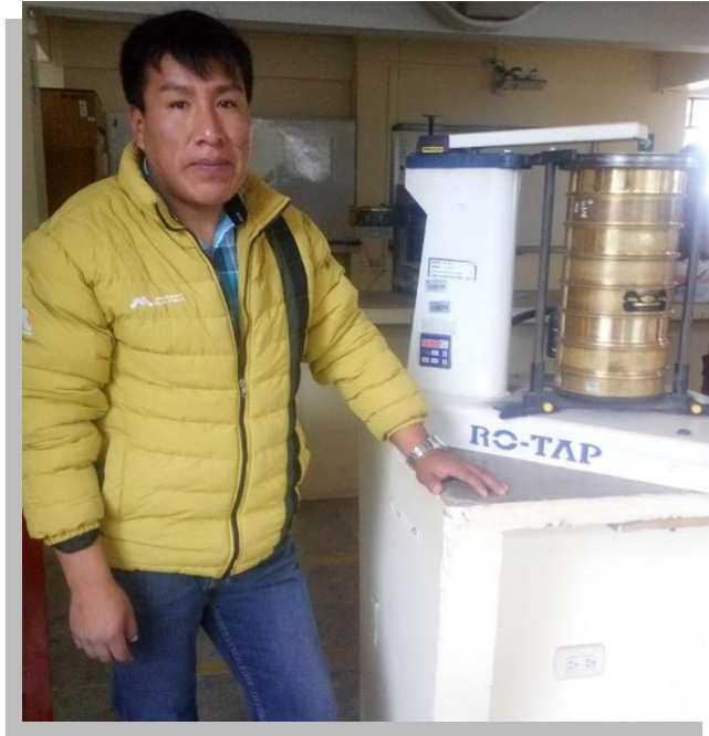
Figura 40. Tamizado de la muestra de suelo estrato N° 5.
