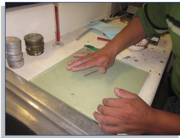
Figura 48. Moldeo De La Muestra Sobre La Superficie De Vidrio.
