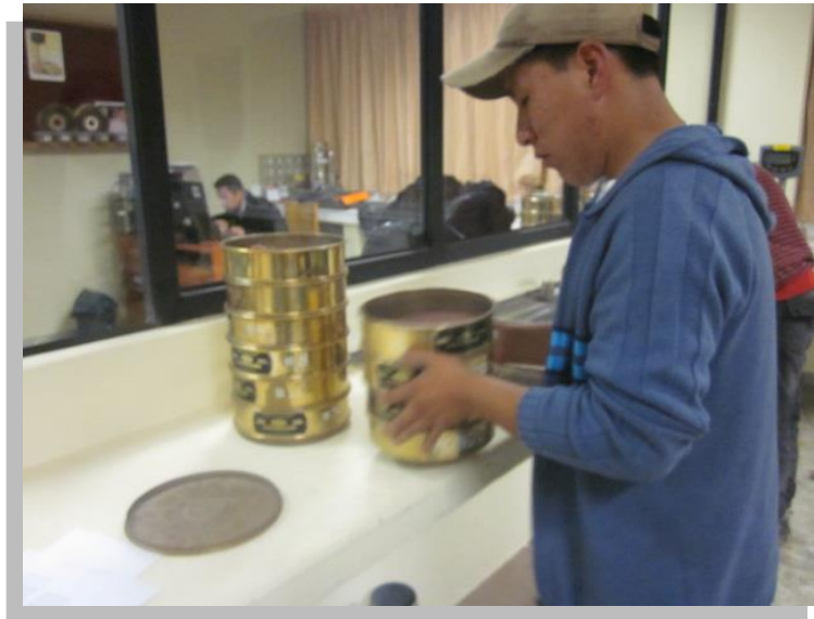
Figura 38. Tamizado Manual De La Muestra de suelo en estrato N°3.
