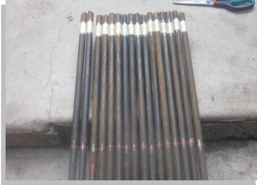
Figura 68. Etiquetado y marcado en las varillas de acero de 3/8”.
