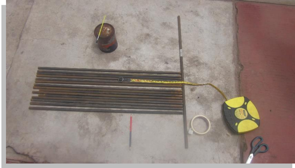
Figura 66. Herramientas y materiales para registro de datos de suelo erosiona en el talud.
