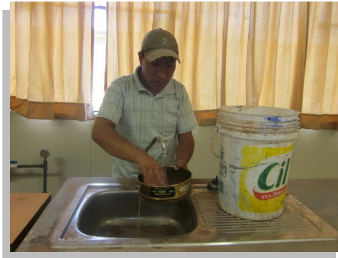
Figura 36. Lavado De La Muestra de suelo del estrato N°4, a Través De La Malla N° 200.
