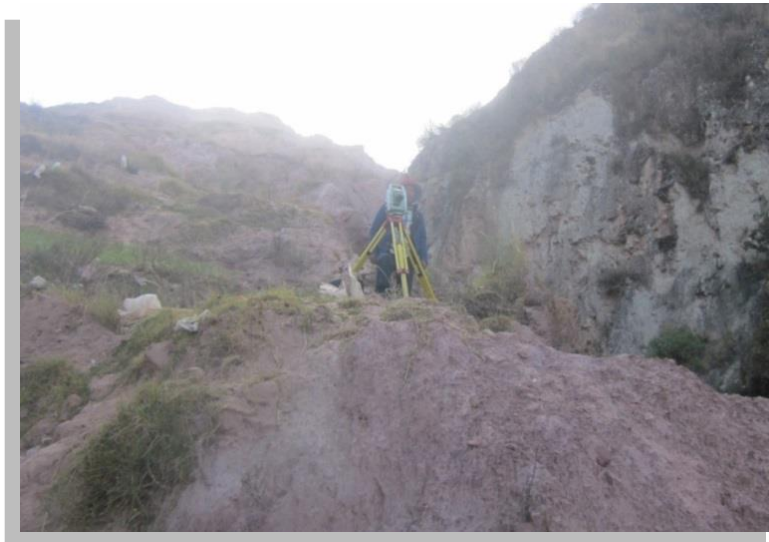
Figura 30. Levantamiento Topográfico Desde El Vértice “C” Del Polígono De Apoyo.
