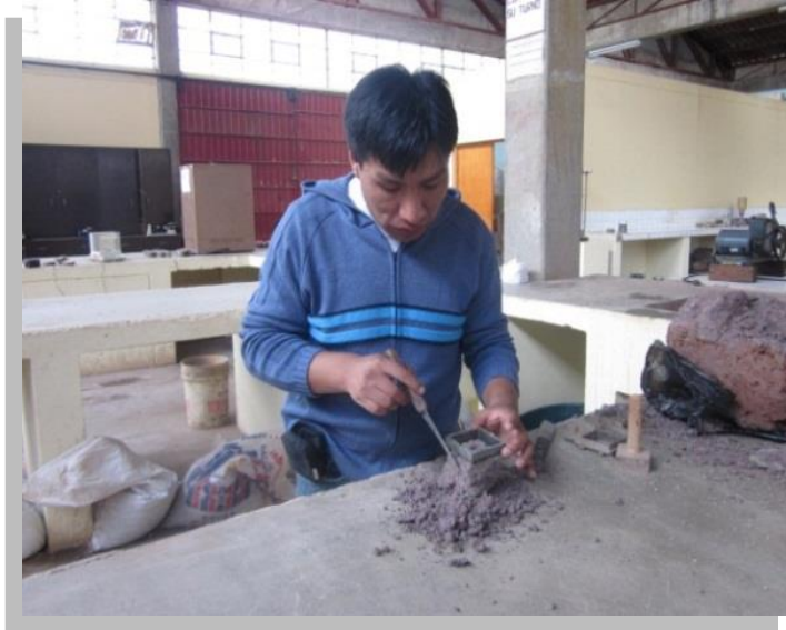
Figura 58. Investigador preparando y tallando la muestra para colocar en la caja de Cizalladura.
