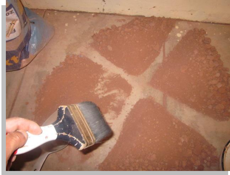
Figura 34. Cuarteo del suelo del estrato N° 1.
