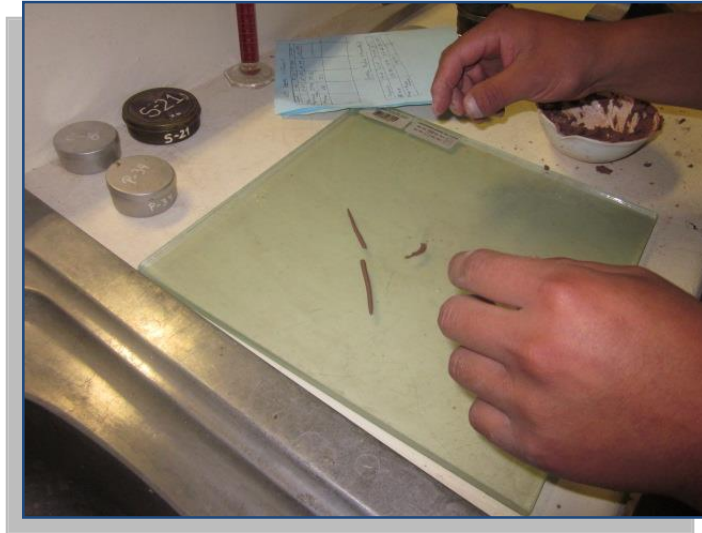
Figura 49. Desmoronamiento De La Muestra Sobre La Superficie De Vidrio.
