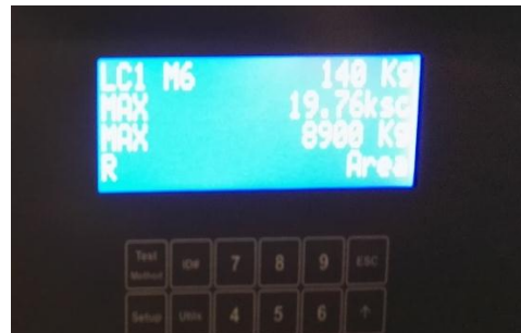
Figura 224 : Carga maxima registrada (8900 kgf) de una unidad de adobe mejorado con material calcáreo al 15%.
