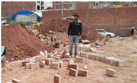
Figura 185 : Adobe mejorado con material calcáreo al 25 %
