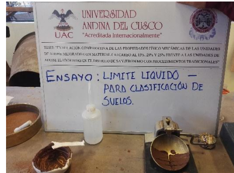
Figura 202 : Ensayo de limite liquido para clasificacion de suelos.
