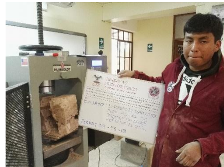
Figura 228 : Ensayo de resistencia a la compresion de pilas de adobe mejorado con material calcáreo al 25%.
