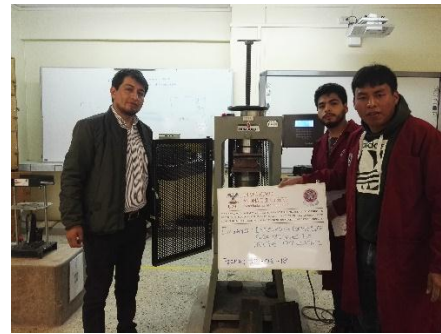
Figura 222 : Ensayo de resistencia a la compresion de unidades de adobe tradicional.
