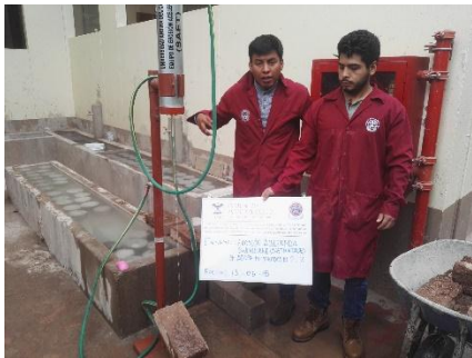
Figura 221 : Emsayo de SAET en una unidad de adobe mejorado con material calcáreo al 20%.
