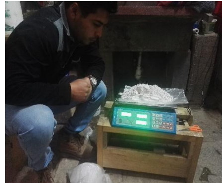
Figura 180 : Pesamos el volumen separado en el molde (se repite este proceso para cada porcentaje de adiccion).
