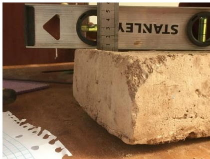
Figura 209 : Ensayo de alabeo, medicion de la concavidad de una unidad de adobe mejorado con material calcáreo al 20%.
