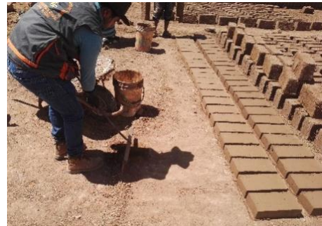
Figura 184 : Adobe mejorado con material calcáreo al 20 %
