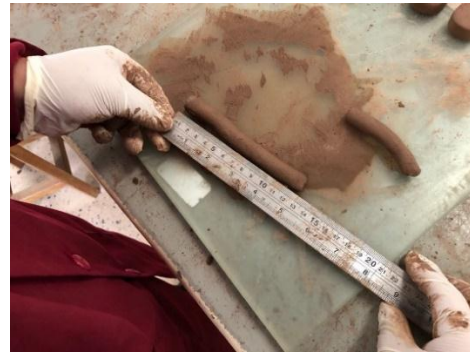
Figura 196 : Cinta de barro rota en un extremo de 12.8 cm de longitud.
