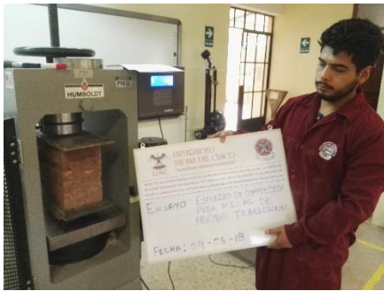
Figura 227 : Ensayo de resistencia a la compresion de pilas de adobe tradicional.
