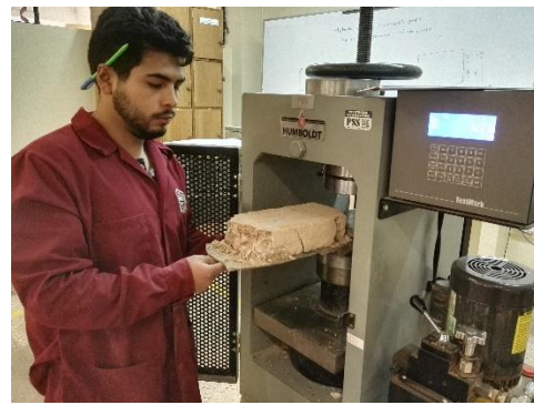
Figura 226 : Unidad de adobe mejorado con material calcáreo al 25% despues del ensayo de resistencia a la compresion.
