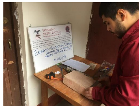
Figura 212 : Registro del ancho en centrimetros de un adobe mejorado con material calcáreo al 15%, en el ensayo de variacion dimensional.
