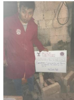
Figura 216 : Unidades ensayadas a succión de adobe mejorado con material calcáreo al 20 %.
