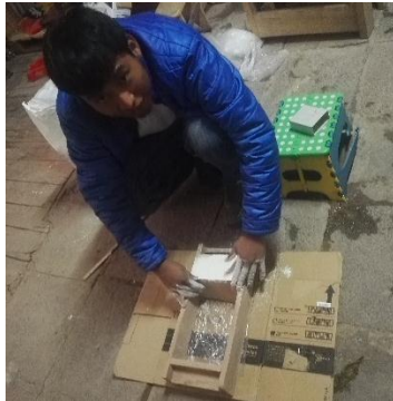
Figura 179 : Racionamiento de la cal con respecto al volumen del molde (se repite este proceso para cada porcentaje de adiccion).
