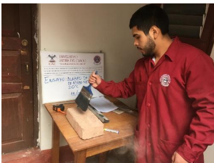
Figura 211 : Preparado de una unidad de adobe mejorado con material calcáreo al 15% para el ensayo de variacion dimensional.
