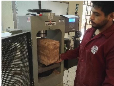
Figura 233 : Pila de adobe mejorado con material calcáreo al 15 % ingresando a la maquina de resistencia a la compresion.
