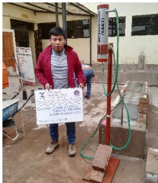
Figura 217 : Ensayo de SAET en unidades de adobe mejorado al 15%.
