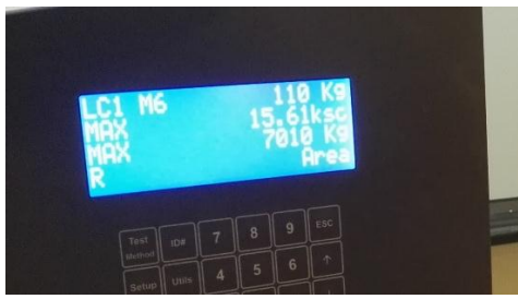
Figura 225 : Carga maxima registrada (7010 kgf) de una unidad de adobe mejorado con material calcáreo al 25%.
