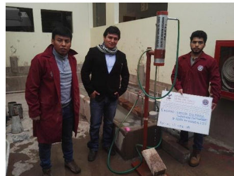
Figura 218 : Ensayo SAET de un adobe mejorado con material calcáreo al 25%.
