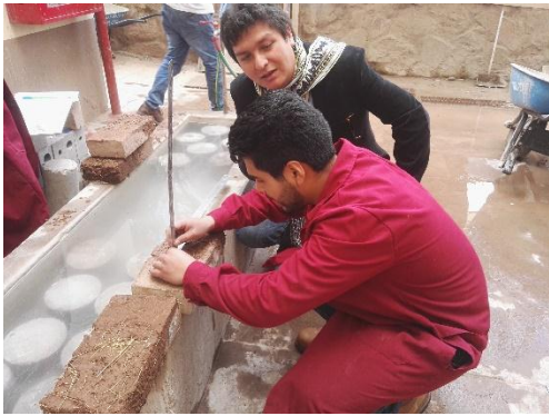
Figura 219 : Medicion de la oquedad de una unidades de adobe mejorado con material calcáreo al 20%.
