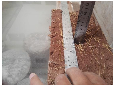
Figura 220 : Medicion de la oquedad de una unidades de adobe tradicional.
