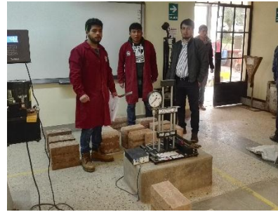
Figura 234 : Pilas de adobe (adobe tradicional y adobe mejorado con material calcáreo al 15%, 20% y 25%).
