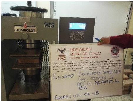
Figura 223 : Ensayo de resistencia a la compresion de unidades adobe mejorado con material calcáreo al 15%.
