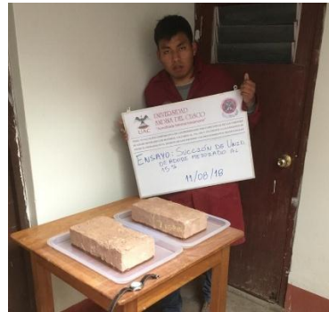
Figura 214 : Unidades de adobe mejorado con material calcáreo al 20% en contacto con espejo de agua durante 1 minuto.
