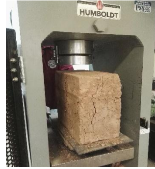
Figura 232 : Pila de adobe mejorado con material calcáreo al 20 % despues del ensayo de resistencia a la compresion.
