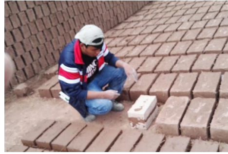
Figura 190 : Union de dos unidades de adobe con mortero de 2cm de espesor para elaboración de pilas
