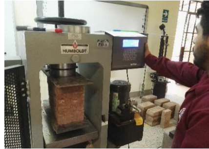
Figura 110: Colocamos la pila con superficies de neopreno en ambas caras de contacto en la maquina de compresion.
