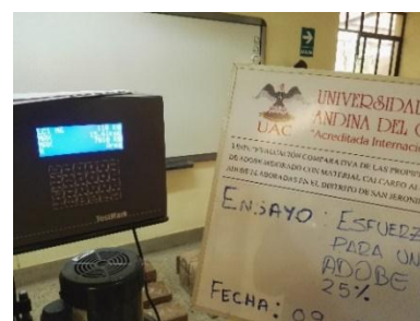
Figura 108: Tomamos nota de la carga registrada en la maquina de compresion.
