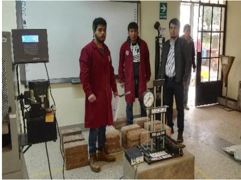
Figura 109: Se midió el área de contacto de la pila con la maquina de compresion.
