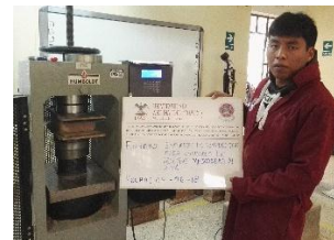
Figura 106: Se coloco la unidad en la maquina con las respectivas laminas de neopreno en ambas caras de la unidad.
