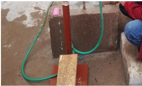
Figura 99: Se colocó la unidad de albañilería en el soporte en un ángulo de 27°.
