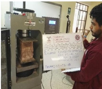
Figura 111: Se sometio la pila a compresion hasta el fallo.
