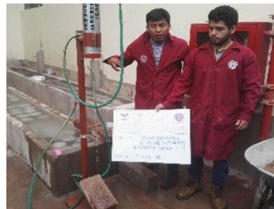
Figura 100: Se dejó fluir el agua sobre la unidad de adobe.
