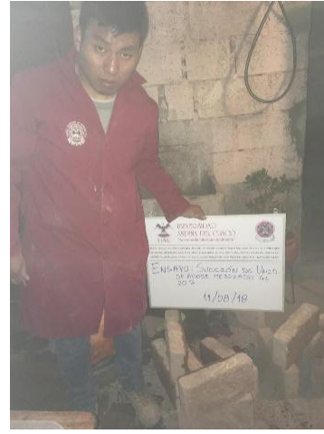
Figura 98: Unidades ensayadas a succion de adobe mejrado con material calcáreo al 20 %.
