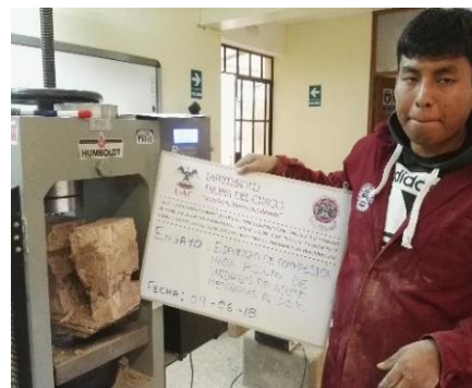
Figura 112: Pila Fracturada Despues de Ser Sometida a Compresion.
