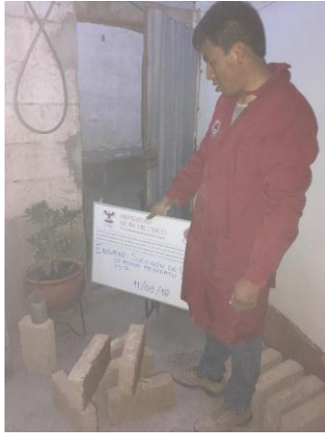
Figura 97: Unidades ensayadas a succion de adobe mejorado con material calcáreo al 15%.
