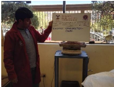
Figura 79: Colocamos el material de muestra en la balanza de precisión.
