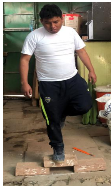
Figura 46 : Posterior al secado se efectúa el control de calidad ante el peso de un hombre, en las unidades de adobe mejoradas con material calcáreo al 20%.
