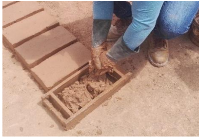
Figura 38 : Se coloca la mezcla dentro del molde
