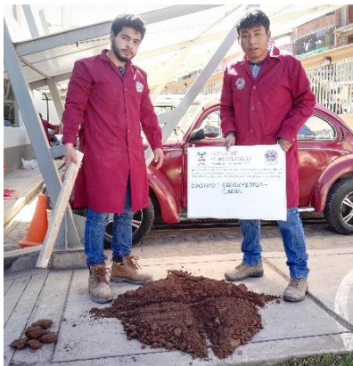
Figura 64: Cuarteo de la muestra de suelo.
