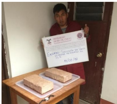
Figura 95: Colocamos la unidad en la bandeja durante 1 minuto.
