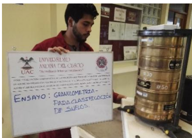
Figura 81: Procedimiento de zarandeo del material.
