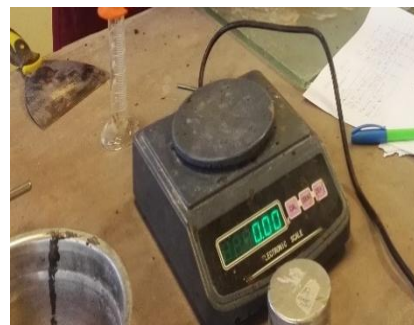
Figura 76: Pesado de la muestras previo a su secado al horno.
