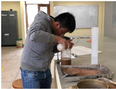
Figura 52: Llenar la botella hasta la mitad con la muestra de suelo
