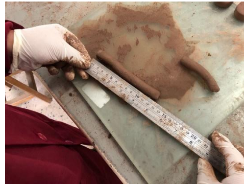
Figura 59: Cinta de barro rota en un extremo de doce punto ocho centímetros de longitud.
