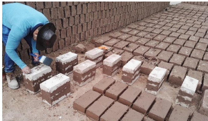
Figura 51 : Secado al aire libre de las pilas de adobe tradicional y adobe mejorado don material calcáreo al 15%, 20% y 25%.
