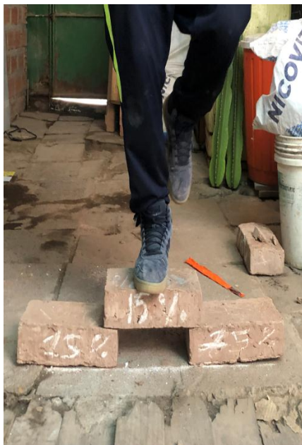
Figura 45 : Posterior al secado se efectúa el control de calidad ante el peso de un hombre, en las unidades de adobe mejoradas con material calcáreo al 15%.
