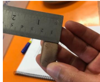
Figura 61: Verificación de la altura de 2 cm. de los discos de barro.
