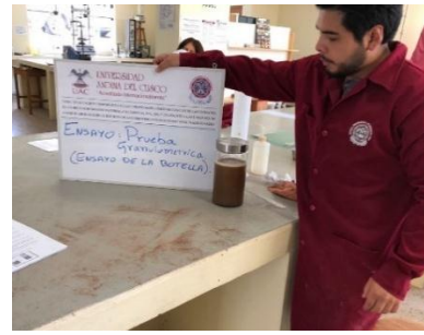
Figura 53: Llenar con agua a una altura similar a la muestra de suelo en la botella y sacudir la botella hasta obtener una mezcla uniforme.
