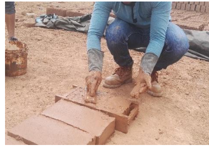
Figura 39 : Compactacion de la mezcla
