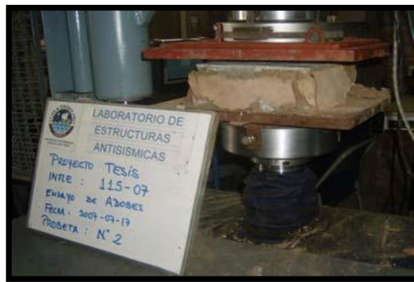
Figura 23 : Ensayo de resistencia a la compresión.
