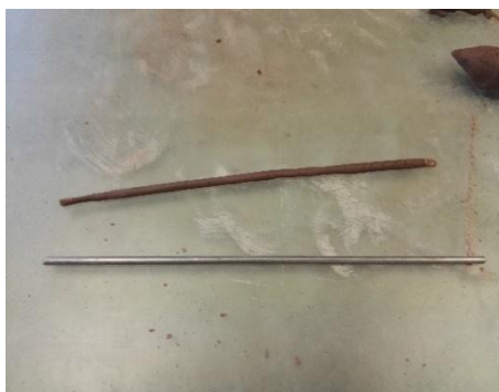
Figura 75: Fisuración de los cilindros de 3 mm de diámetro que indican que la muestra está lista.
