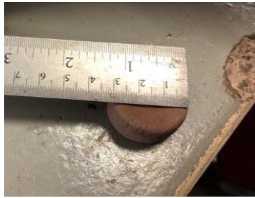
Figura 60: Verificación del diámetro de 3 cm. de los discos de barro.
