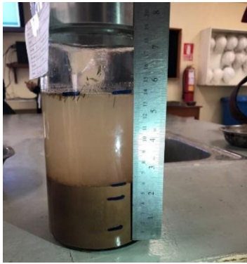
Figura 56: Medición de cada capa de suelo en centímetros.
