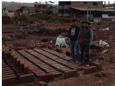
Figura 40 : Adobe mejorado con material calcáreo al 15%
