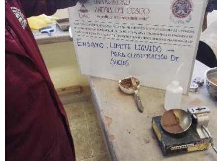
Figura 68: Muestra húmeda en la cuchara de casagrande.
