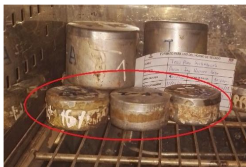
Figura 71: Colocado al horno a 110°C durante 24 horas.
