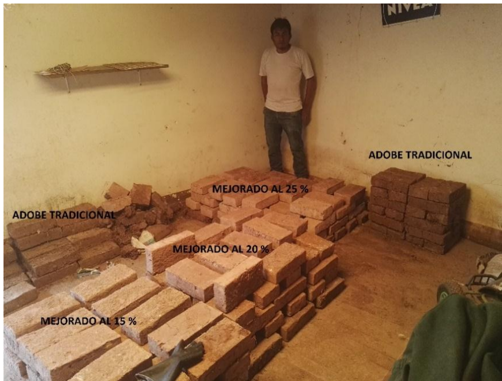
Figura 44 : Adobe tradicional y adobe mejorado con material calcáreo al 15%, 20% y 25%
