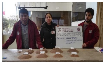
Figura 82: Se peso y resgistro, el material retenido en cada malla.
