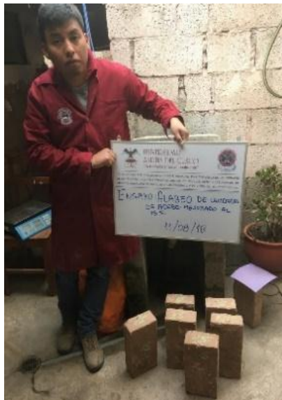
Figura 85: Unidades ensayadas de adobe mejorado con material calcáreo al 15%.
