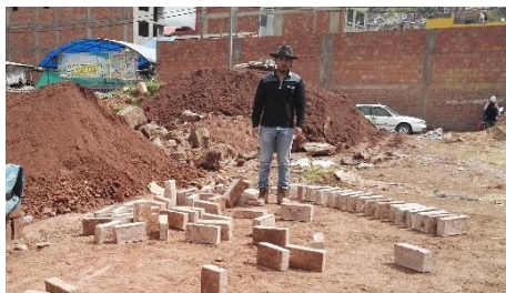
Figura 42 : Secado de adobe mejorado con material calcáreo al 25%
