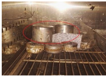
Figura 77: Colocado al horno a 110°C durante 24 horas.
