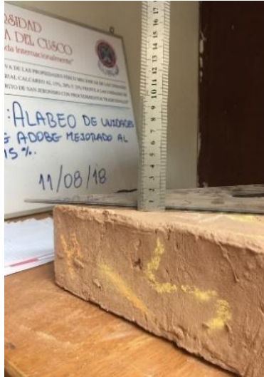
Figura 83: Medida de la concavidad de la cara “a” en milímetros.
