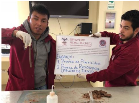
Figura 58: Cinta de barro suspendida de uno punto cinco centímetros de espesor.
