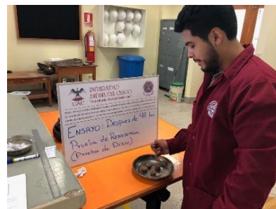
Figura 63: Rotura de los discos de barro.
