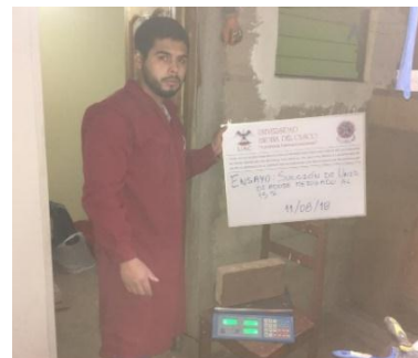
Figura 96: Registramos el peso de la unidad despues de ser sometido a succión.
