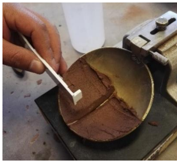
Figura 69: División de la muestra con el ranurador.
