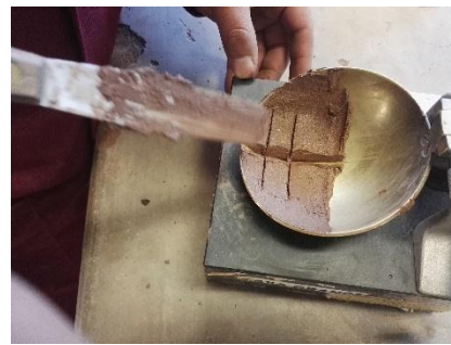
Figura 70: Separando la muestra con la ayuda del ranurador
