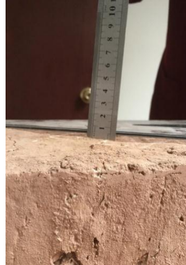
Figura 84: Medida de la concavidad de la cara “b” en milímetros.
