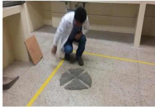
Figura 15: Cuarteo de agregado
