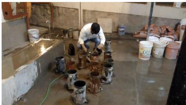
Figura 58: Limpieza de briquetas
