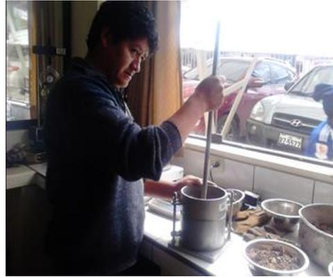
Figura 19: Vaciado de agregado fino a molde    Figura 20: Varillado de agregado
