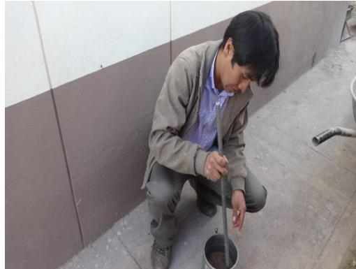
Figura 22: Molde con 1ra capa de agregado    Figura 23: Varillado por capas de agregado
