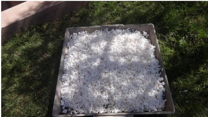
Figura 1: Perlas de poliestireno expandido
