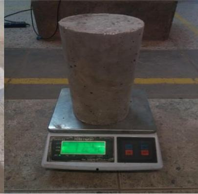
Figura 66: Pesado de Testigos por dosificación
