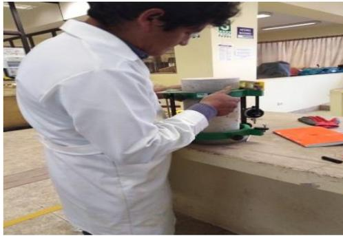
Figura 76: colocación de anillo
