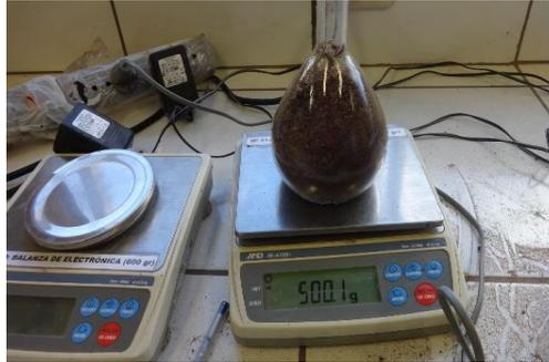
Figura 29: Peso de probeta con agregado
