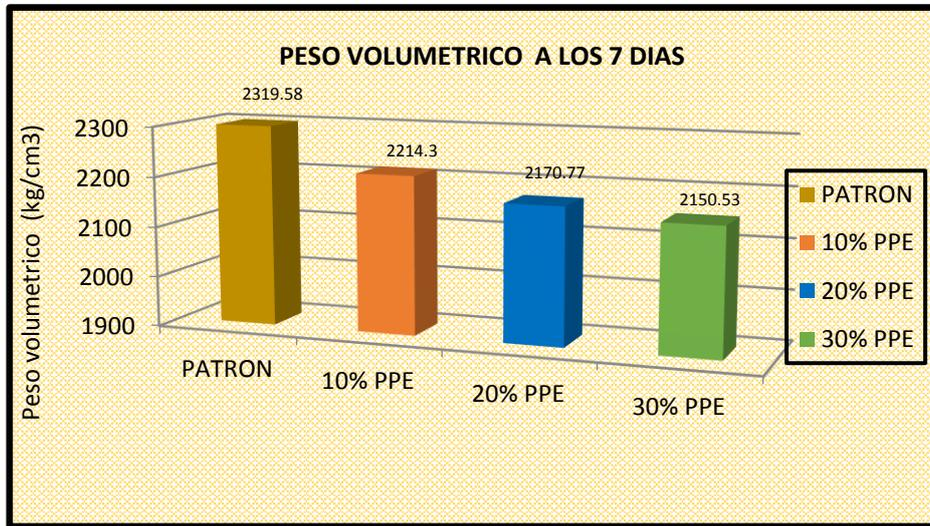
Figura 88: Evolución del peso volumétrico del concreto a los 7 días
