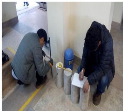
Figura 63: Medición de diámetro
