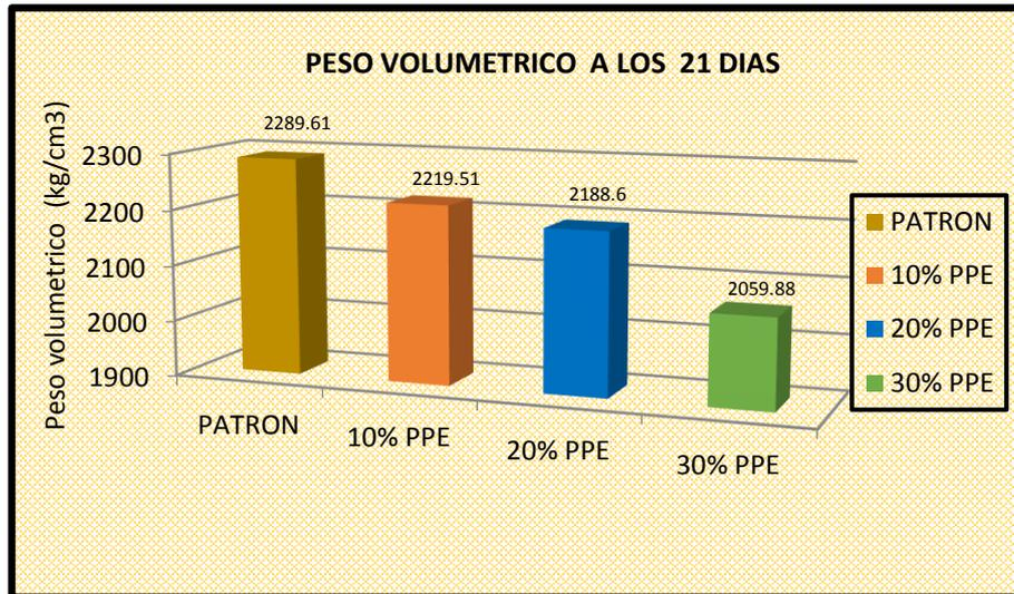
Figura 89: Evolución del peso volumétrico del concreto a los 21 días
