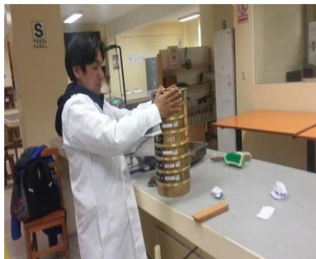
Figura 9: Serie de tamices para agregado grueso
