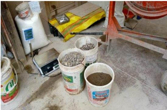
Figura 51: Pesado de agregados
