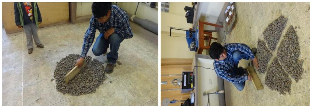
Figura 35: Cuarteo de agregado grueso
