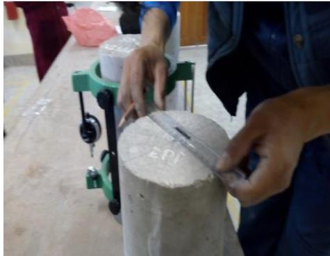
Figura 78: Distancias extremas del testigo
