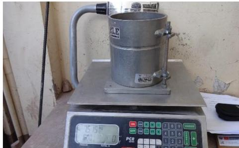
Figura 16: Peso del molde sin agregado
