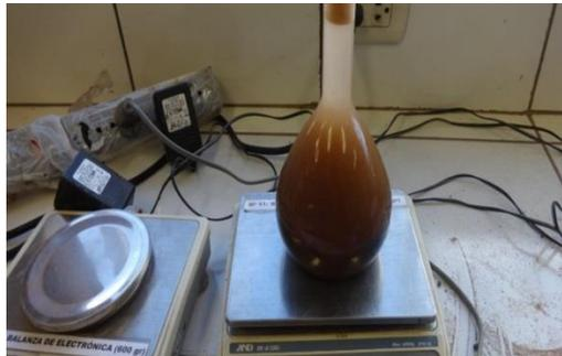
Figura 30: Peso de la probeta con agregado + agua
