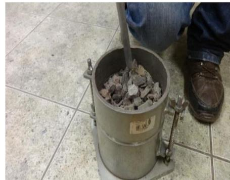
Figura 44: Varillado de material
