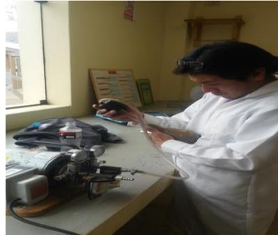
Figura 31: Extrayendo el aire con bomba de vacíos
