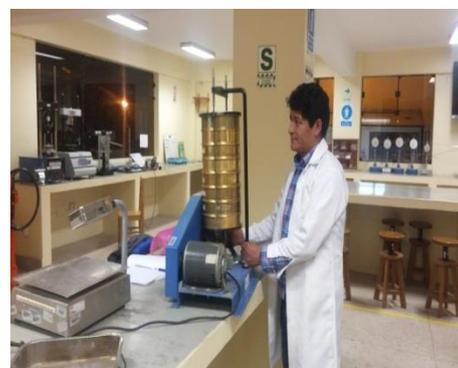
Figura 10: Tamizando el material
