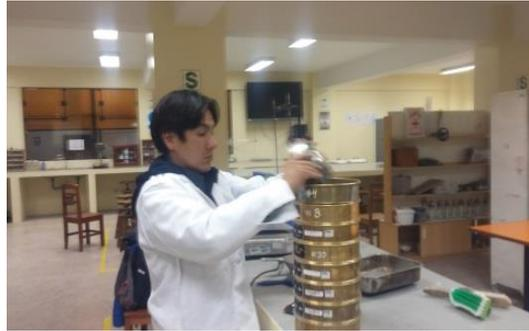
Figura 8: Serie de tamices agregado fino
