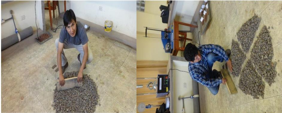
Figura 39: Cuarteo de agregado grueso para peso unitario
