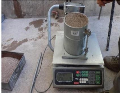
Figura 24: Pesado de agregado varillado
