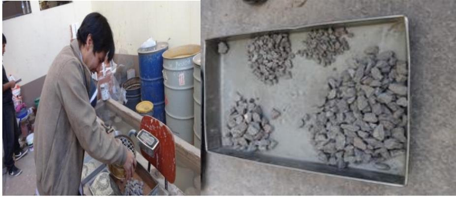
Figura 38: Pesado de agregado retenido en cada tamiz
