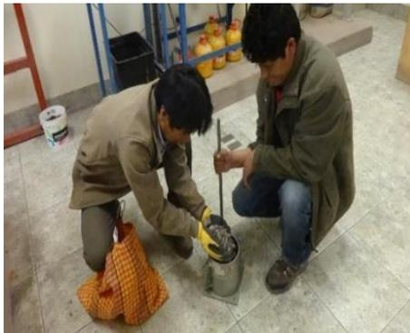
Figura 43: Colocado de material a los 1/3 del molde
