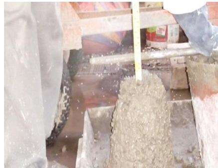
Figura 57: Medida asentamiento del concreto
