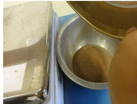
Figura 12: Pesado de agregado
