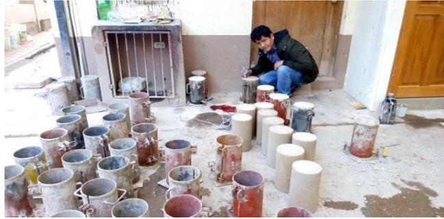
Figura 61: Desencofrado y etiquetado de briquetas
