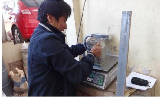
Figura 42: Pesado de molde más agregado sin varillado
