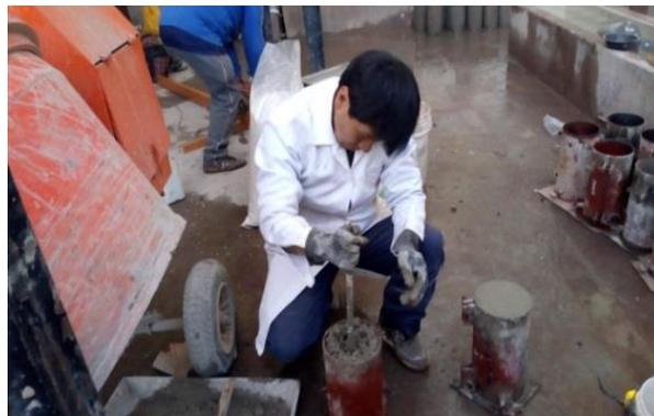
Figura 59: Preparación de testigos
