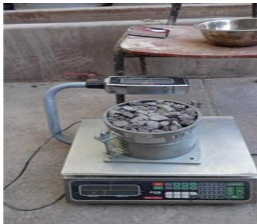
Figura 45: Pesado de molde más material varillado
