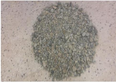
Figura 14: Muestra para peso unitario agregado fino
