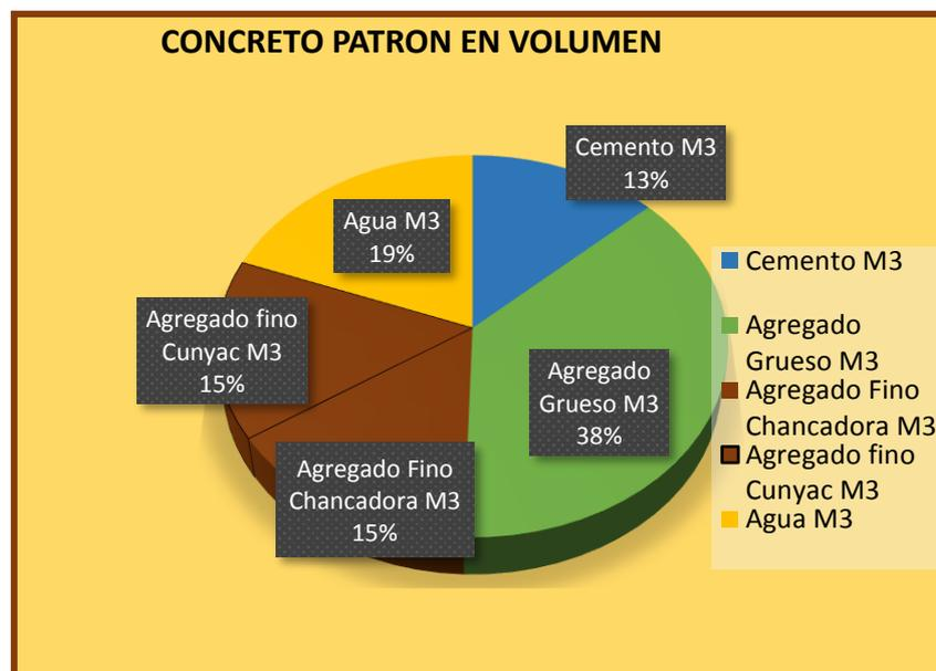
Figura 86: Dosificación en volumen del concreto  $f'c=210 \text{ kg/cm}^2$
