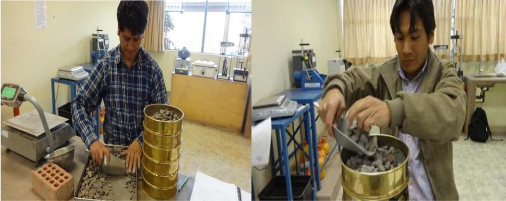
Figura 36: Colocado de agregado grueso a tamices
