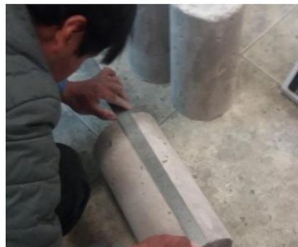
Figura 64: Medición de altura
