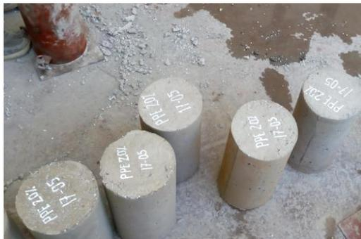
Figura 67: Secado de testigos
