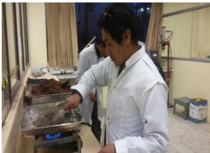
Figura 26: Secado de agregado
