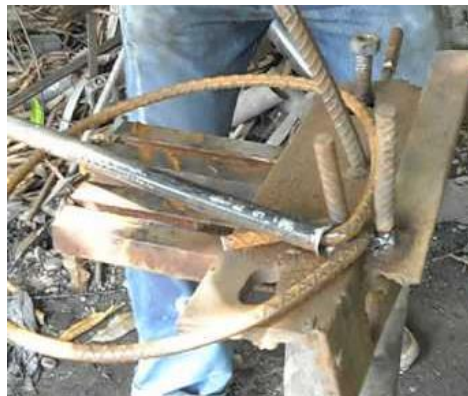
Figura 7 Dobladora de varillas metálicas
