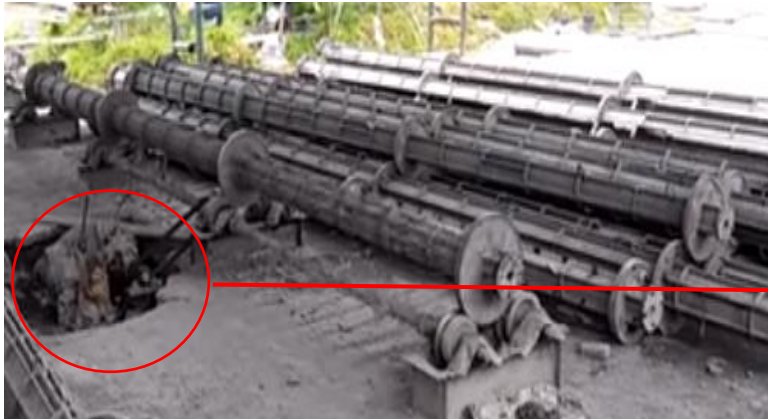
Figura 11 Proceso de centrifugado de los postes
