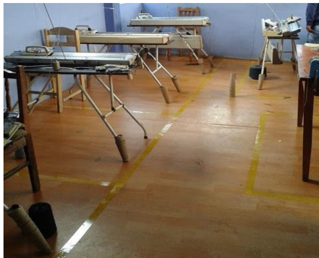
Figura 61: Señalización de áreas de trabajo
