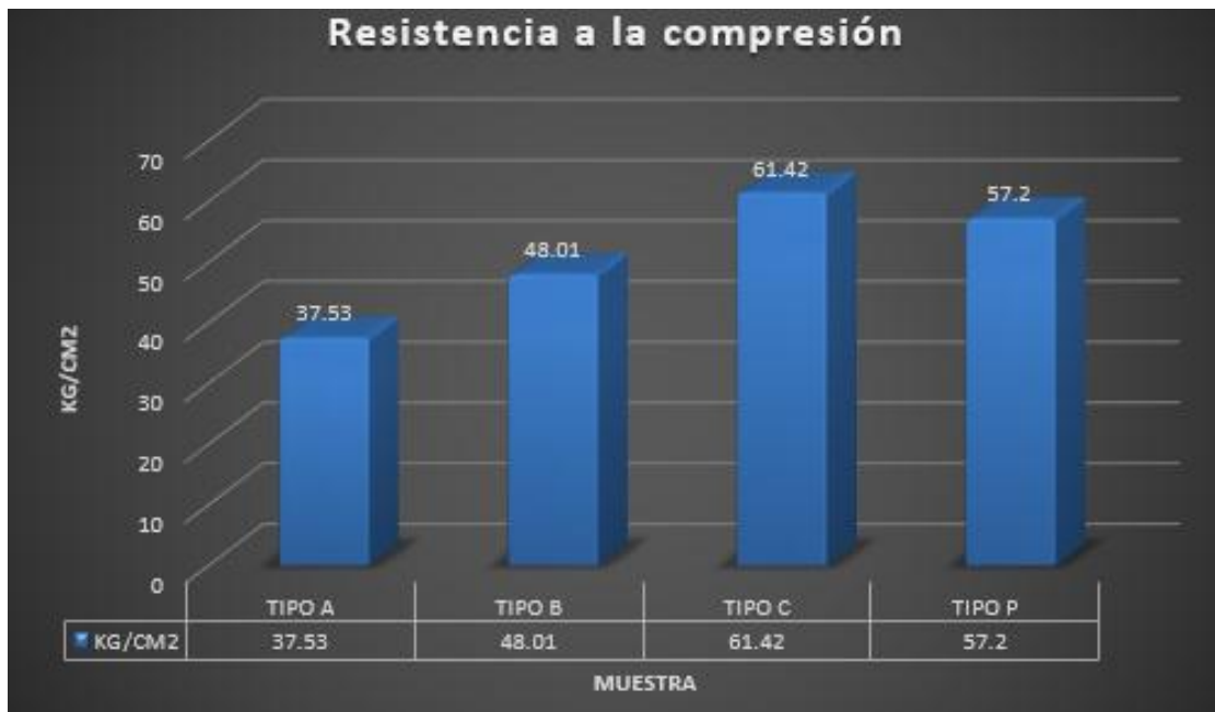
Figura 57. Comparación de los promedios de la resistencia a la compresión de los diferentes tipos de ladrillos. Fuente: Elaboración propia
