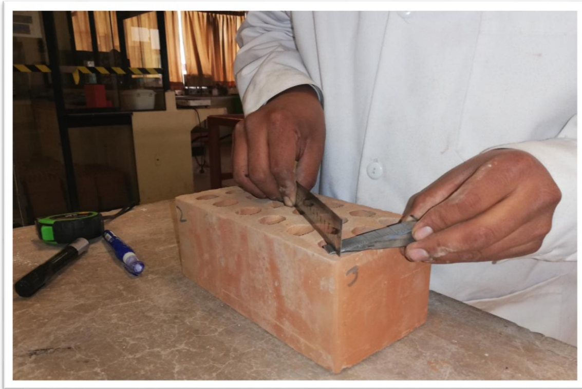
Figura 18. Toma de medidas ensayo de alabeo. Fuente: Elaboración propia
