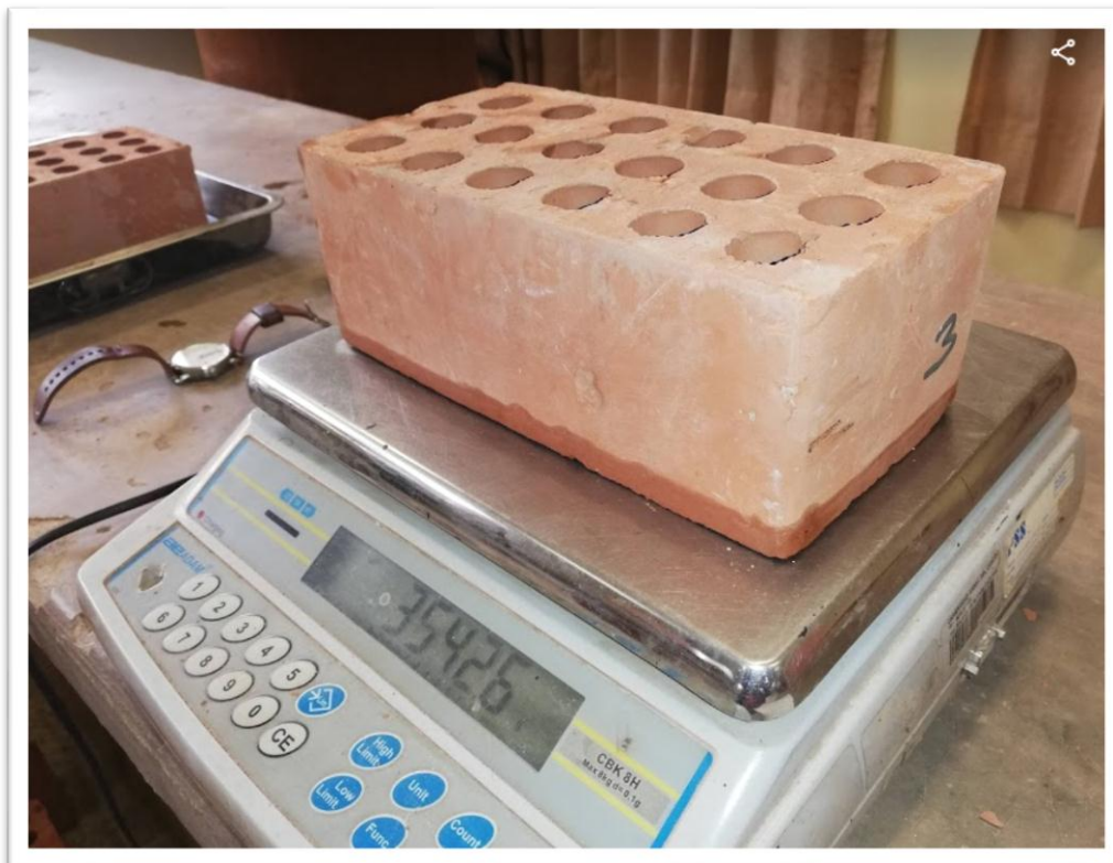
Figura 20. Peso de unidad de albañilería luego de ser sometido a inmersión. Fuente: Elaboración propia
