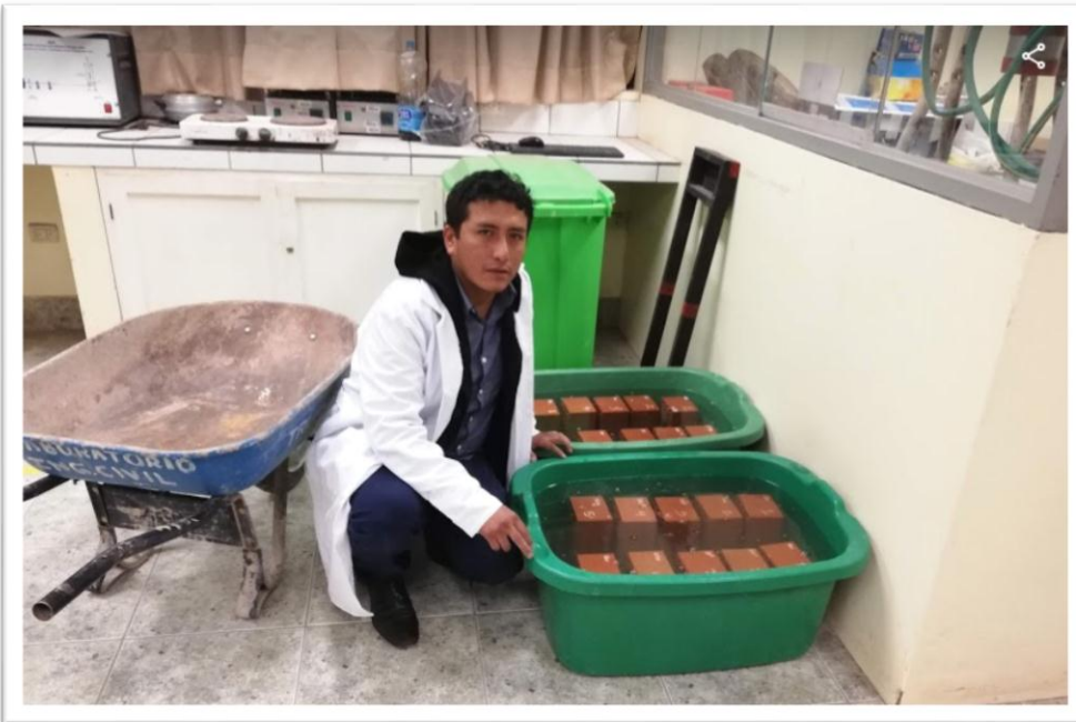
Figura 21. Unidades de albañilería sumergidas por 24 horas para realizar ensayo de absorción. Fuente: Elaboración propia
