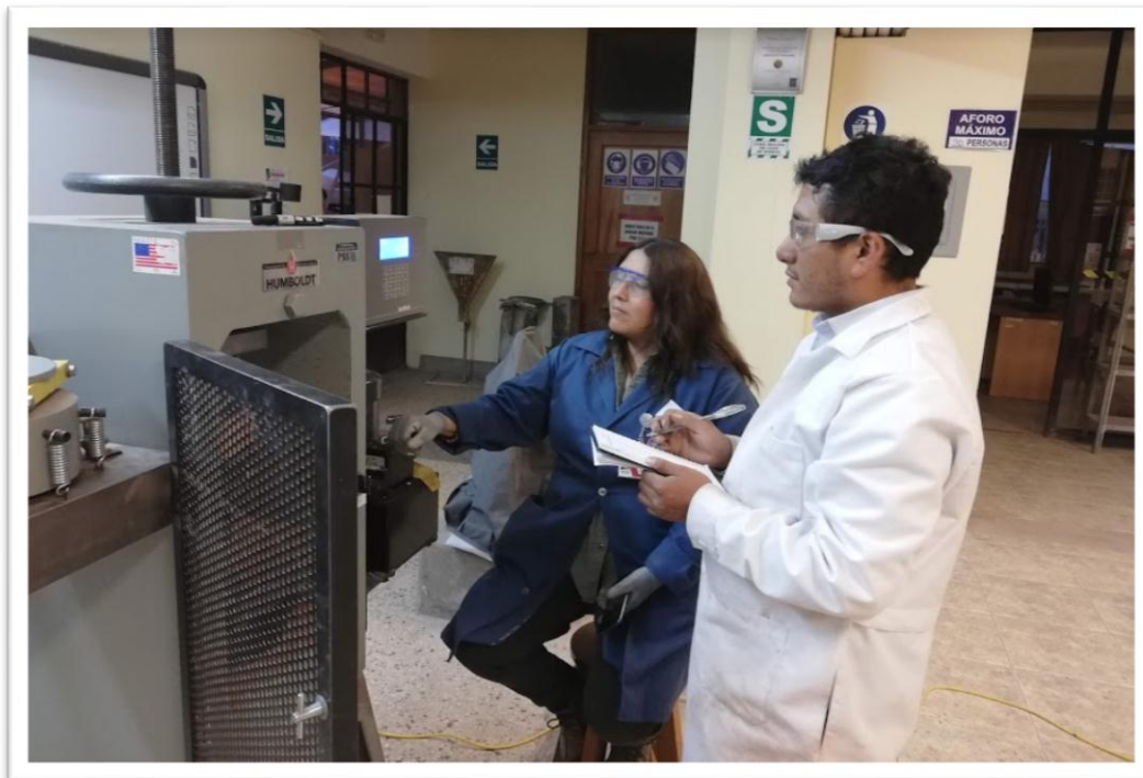
Figura 23. Rotura de unidades de albañilería. Fuente: Elaboración propia
