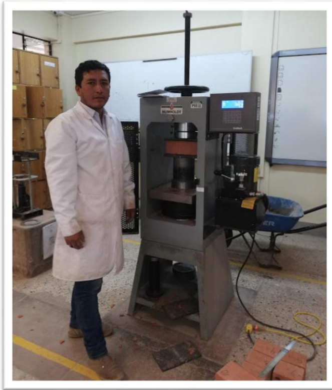
Figura 22. Ensayo de compresión. Fuente: Elaboración propia
