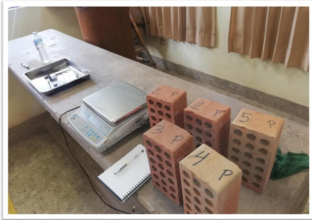
Figura 19. Instrumentos y unidades de albañilería para realizar el ensayo de succión. Fuente: Elaboración propia
