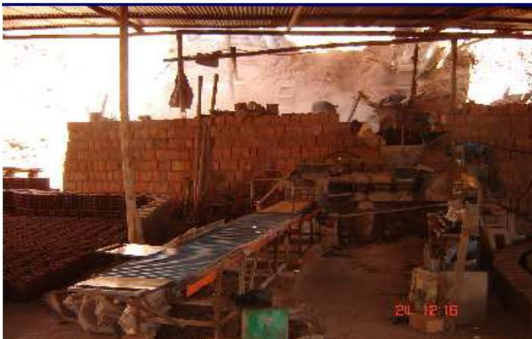
Combinación mezcladora y extrusora de accionamiento eléctrico (Cuzco)
