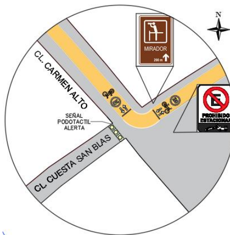
Figura 284. Pavimento táctil de alerta en la calle con Carmen Alto
