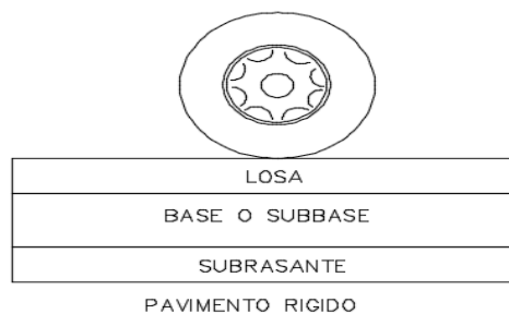
Figura 43. Esquema del paquete estructural para pavimento rígido
