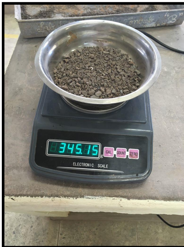
Figura 32 Peso de una muestra del Agregado fino sin humedad
