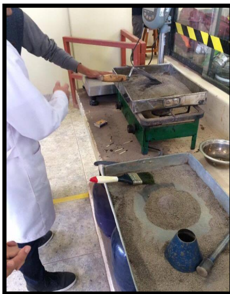
Figura 34 Muestra de Agregado fino sometido a la estufa
