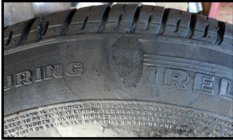
Figura 20 Vulcanizado de neumáticos
