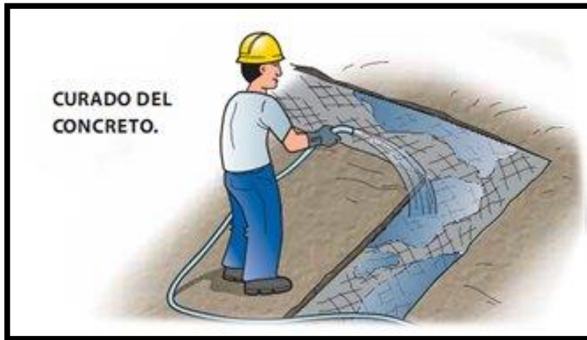
Figura 9 Agua para curado del concreto
