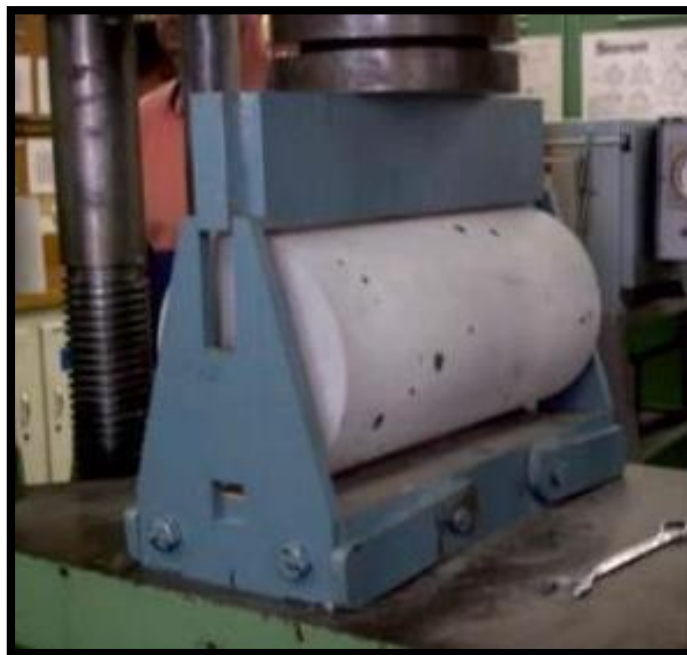
Figura 15 Ensayo de Resistencia a Tracción Indirecta por Compresión Diametral
