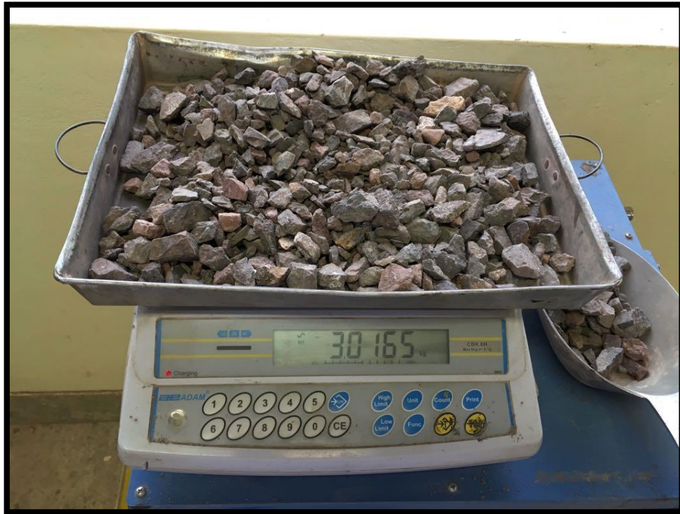
Figura 33 Peso de una muestra del Agregado grueso sin humedad
