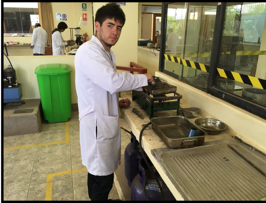
Figura 31 Muestra del Agregado fino sometida a la estufa
