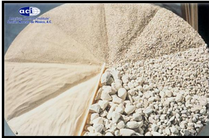
Figura 4 Agregados del Concreto
