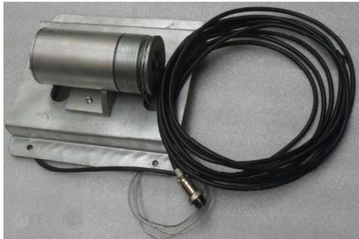
Figura 10: Encoder y cable de conexión
