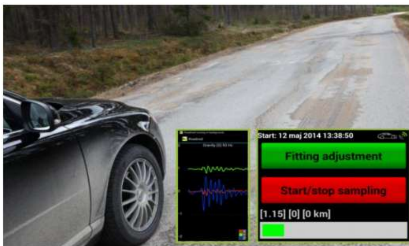
Figura 15: Uso de la aplicación Roadroid en vías
