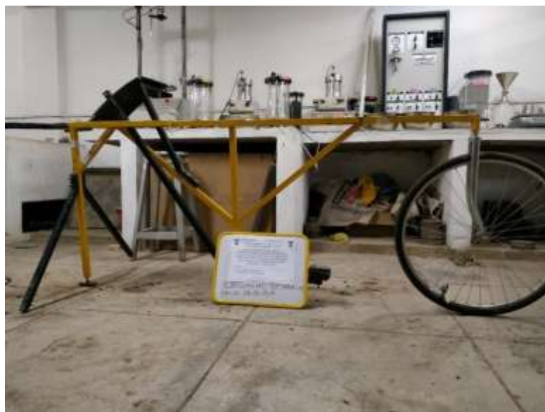
Figura 18: Recolección de datos con el rugosímetro de Merlín
