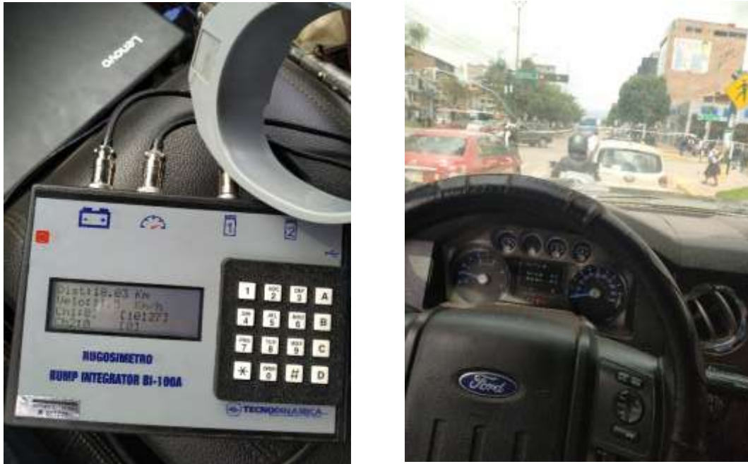
Figura 41: toma de datos mediante el rugosímetro electrónico bump integrator b1-100 a
