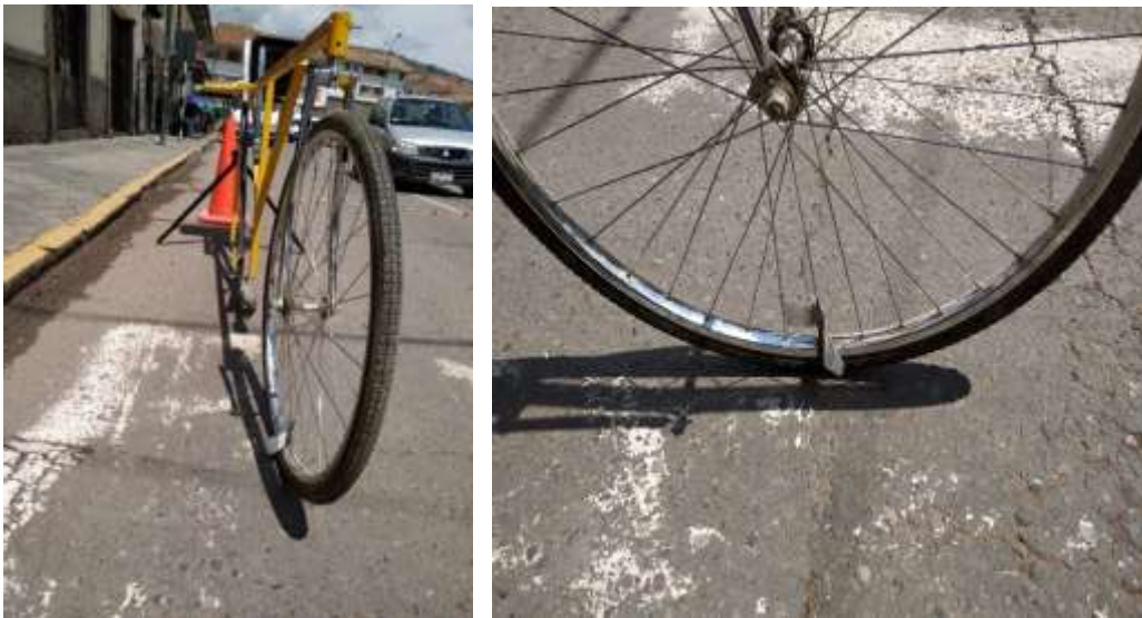
Figura 23: Señal en la rueda del rugosímetro de Merlín
