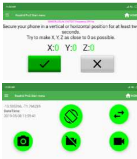
Figura 53: Calibración del teléfono para la aplicación
