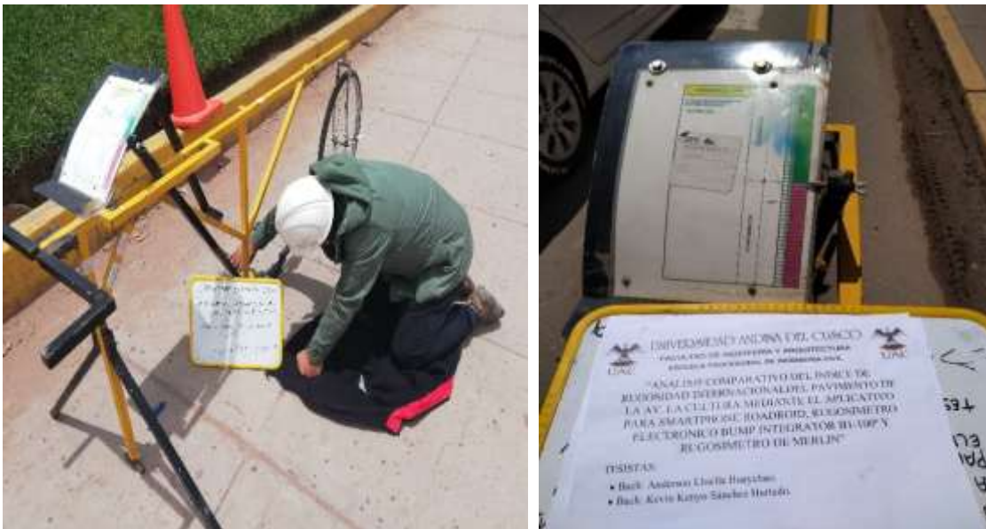
Figura 22: Calibración del rugosímetro de Merlín
