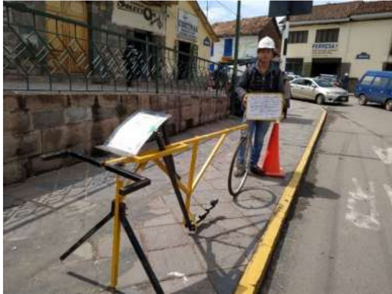
Figura 21: Toma de datos con rugosímetro de Merlín
