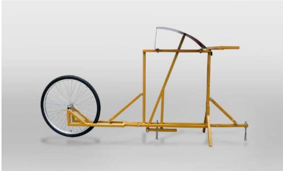
Figura 6: Rugosímetro De Merlín.
