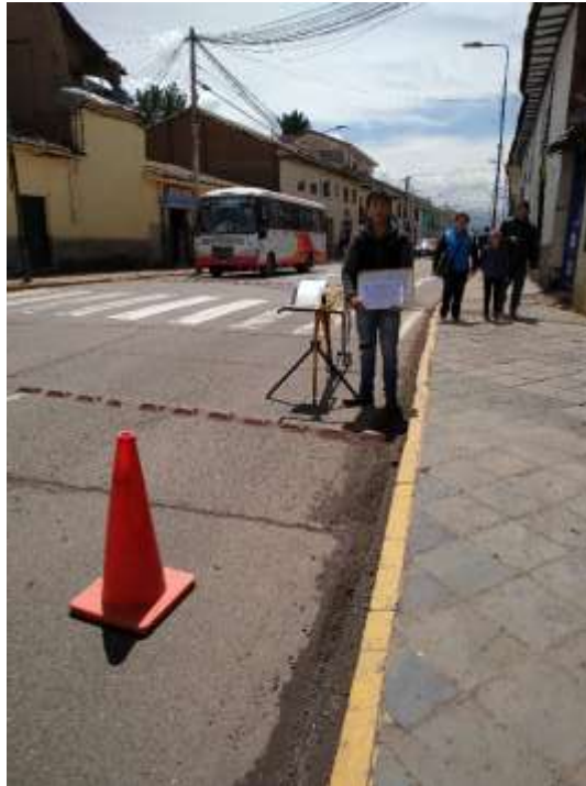
Figura 19: Recolección de datos con el rugosímetro de Merlín
