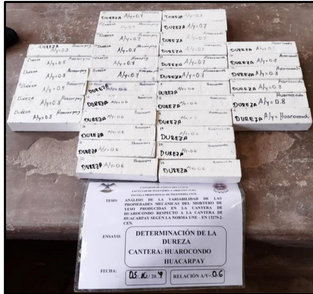
Figura 53: Probetas marcadas para realizar el ensayo de determinación de la dureza.
