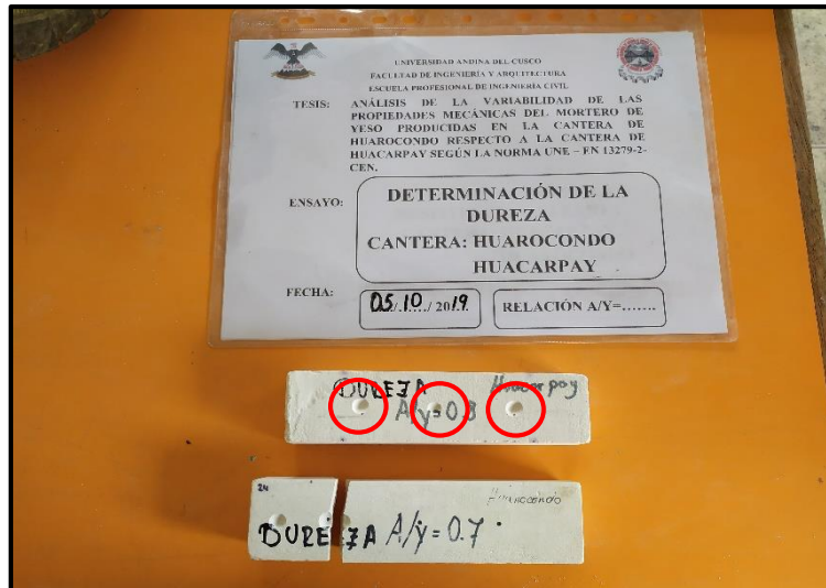
Figura 55: Probeta sometida al ensayo de dureza Brinell
