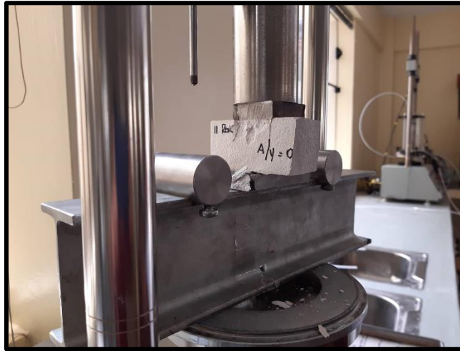
Figura 45: Ruptura de los trozos de las probetas en el ensayo de la resistencia a compresión
