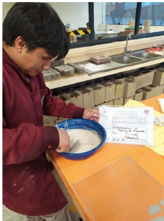
Figura 64: Mezclado del yeso con el agua según las relaciones
