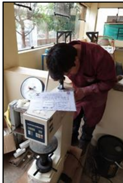
Figura 56:lectura de las huellas producidas con el microscopio de Brinell
