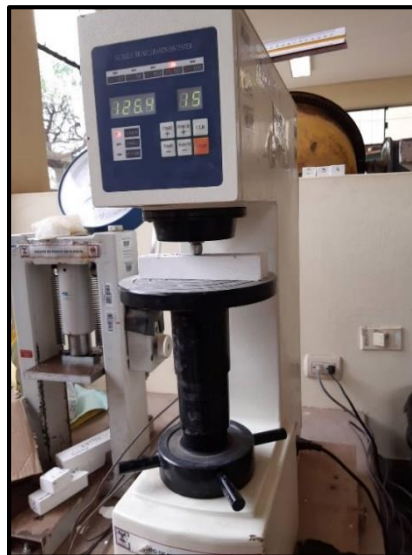
Figura 54: Colocado de las Probetas en la máquina de Brinell.
