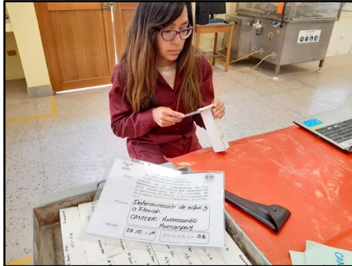
Figura 43: Medición de las secciones de las probetas para ensayo de resistencia a compresión.
