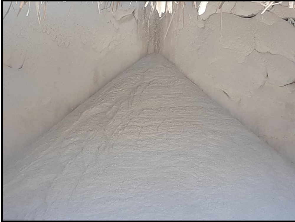
Figura 9: Molienda de la roca de yeso ya cocida en la cantera de Huacarpay
