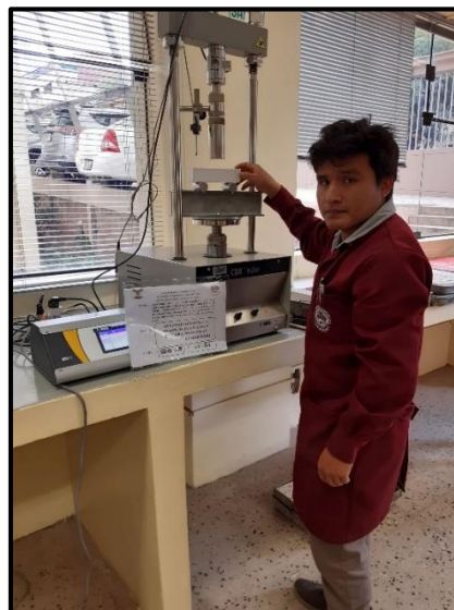
Figura 34: Colocado de probeta en el Equipo de CBR para ensayo de flexión.
