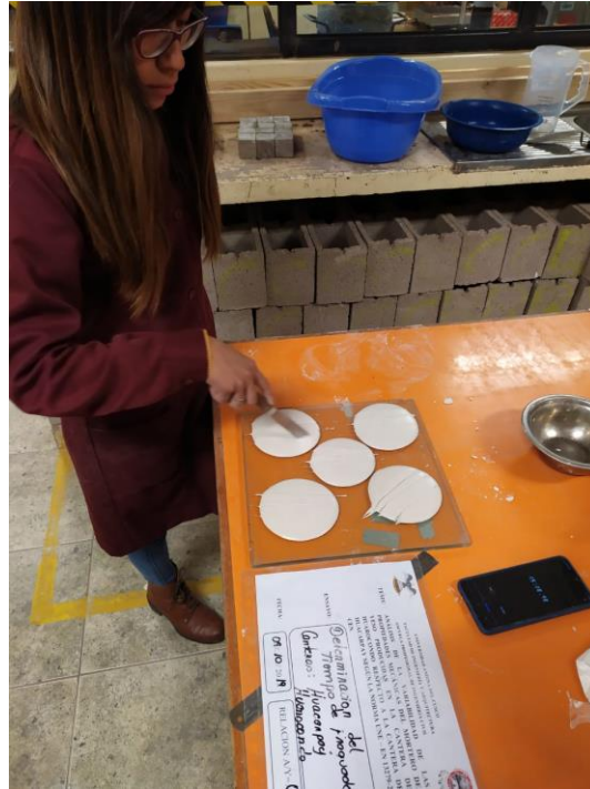
Figura 15: Determinación de principio de fraguado del mortero de yeso
