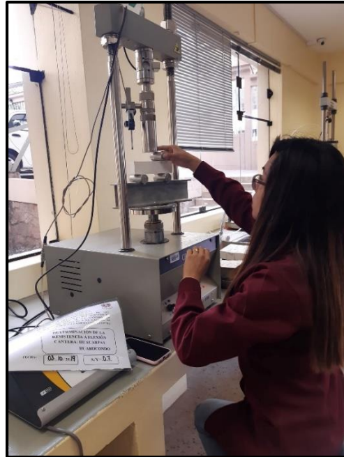
Figura 35: Probetas sometidas a ensayo de flexión hasta su falla
