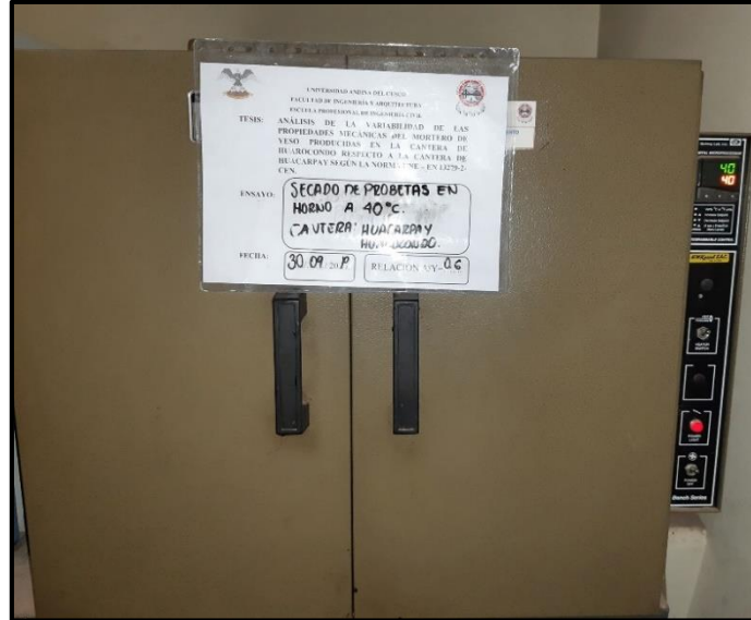
Figura 32: Horno eléctrico para secado de las muestras prismáticas
