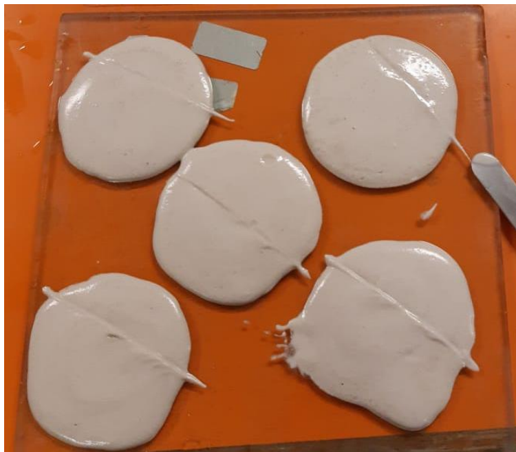
Figura 14: Ensayo de determinación del tiempo de fraguado
