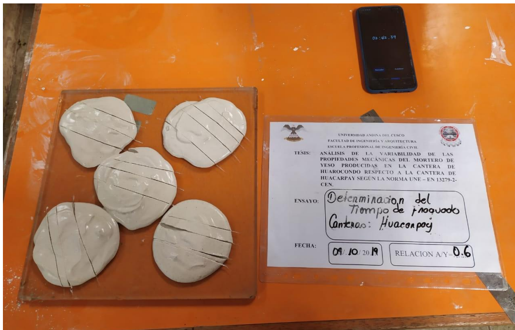
Figura 16: Determinación del final de fraguado del mortero de Yeso
