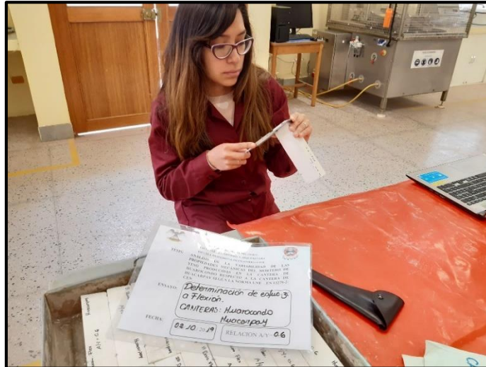
Figura 33: Marcado para referenciar la ubicación de los rodillos para ensayo de flexión.
