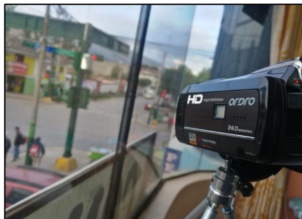
Figura 83. Cámara Filmadora in situ para Aforo Vehicular.
