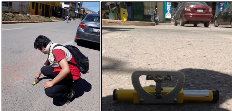
Figura 100. Medida de la Pendiente de los Accesos.
