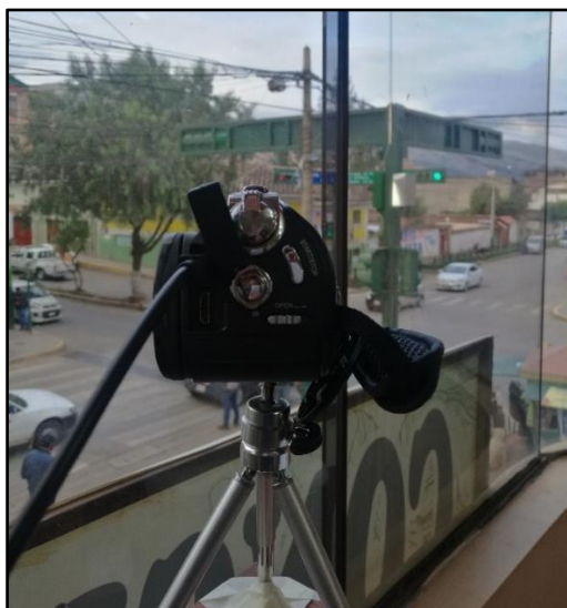
Figura 84. Ubicación de Cámara Filmadora para el Aforo Preliminar.
