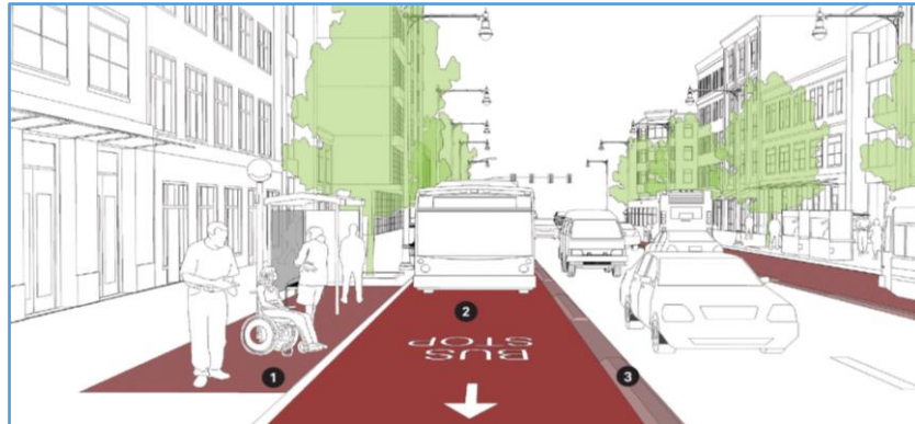
Figura 36. Parada de Bus Dentro de la Vía.
