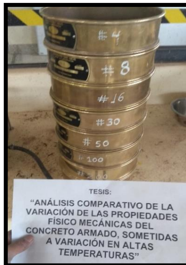
Figura 16 Ensayo de granulometría de agregado fino (juego de tamices colocados de mayor a menor orden)
