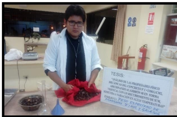
Figura 28 Ensayo de peso específico y absorción (secado superficial de agregado grueso) Fuente: Elaboración propia.
