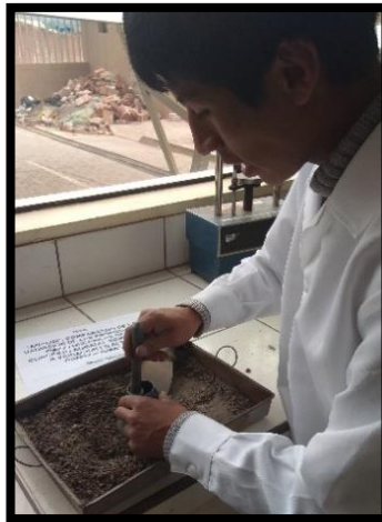
Figura 24 Ensayo de peso específico y absorción (ensayo de cono de absorción) Fuente: Elaboración propia.
