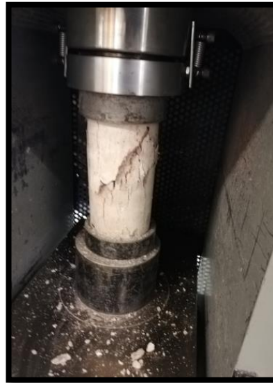
Figura 35 Falla de briqueta de concreto durante el ensayo de resistencia a la compresión Fuente: Elaboración propia
