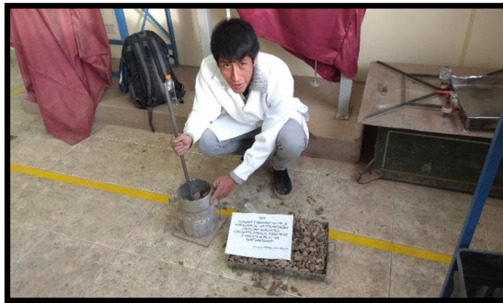
Figura 31 Ensayo de peso unitario compactado (25 golpes con varilla para compactar el agregado)
