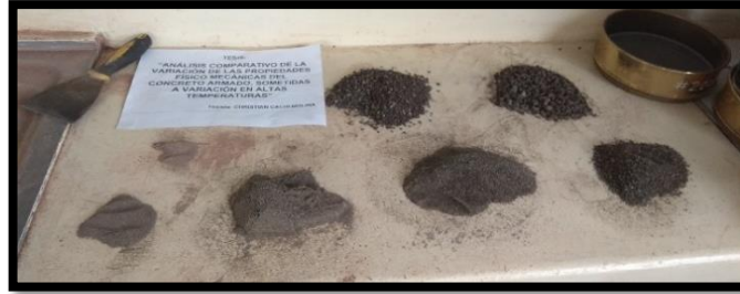
Figura 17 Ensayo de granulometría de agregado fino (material retenido en tamices) Fuente: Elaboración propia.
