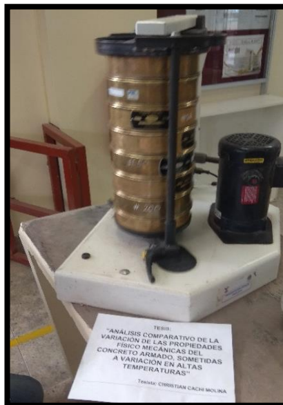
Figura 19 Ensayo de granulometría de agregado grueso (tamizado)
