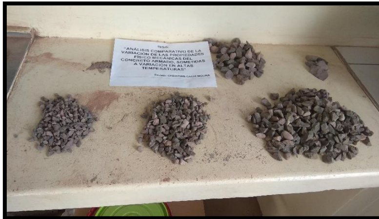
Figura 20 Ensayo de granulometría de agregado grueso (material retenido en los tamices) Fuente: Elaboración propia
