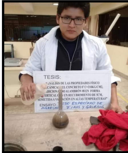
Figura 25 Ensayo de peso específico y absorción (agregado de agua, luego de haber echado 500 g, de agregado fino a la fiola) Fuente: Elaboración propia.
