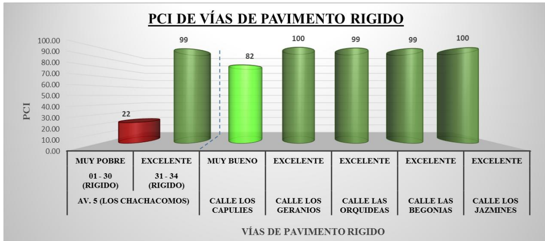
Figura 396: PCI para vías de Pavimento Rígido
