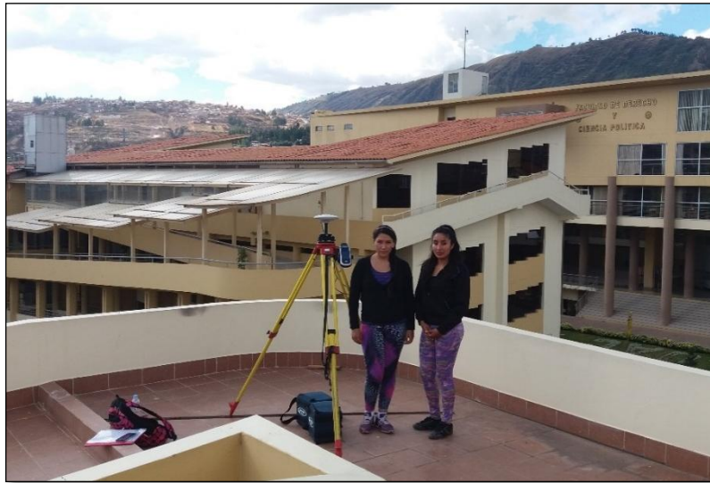
Figura 21: Ubicación de Base del GNSS Trimble R8
