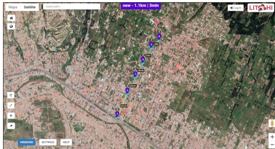
Figura 23: Planificación del vuelo en DJI Litchi de la Av. 01 Los Sauces
