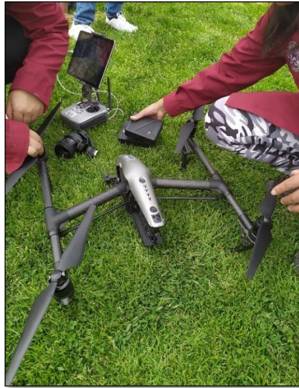
Figura 24: Armado y desarmado del UAV DJI Inspire 2
