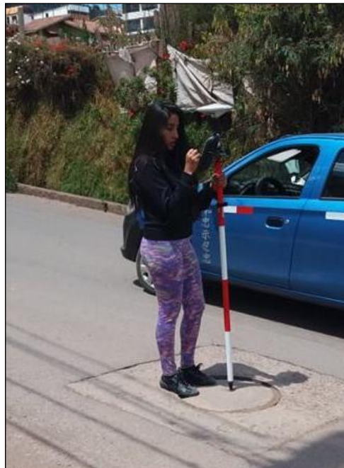
Figura 22: Medición de los puntos de control con el Movil-Rover
