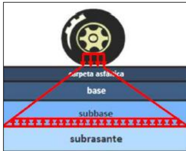
Figura 8: Distribución de la presión de un neumático a través de la estructura del pavimento flexible
