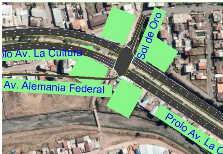
Figura 235: Vista en planta de la intersección semaforizada Prolongación Av. La cultura – Sol de Oro
