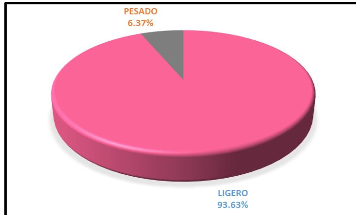
Figura 252: Composición vehicular de la intersección semaforizada Prolongación Av. La Cultura – Av. Mariano Túpac Amáru (ligero-pesado)
