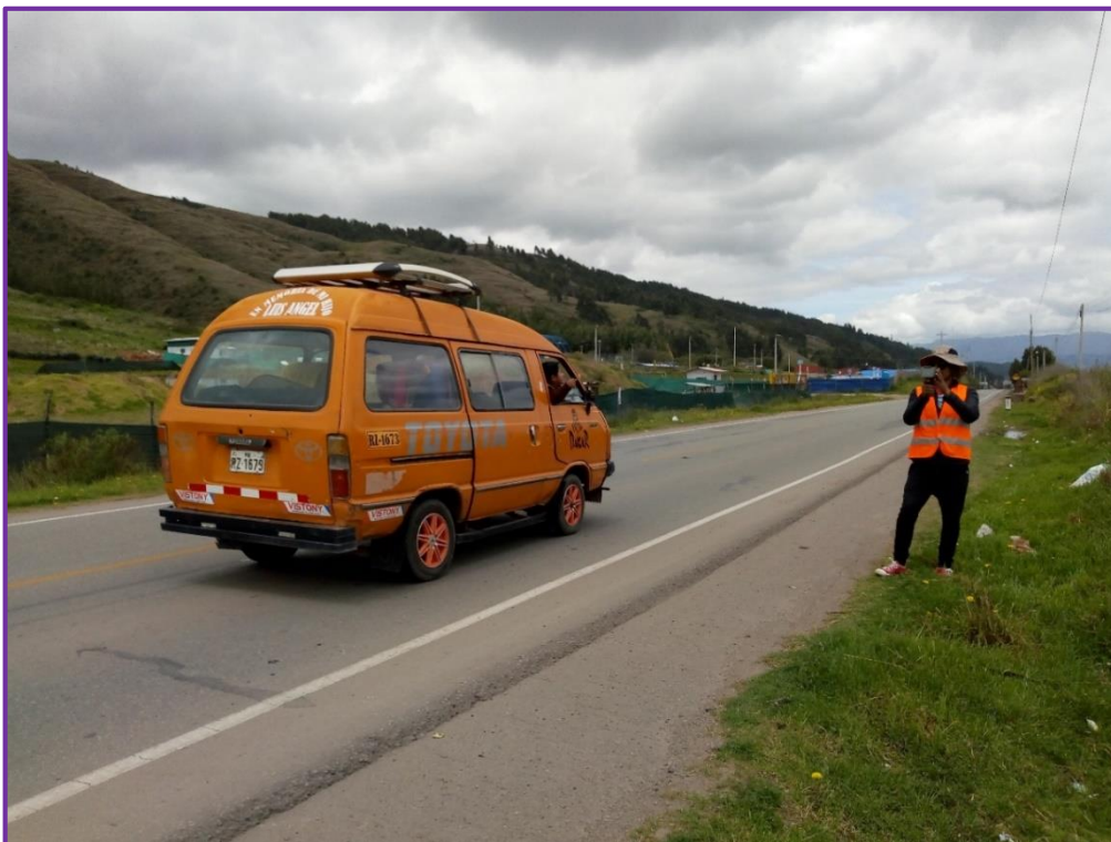
Figura 36: Toma de velocidades en campo con pistola radar de bushnell
