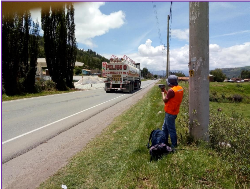
Figura 35: Toma de velocidades en campo con pistola radar de bushnell
