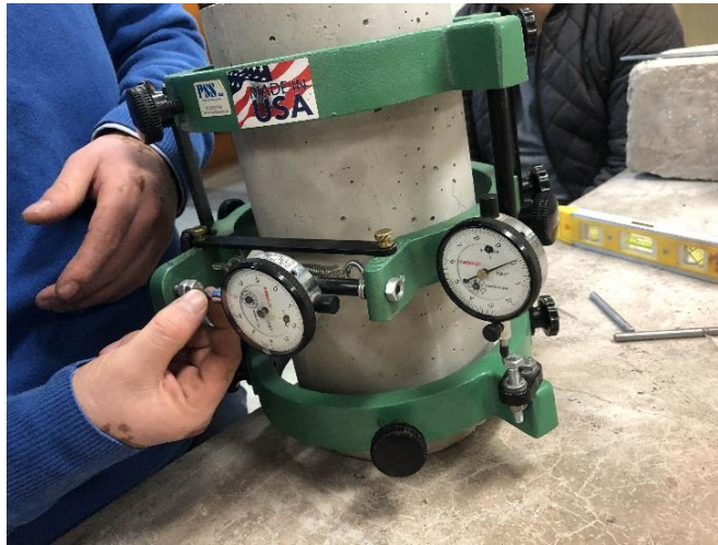
Figura 21 : Colocación y fijación de anillos en la briqueta
