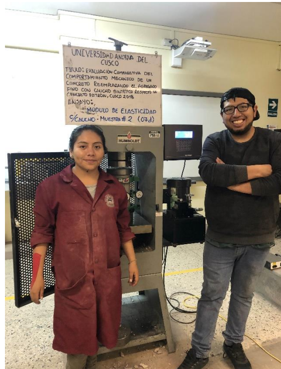
Figura 86 : Ensayo de Modulo de Elasticidad Fuente: Elaboración propia
