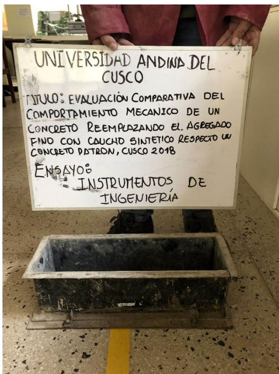
Figura 98 : Molde para viguetas Fuente: Elaboración propia
