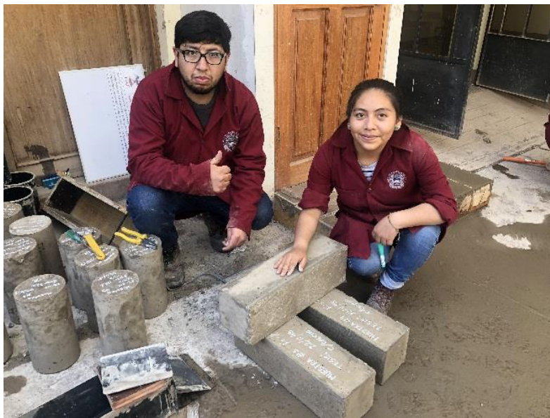
Figura 16 : Desmolde y nomenclatura de las muestras
