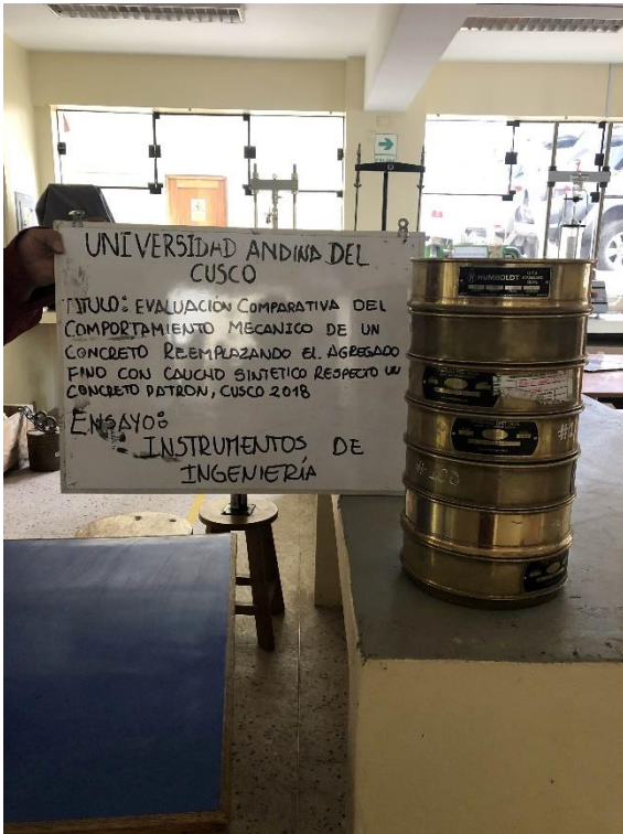
Figura 94 : Juego de tamices Fuente: Elaboración propia
