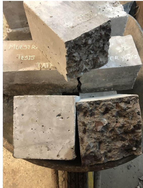
Figura 80 : Falla de la viga patrón Fuente: Elaboración propia
