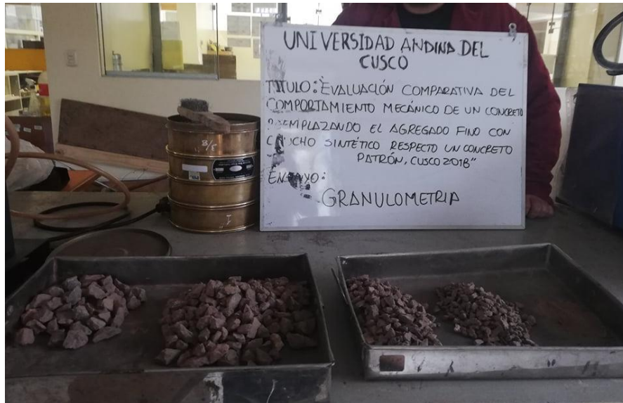
Figura 14 : Agregado grueso tamizado
