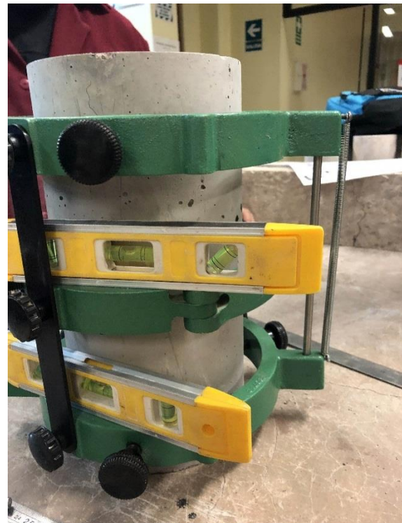
Figura 84 : Colocación y nivelación de anillos Fuente: Elaboración propia
