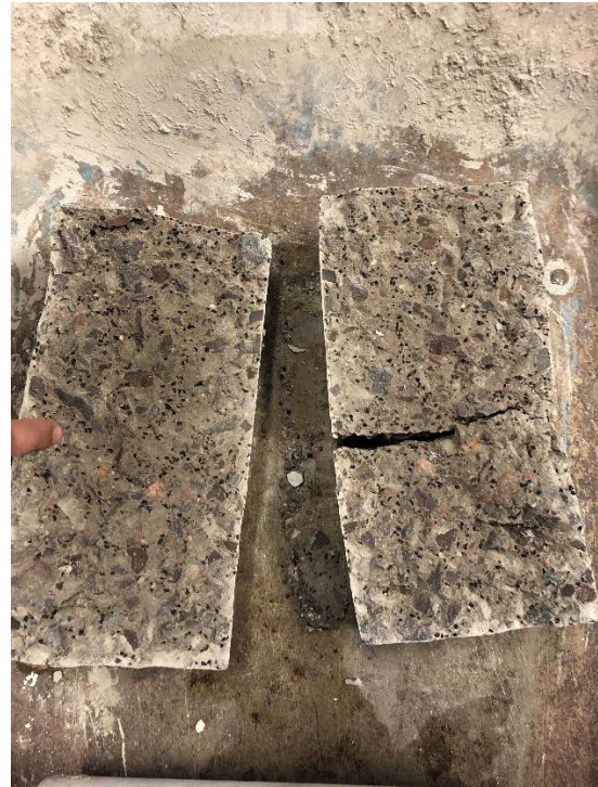
Figura 82 : Falla a Tracción Indirecta Fuente: Elaboración propia
