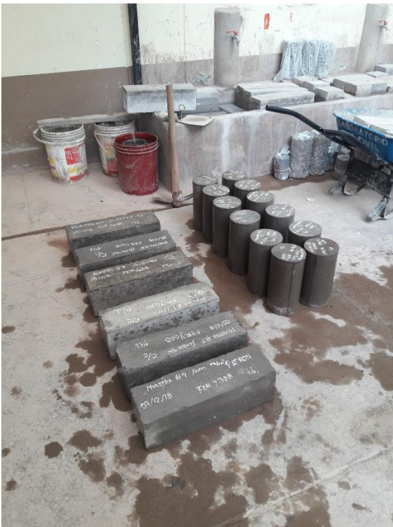
Figura 69 : Muestras para ensayarlas a 14 días Fuente: Elaboración propia
