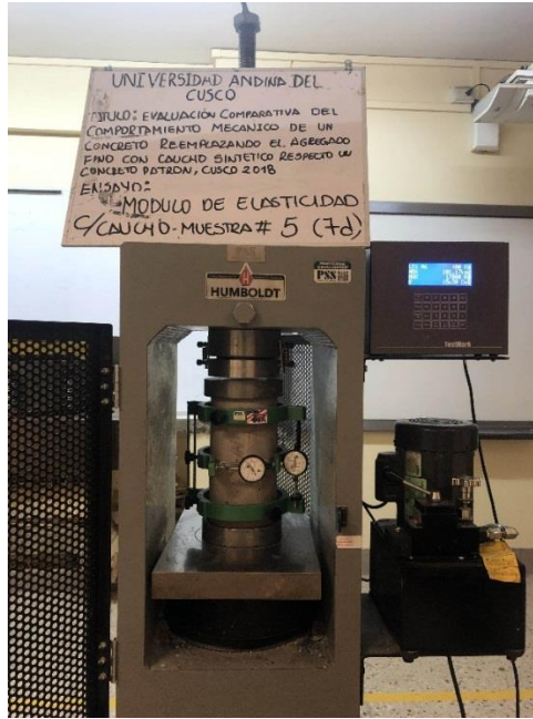
Figura 22 : Espécimen ensayada para Módulo de Elasticidad Fuente: Elaboración propia
