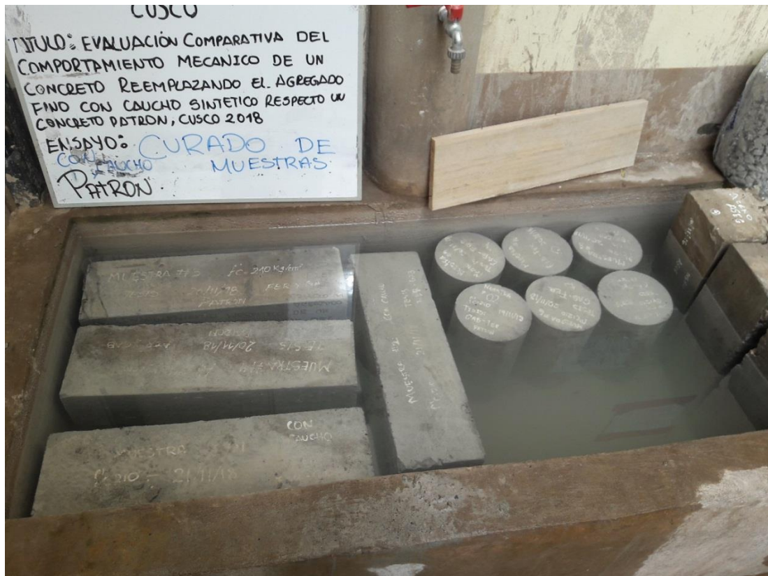
Figura 67 : Curado de Muestras Fuente: Elaboración propia
