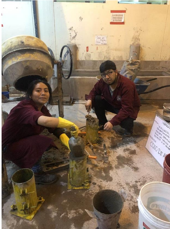
Figura 65 : Colocación de mezcla Fuente: Elaboración propia
