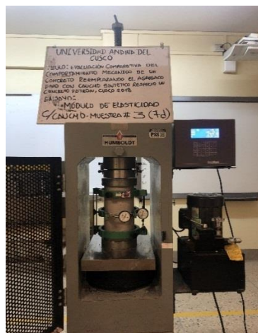
Figura 23 : Espécimen ensayada para Módulo de Poisson Fuente: Elaboración propia
