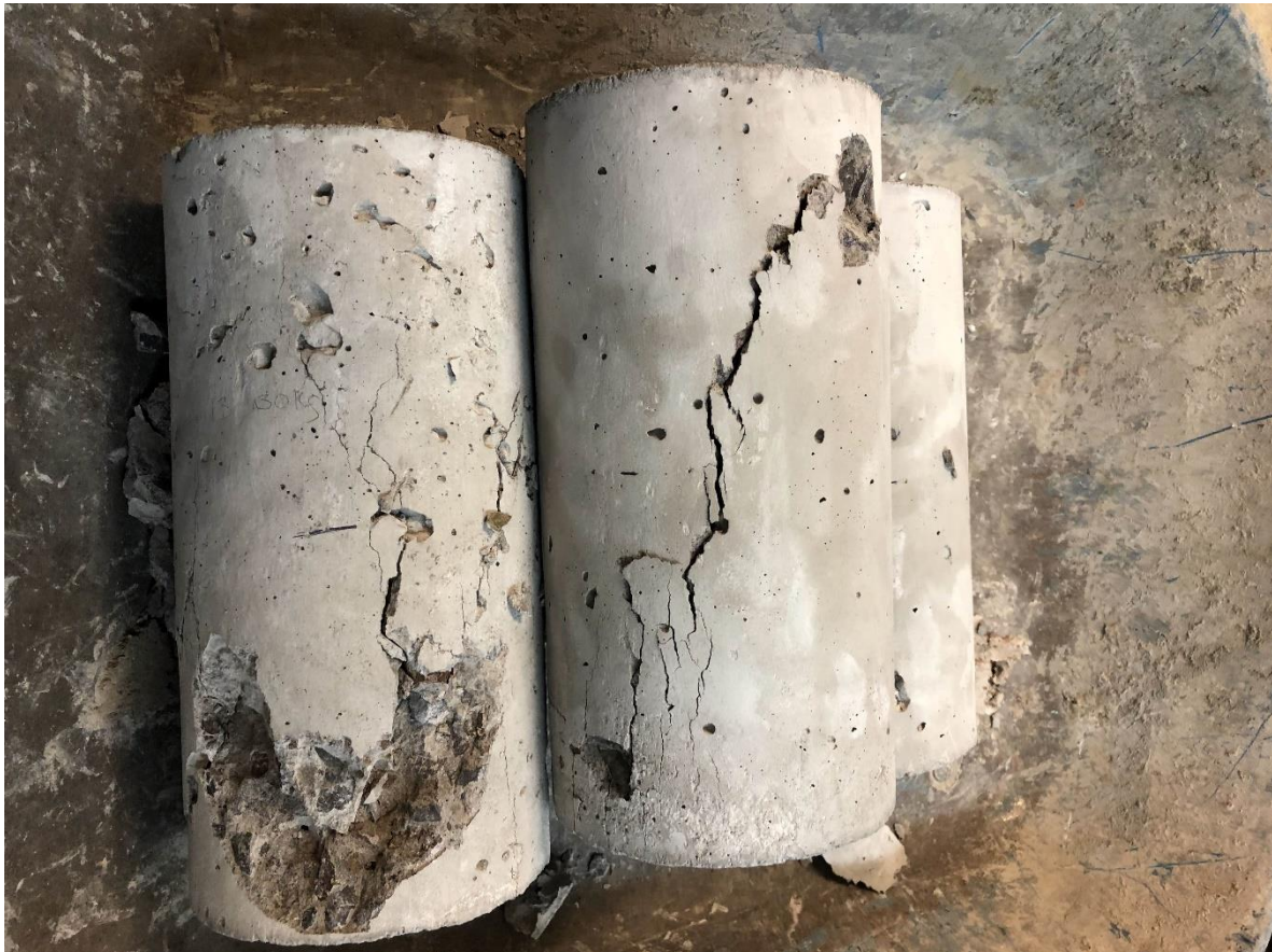
Figura 76 : Visualización de las fallas de muestras ensayadas a Compresión Fuente: Elaboración propia
