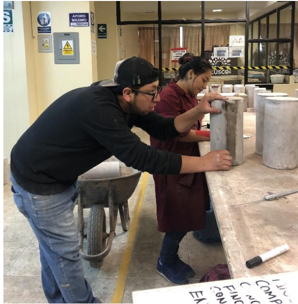
Figura 18 : Medición de especímenes a ensayar Fuente: Elaboración propia
