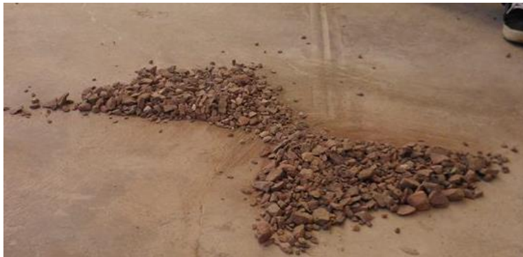
Figura 13 : Muestra representativa de Agregado grueso para Granulometría
