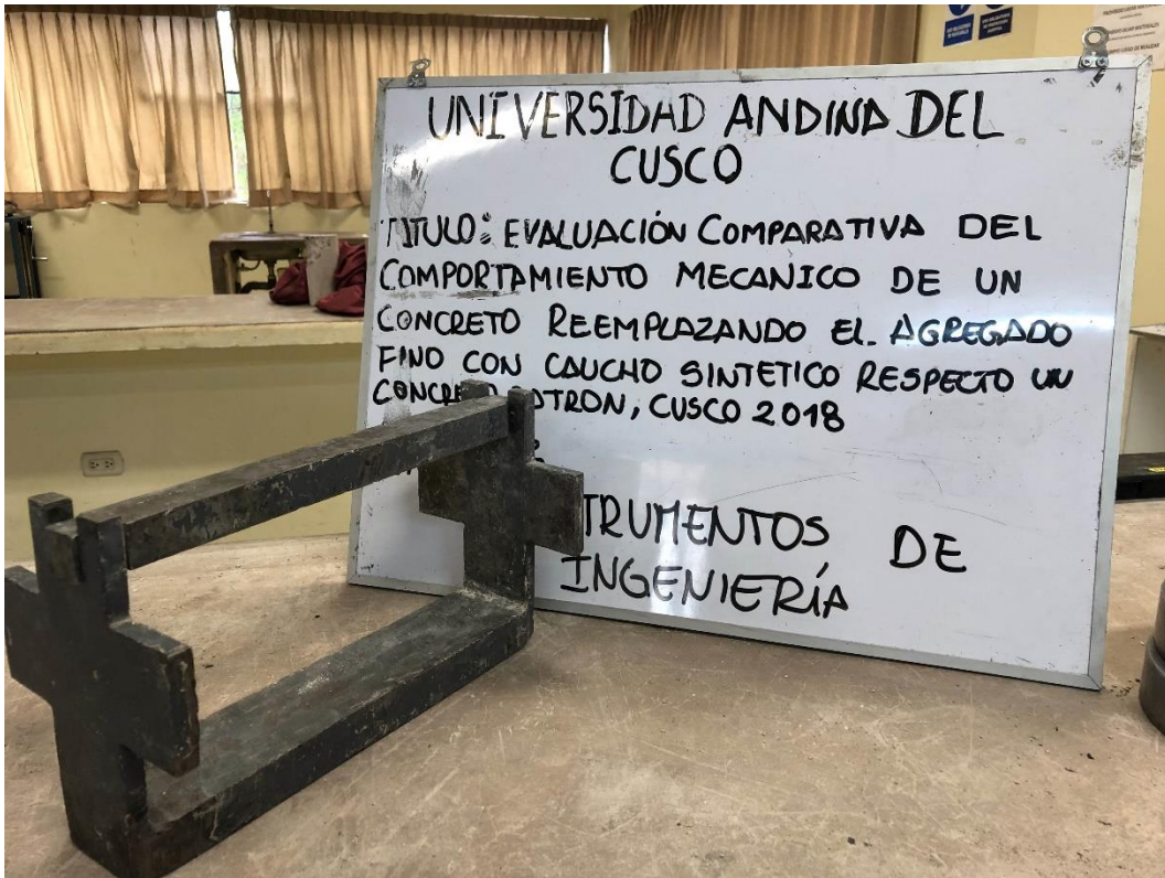
Figura 90 : Adaptador para ensayo de Tracción Indirecta Fuente: Elaboración propia
