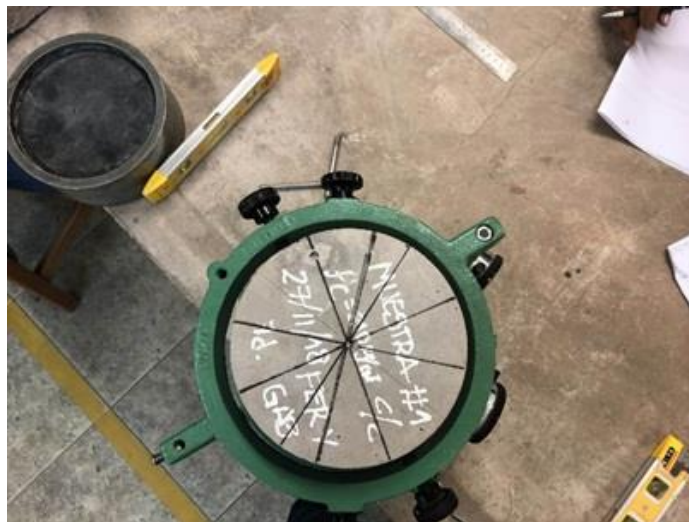
Figura 20 : Trazo de líneas diametrales del espécimen
