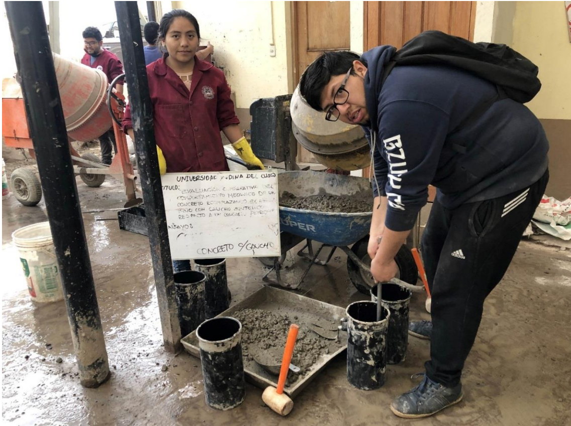
Figura 64 : Colocación de la mezcla en los respectivos moldes Fuente: Elaboración propia
