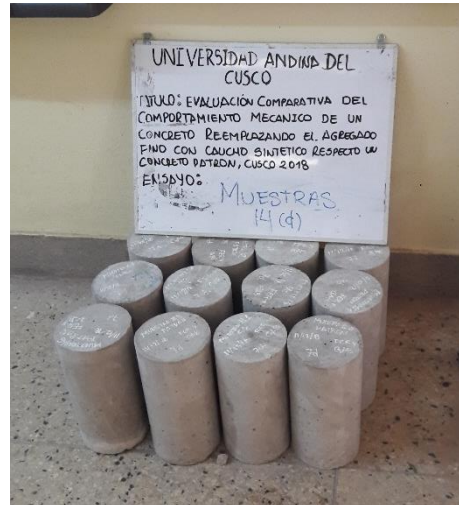
Figura 15 : Muestras retiradas del curado para ensayos a compresión
