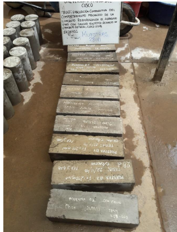
Figura 70 : Muestras para ensayarlas a 28 días Fuente: Elaboración propia
