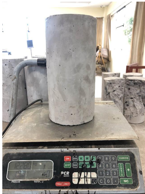
Figura 73 : Peso de la muestra Fuente: Elaboración propia
