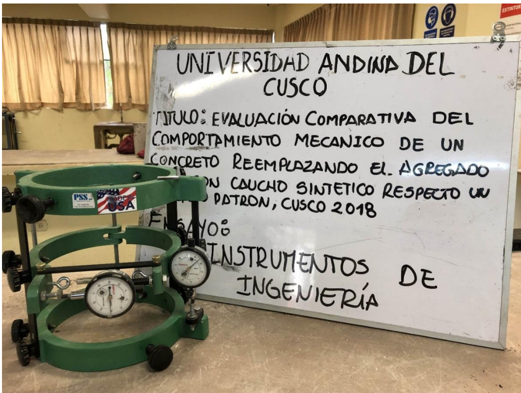
Figura 89 : Juego de anillos con deformímetros Fuente: Elaboración propia
