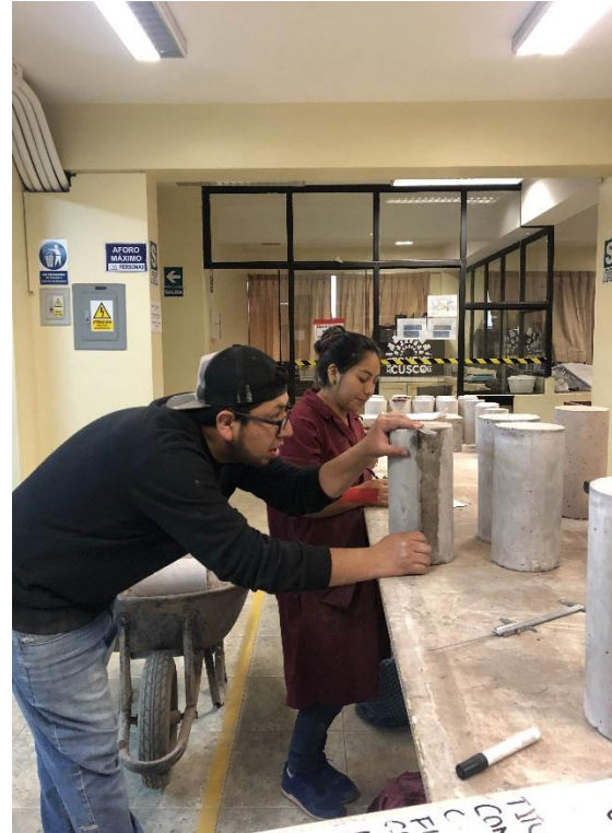
Figura 72 : Medición del espécimen Fuente: Elaboración propia
