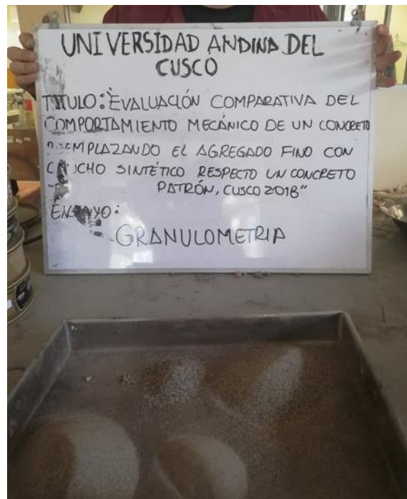
Figura 12 : Agregado fino tamizado Fuente: Elaboración propia.
