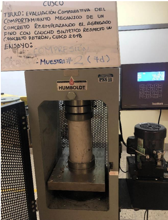
Figura 74 : Muestra ensayada a 7 días Fuente: Elaboración propia
