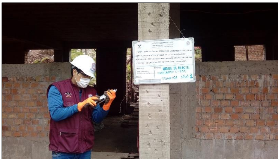
Figura Nro. 100: Ensayo de índice de rebote- lectura del número de rebote
