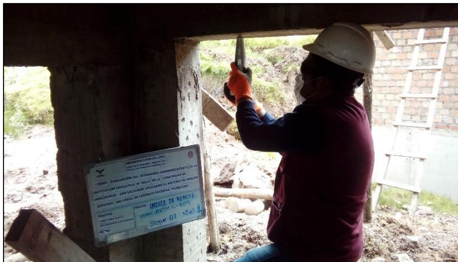
Figura Nro. 99: Ensayo de índice de rebote en viga (posición de golpe C)
