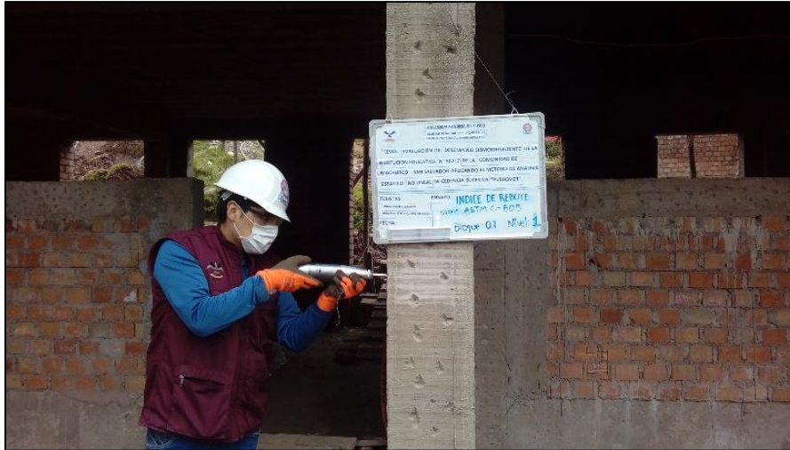
Figura Nro. 98: Ensayo de índice de rebote en columna tipo C-04 (posición de golpe A)
