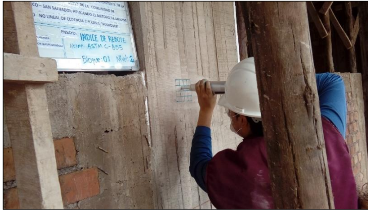
Figura Nro. 101: Ensayo de índice de rebote en columna tipo C-01 (posición de golpe A)
