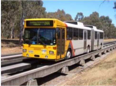
Figura 15:Autobús del O-Bahn guide-way, Adelaida, Australia y Autobús, guide-way, Alemania
