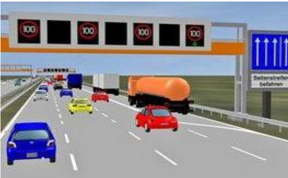
Figura 15: Gestión del tráfico con PTV Vissim evaluación de implementar medidas temporales como límites de velocidad variable y uso del acotamiento como carril adicional. Fuente: Tomado de PTV Vissim
