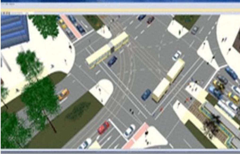
Figura 16 : Simulación multimodal de una intersección compleja con PTV Vissim Fuente. Tomado de PTV Vissim
